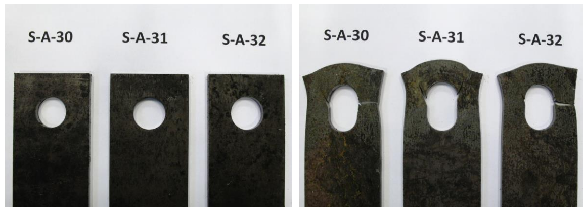
Obr. 3.11: Zkušební tělesa před provedením experimentu. Na obrázku jsou zachyceny čepové desky šířky 76 mm z oceli S355 a průměrem otvoru pro čep 30, 31 a 32 mm (autor)
