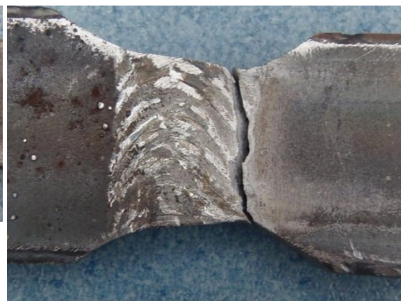
Obr. 4.40: Porušení zkušebních těles po úpravě tvaru zkušebních těles (autor)
