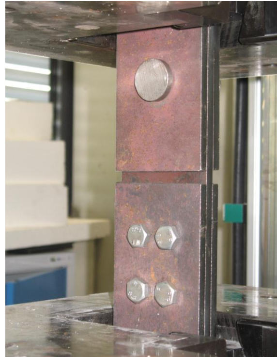
Obr. 3.14: Zkušební těleso připravené k zatěžovací zkoušce před osazením snímání polohy (autor)
