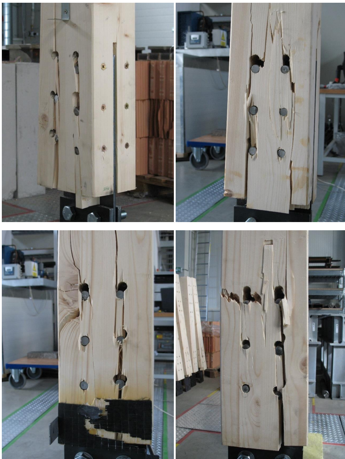
Obr. 2.39: Typická porušení zkušebních těles. Vlevo nahoře: T-A-05, vpravo nahoře: T-VA-07, vlevo dole T-A-06, vpravo dole T-A-04 (autor)
