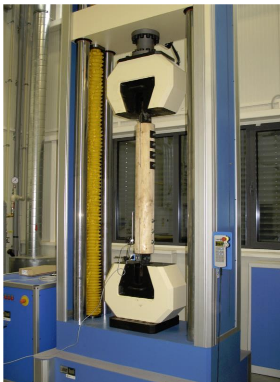
Obr. 2.16: Osazení zkušebního tělesa ve zkušebním stroji LabTest 6.1000 (autor)
