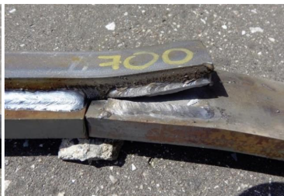
Obr. 4.36: Svarový spoj po provedené zkoušce – lom v místě svarového kovu přeplátovaného spoje ocelí S355 + Weldom700 (autor)
