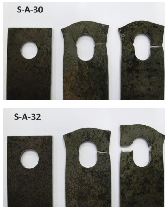
Obr. 3.16: Deformované čepové desky šířky 76 mm po provedené zatěžovací zkoušce. Na horním obrázku desky s otvorem pro čep průměru 30 mm, na spodním obrázku s otvorem 32 mm (autor)
