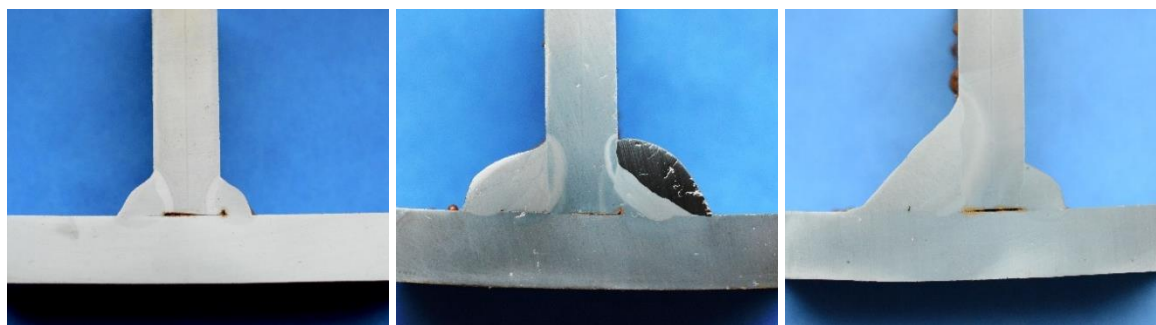
Obr. 4.7: Svarový spoj prvků z oceli S355 (vodorovný prvek) a S690 s nízkým (vlevo), středním (uprostřed) a vysokým (vpravo) tepelným příkonem (autor)
