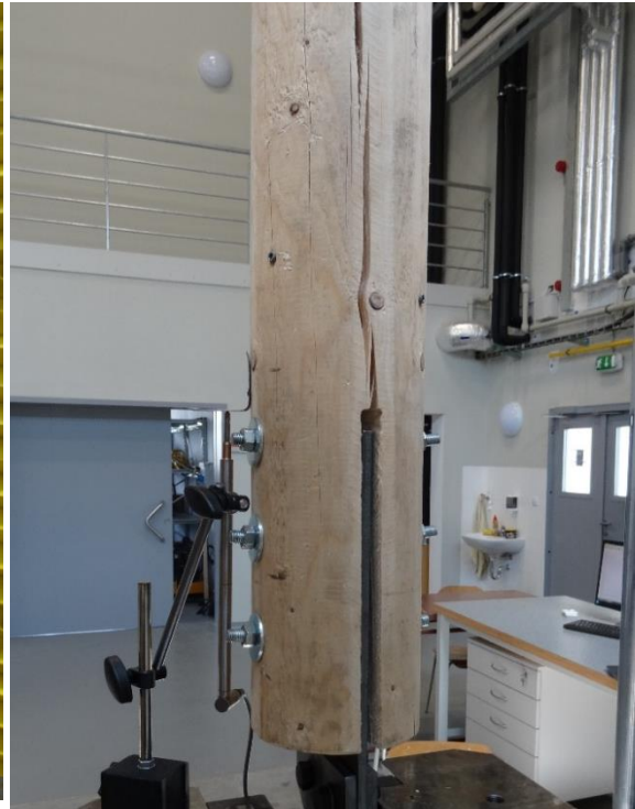
Obr. 2.20: Zkušební těleso K5 před provedením zkoušky. Je patrná výrazná výsušná trhlina šířky 7 mm (autor)
