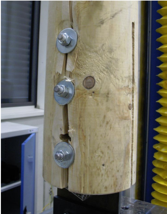
Obr. 2.19: Porušený spoj po provedené zatěžovací zkoušce. Na obrázku je těleso K4 (autor)
