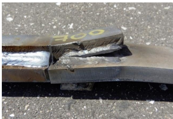
Obr. 4.35: Svarový spoj po provedené zkoušce – lom v místě svarového kovu přeplátovaného spoje ocelí S235 + Weldom700 (autor)
