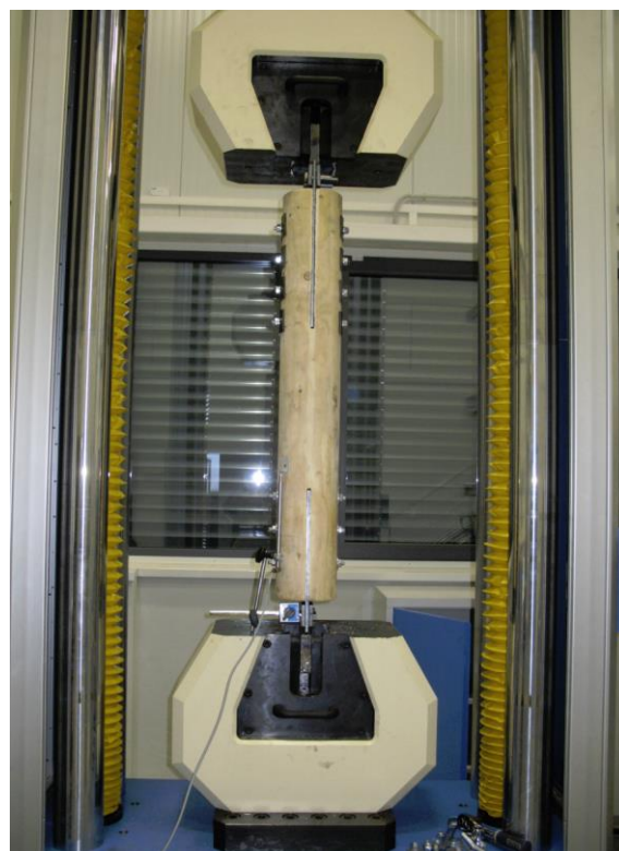
Obr. 2.17: Osazení zkušebního tělesa ve zkušebním stroji LabTest 6.1000 (autor)
