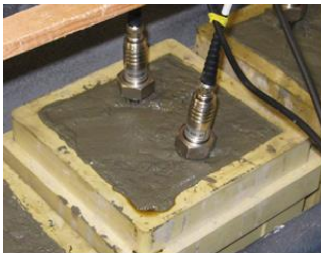
Obr. 3.1.13: Umístění vlnovodů a snímačů AE v čerstvé betonové směsi
