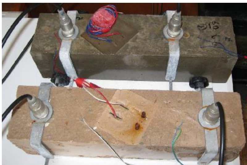
Obr. 3.3.25: Uchycení a rozmístění snímačů AE
