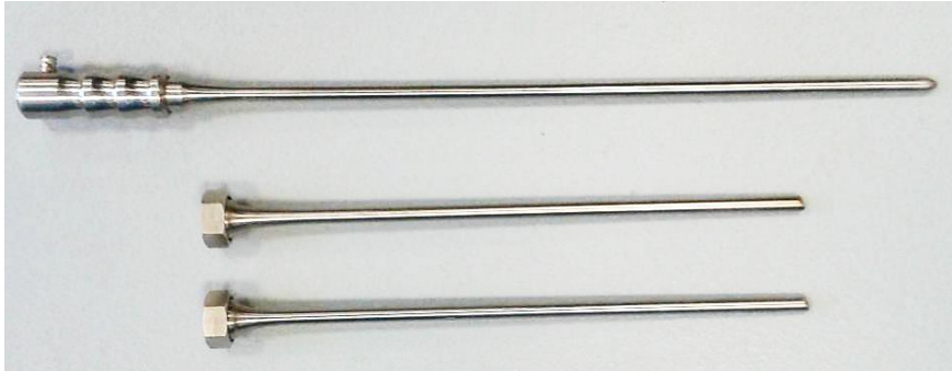
Obr. 2.3.13: Ukázka akustických vlnovodů
