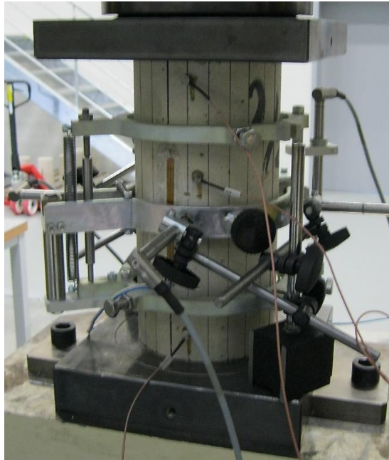
Obr. 3.3.16: Umístění vzorku v lisu a rozmístění snímačů AE
