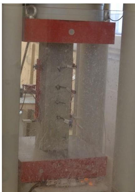
Obr. 3.3.11: Umístění vzorku v lisu a rozmístění AE snímačů
