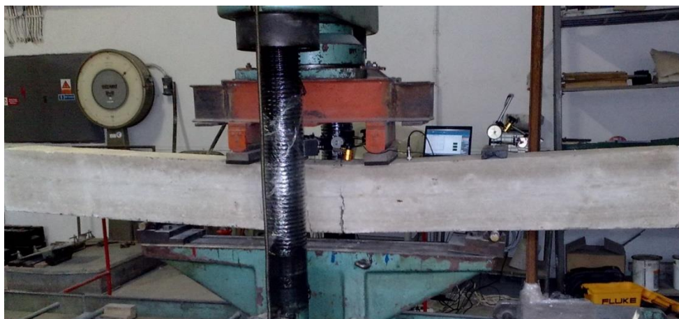
Obr. 3.3.19: Trám AA+D+V po čtyřbodovém ohybovém testu
