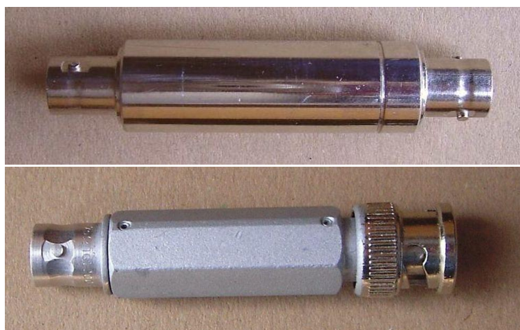
Obr. 2.3.12: Předzesilovače se zesílením 35 dB (www.dakel.cz, 2017)
