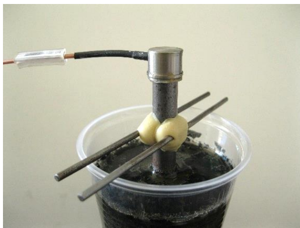
Obr. 3.1.10: Uchycení vlnovodu a snímače AE během tuhnutí a tvrdnutí AAS malty
