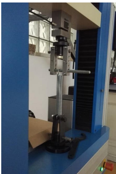
Obr. 123 Kalibrace pružiny v lise LaborTech 6.30.
