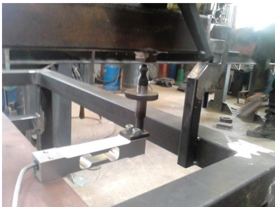
Obr. 3 Detail váhového členu s aretačním šroubem při funkční zkoušce prototypu.
