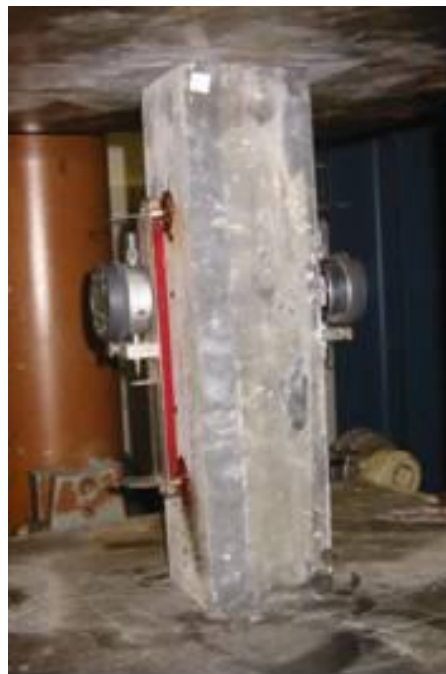
Obr. 13 Zkušební těleso s nalepenými Hollanovými můstky osazenými číselníkovými úchylkoměry.
