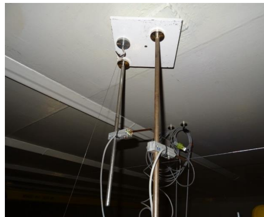
Obr. 142 Souběh měření potenciometrickým a 2 odporovými snímači v jednom bodě.
