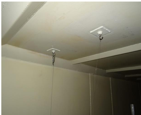
Obr. 141 Samostatný kotevní bod pro závěs potenciometrického snímače.
