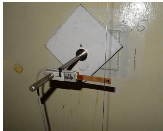
Obr. 145 Tenzometrický snímač v měřícím bodě L3.
