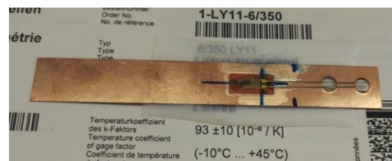
Obr. 128 Planžeta osazená odporovými tenzometry.
