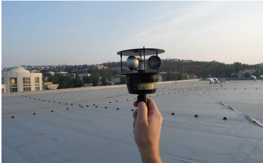
Obr. 95 Měření větru na střešní konstrukci - anemometr Metra 950.
