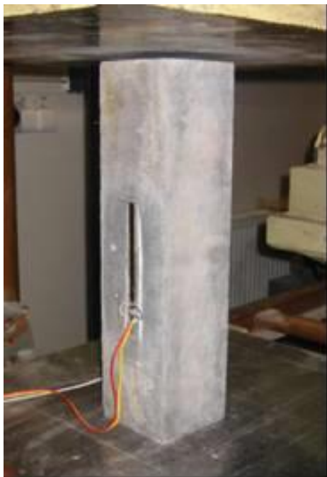
Obr. 12 Zkušební těleso s nalepenými odporovými tenzometry.
