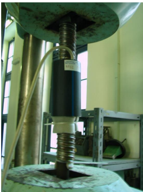
Obr. 27 Kalibrace snímače ME PSS59 v lise.
