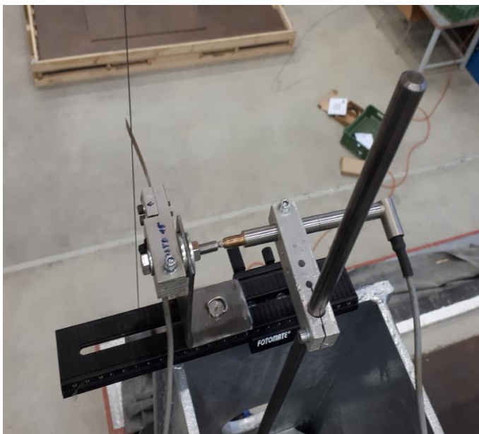
Obr. 125 Experimentální stanovení koeficientu tuhosti svislého lanka.
