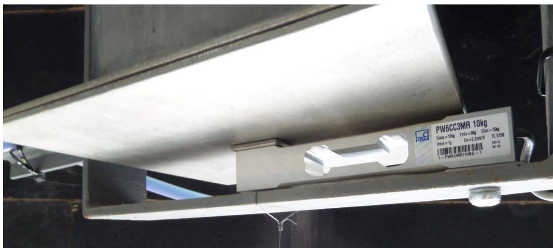
Obr. 79 Detail váhového členu umístěného na závěsu s osazenou patní deskou pro nádobu.
