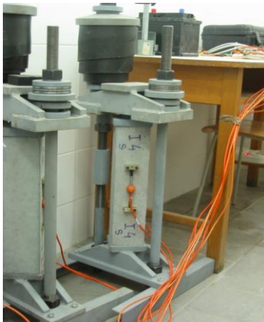
Obr. 8 Dotvarovací lisy s osazenými zkušebními hranoly.
