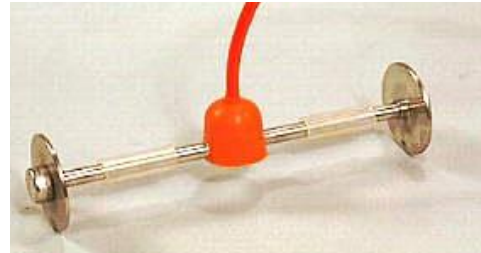
Obr. 48 Strunový tenzometr TES/5,5/T – pro zalití do betonu.
