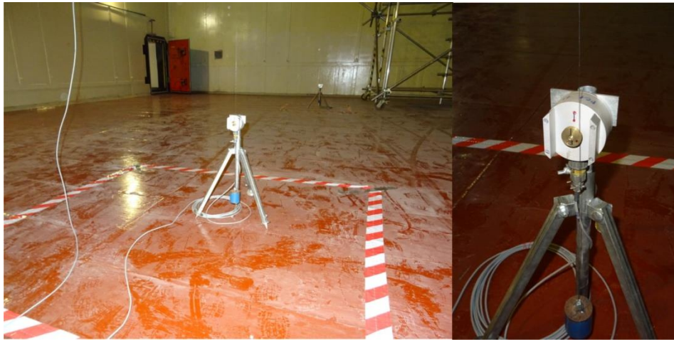
Obr. 143 Potenciometrické snímače MS04 instalované v plynojemu P1.
