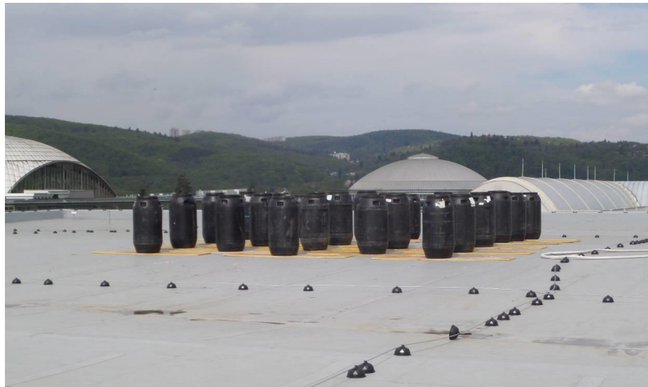
Obr. 86 Rozmístění sudů ve II. Fázi zatěžovací zkoušky.
