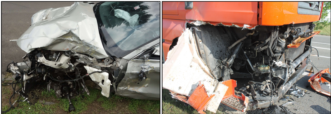
Obrázek 18: Poškození vozidla 1 po střetu s vozidlem 3 a poškození vozidla 3 (autor a policie)
