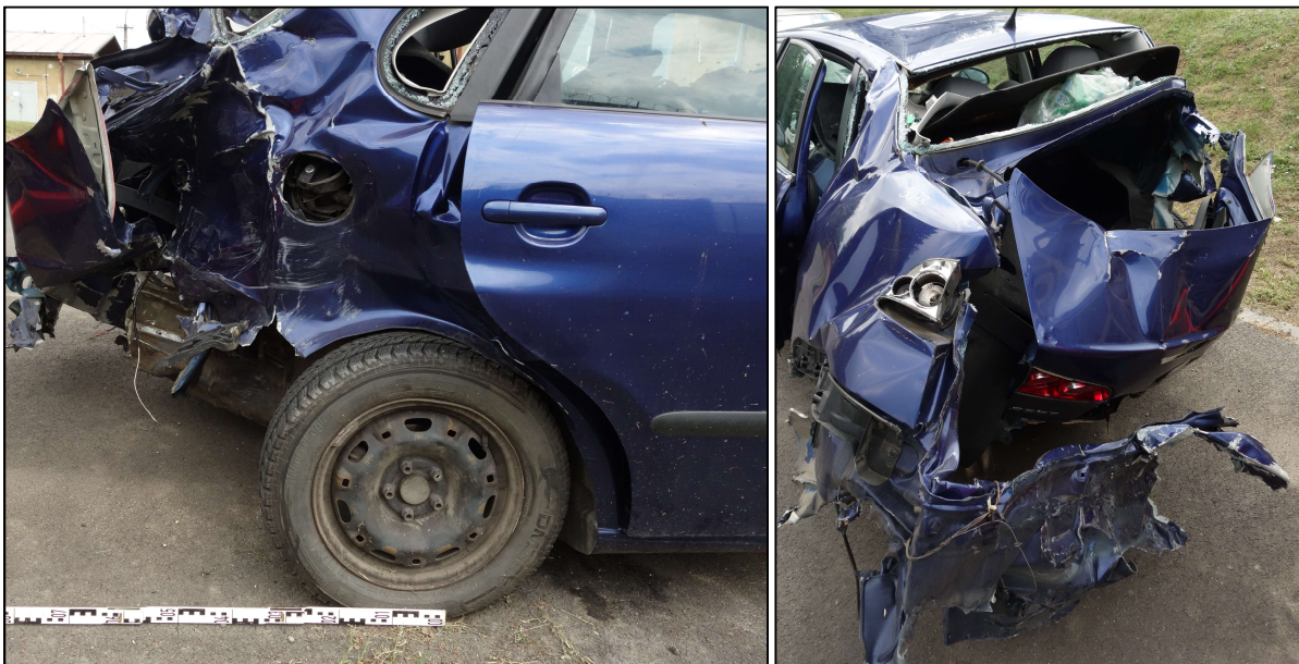
Obrázek 16: Poškození vozidla 2 po nehodě při prohlídce znalcem (autor)
