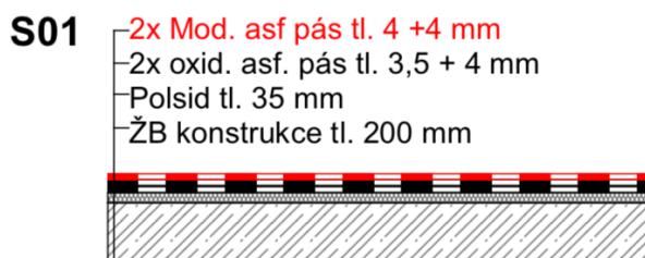
Obrázek 16: Schéma vybrané konstrukce S01 pro vlhkostní analýzu konstrukce ploché střechy s (zdroj: archiv autora)
