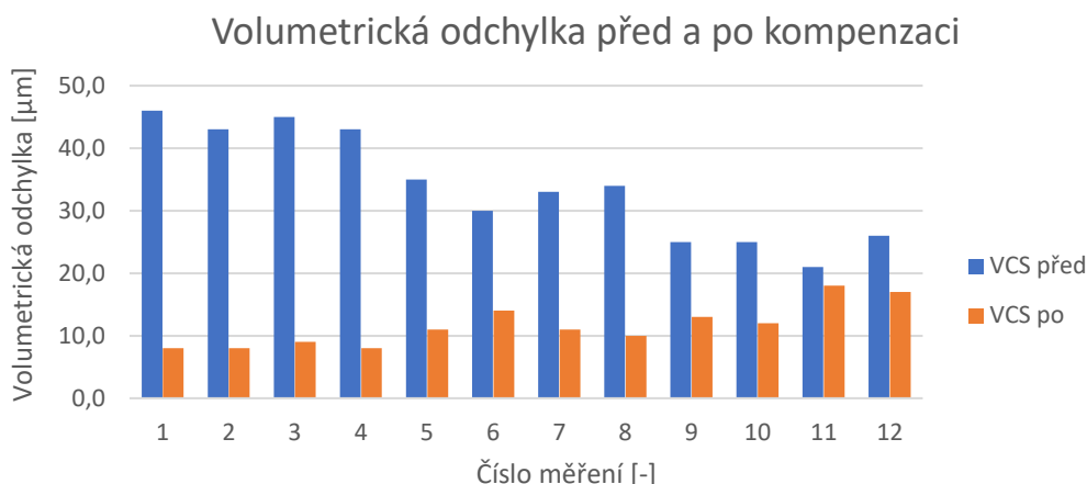
obr. 45 Zobrazení velikosti volumetrické odchylky stroje MCV754 QUICK v závislosti na typu výpočtového modelu a nastavení strategie měření [62]
