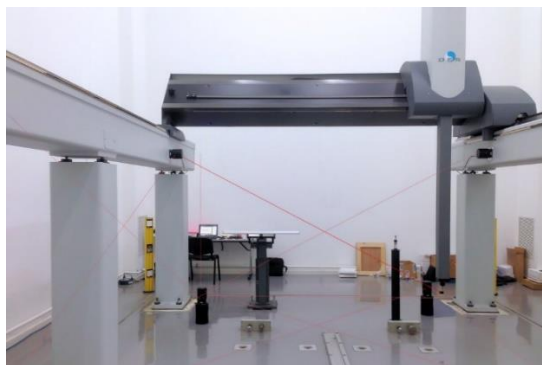
obr. 40 Ukázka nasazení Absolute Multiline na portálové konstrukci [ETALON]
