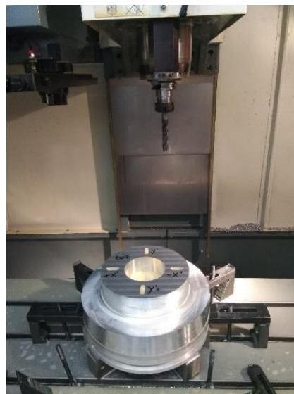
obr. 124 Schéma umístění obrobku v pracovním prostoru stroje
