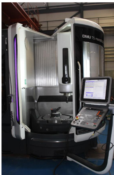
obr. 105 Verifikační měření zkouškou kruhovitosti přístrojem LaserTRACER
