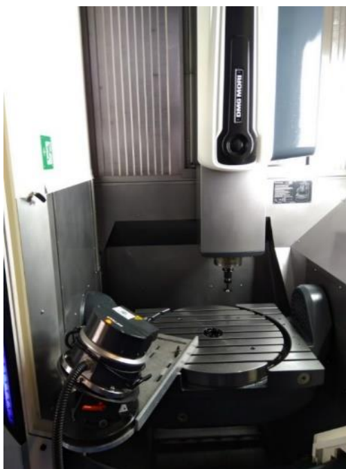
obr. 81 Ukázka měření tříosé kinematiky XYZ pomocí LaserTRACERU
