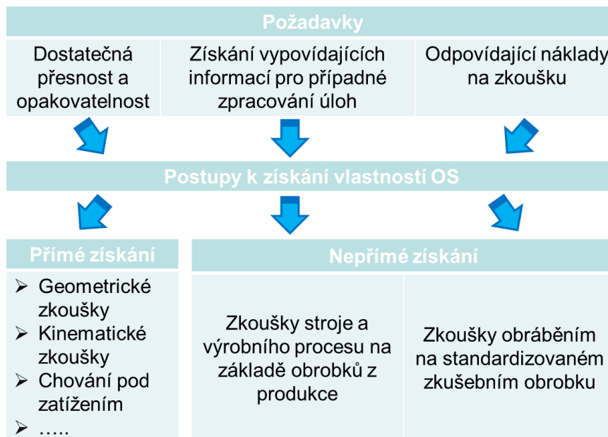
obr. 77 Požadavky na postupy k získání vlastností obráběcích strojů [15]
