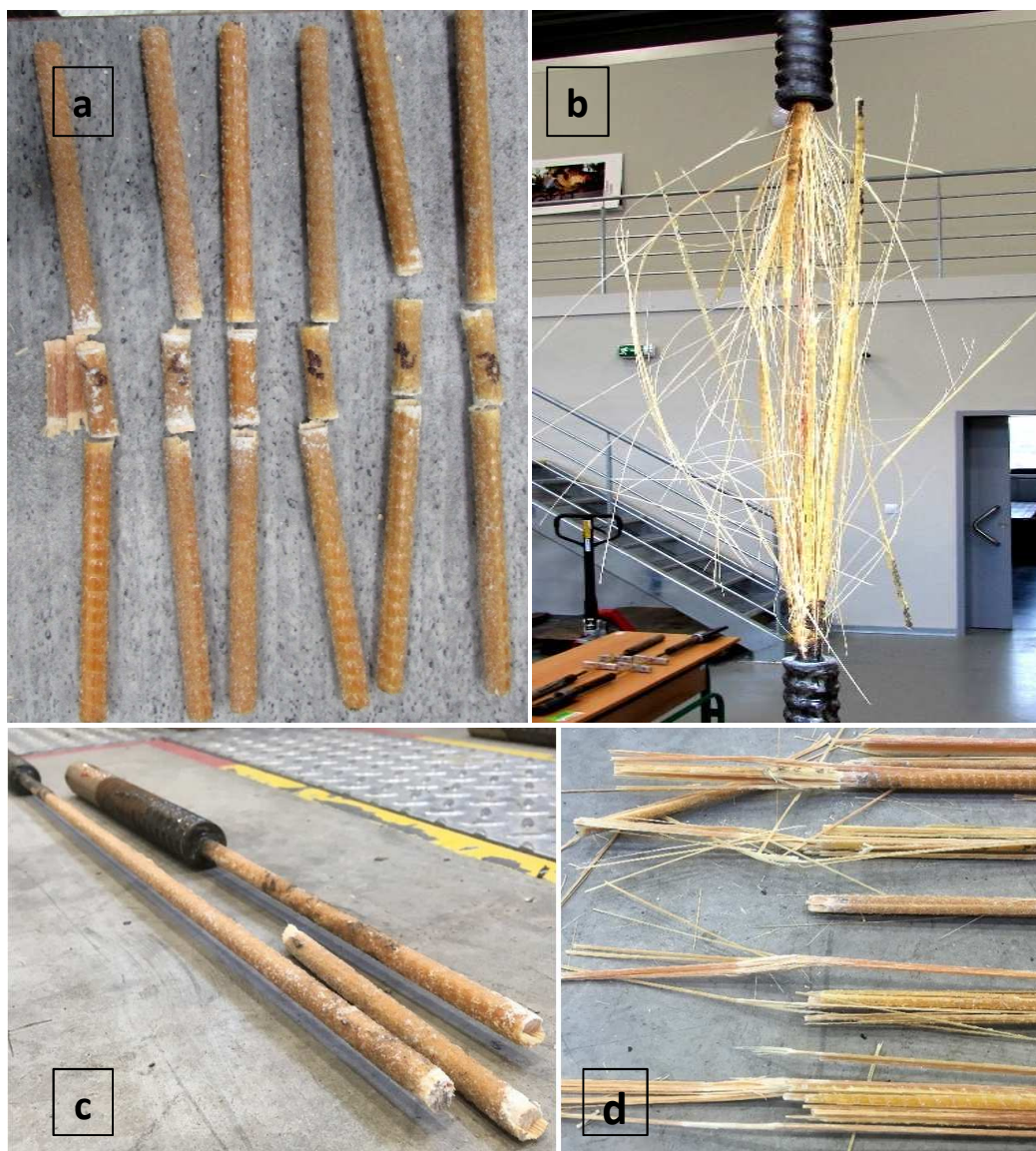
obr. 60: Porušení vzorků GFRP výztuže PREFA ReBAR : a) namáhání čistým smykem; b) čistý tah; c) namáhání N+V - nízká hladina tahové síly; d) namáhání N+V - vyšší hladina tahové síly
