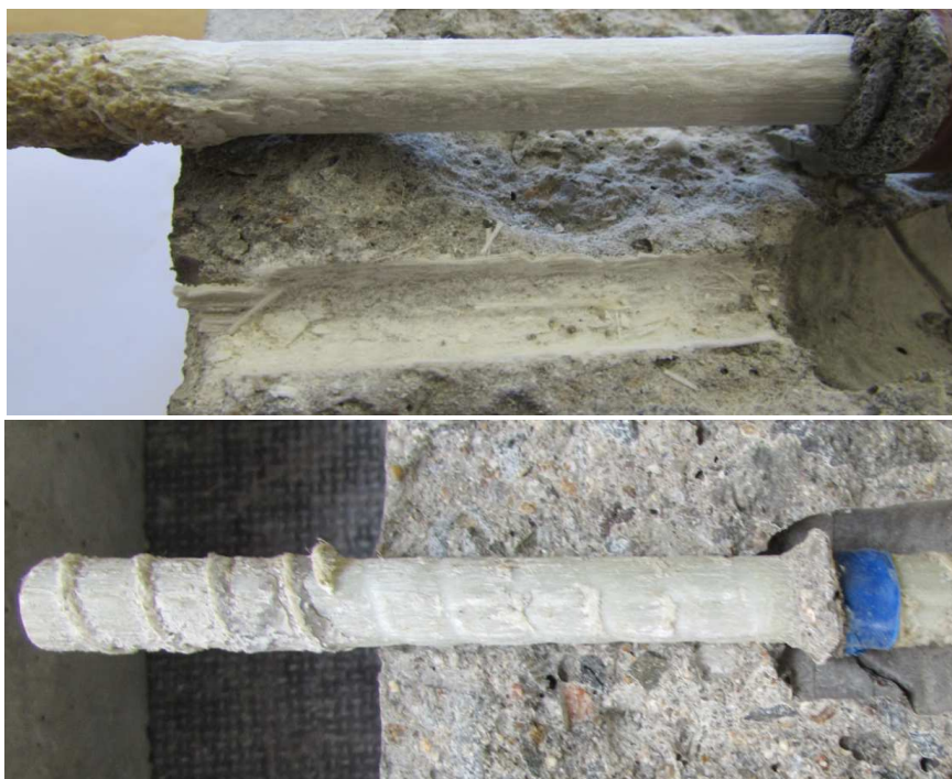
obr. 56: Odlišné porušení vzorku GFRP.AR.VE d650 (nahore) a GFRP.E.VE. d650 (dole)
