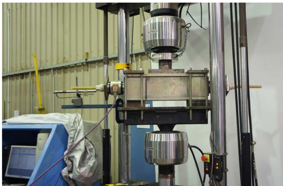
obr. 20: Provedení zkoušky GFRP horninové kotvy v betonovém bloku, převzato z [50]
