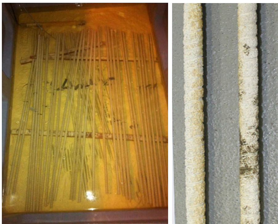
obr. 32: Vlevo: uložení jedné ze sérií vzorků GFRP výztuže v alkalickém roztoku; vpravo: degradované vzorky GFRP-AR-VE po 650 dnech expozice prostředí při 60°C
