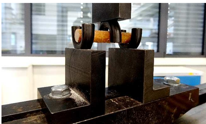
obr. 52: Konfigurace zkoušky v podélném (interlaminárním) smyku (vlevo); výrobní výkres jedné z podpor pro nominální průměr výztuže 10 mm (vpravo)
