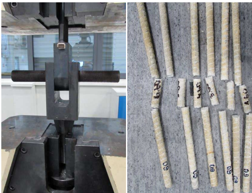
obr. 51: Konfigurace zkoušky v čistém smyku (vlevo) a typický způsob porušení (vpravo)
