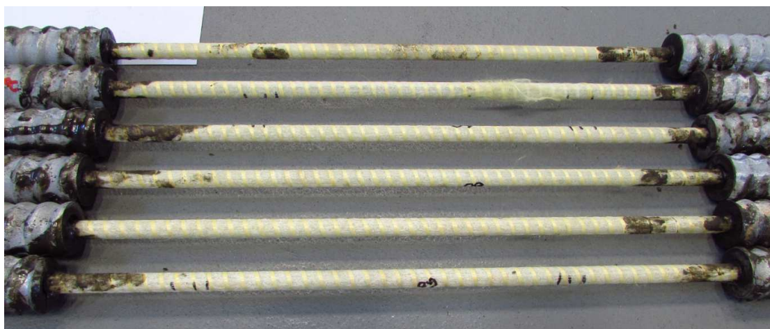
obr. 33: Degradované vzorky GFRP-E-EP, 180 dní expozice v 60°C (plošně bez adhezní vrstvy)
