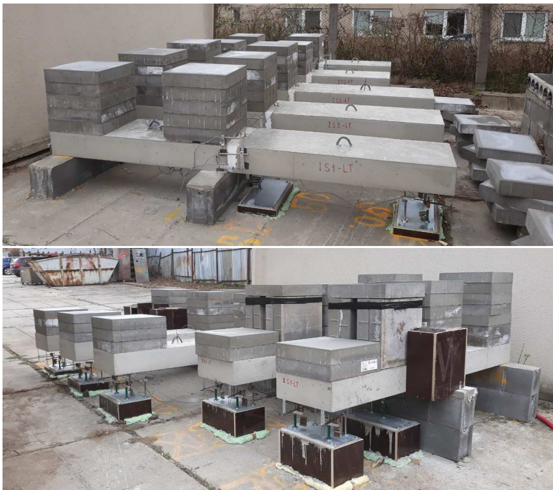
obr. 82: Umístění vzorků pro dlouhodobou zkoušku na standu
