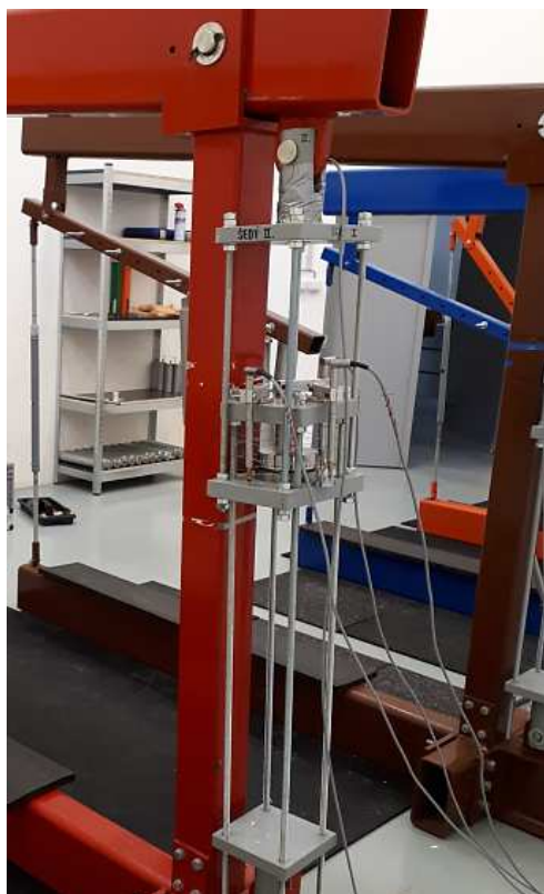
obr. 72: Dlouhodobá zkouška tlakového elementu; vlevo: zkušební zařízení s osazeným vzorkem; vpravo: porušení vzorků
