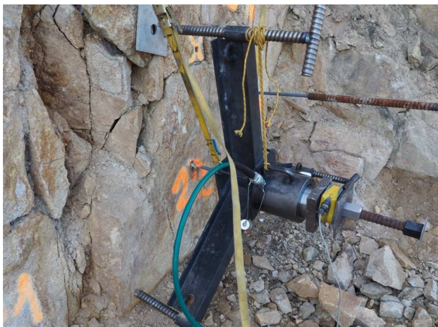
obr. 43: Osazený GFRP horninový svorník při provádění trhací (pull-out) zkoušky; [114]
