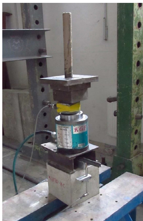
obr. 55: Zkouška soudržnosti - pull-out test dle [6], [58]; provedení a konfigurace zkoušky (vlevo schéma; vpravo reálné provedení)
