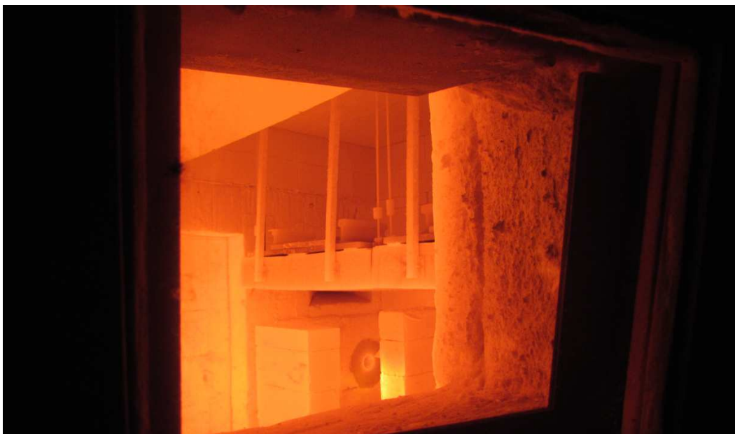
obr. 91: Vzorky v peci v průběhu požární zkoušky
