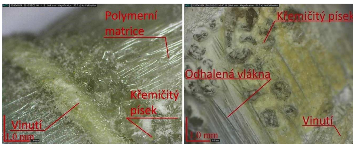
obr. 7: Vlevo: referenční GFRP výztuž uložená v laboratorním prostředí na vzduchu; vpravo: GFRP výztuž uložená 365 dní v alkalickém roztoku při teplotě 40 °C [115]
