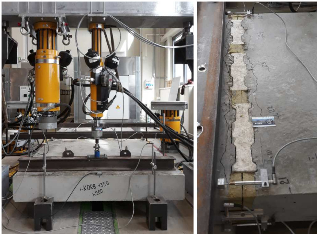
obr. 88: Statická zkouška po provedení únavového testu; vzorek i-KORB_330/T410/S206/C230-h200-P30-I.S3-S
