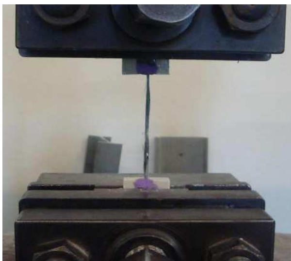
obr. 24: Zatěžovací zkouška vzorků uhlíkových vláken; vlevo detail upnutí vzorků do zatěžovacího zařízení; vpravo porušený vzorek po provedení zkoušky
