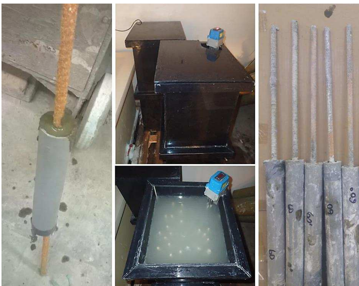
obr. 47: Zkušební tělesa pro degradační zkoušky alkalickým prostředím s krycí vrstvou; vlevo: výroba; uprostřed: uložení vzorků v temperovaném alkalickém roztoku; vpravo: vzorek po vyjmutí z lázně
