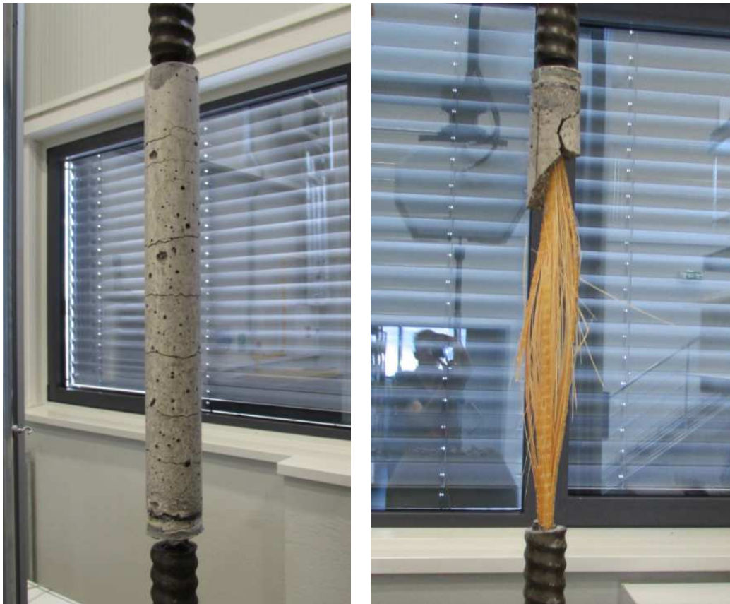
obr. 49: Typický způsob porušení vzorků GFRP výztuže s betonovým válečkem; 1000 hodin expozice
