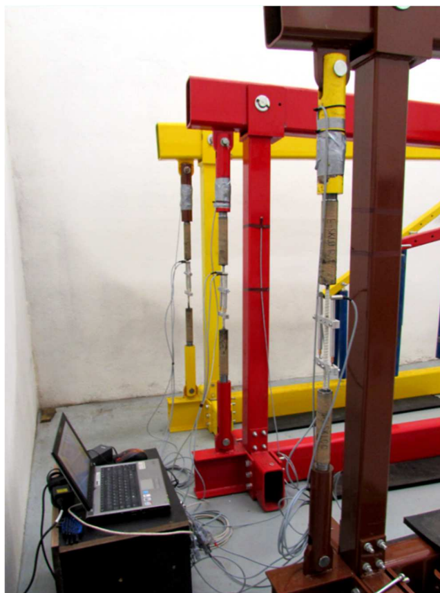
obr. 31: Zkušební zařízení s osazenými vzorky a instrumentací (zkoušky creepu)
