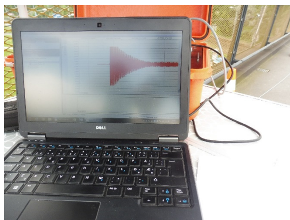
Obr. 9.58 Měřická technika, záznam kmitání závěsu
