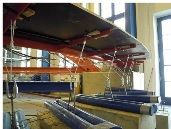
Obr. 7.108 Zavěšení balastní zátěže pod mostovku
