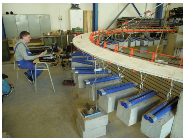
Obr. 9.27 Měřicí ústředna, inдуктивní snímač polohy (průhybů)
