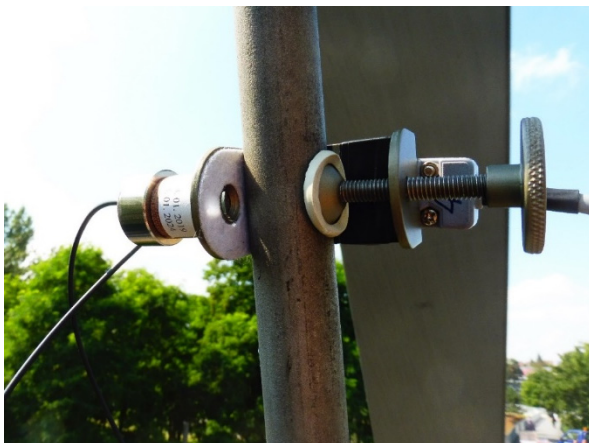
Obr. 4.4 Měřicí přípravek s osazeným akcelerometrem
