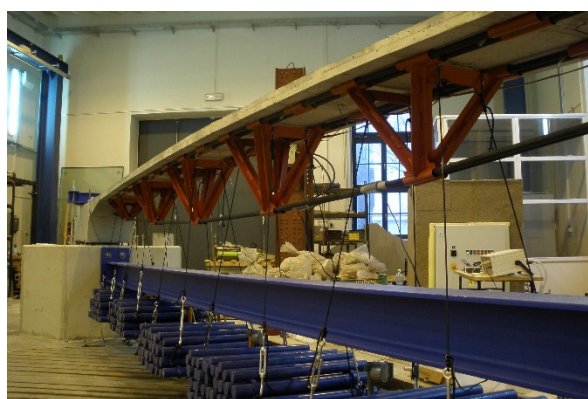
Obr. 2.3 Testování navržené konstrukce na fyzikálním modelu
