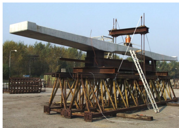
Obr. 8.7 Prvek mostovky před zatěžovací zkouškou
