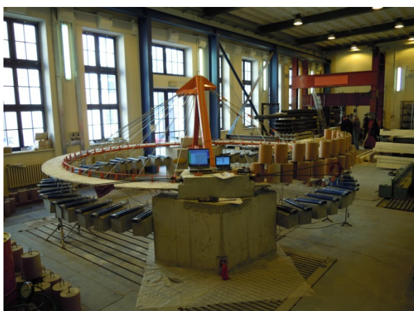
Obr. 7.124 Zatěžovací zkouška pro visutou část – zatížení vlevo
