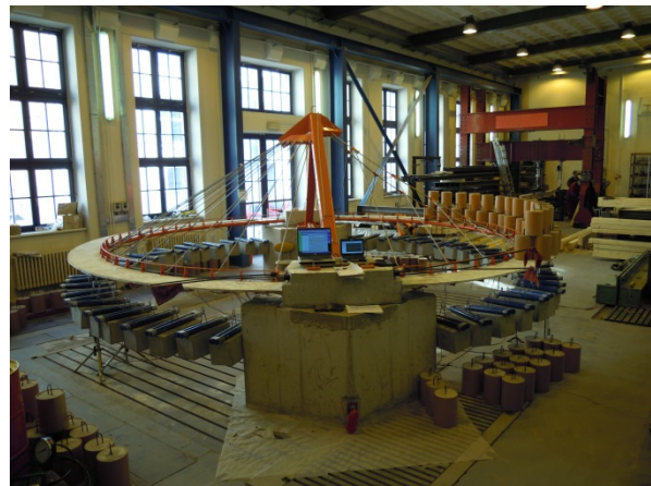
Obr. 7.123 Zatěžovací zkouška pro visutou část – zatížení uprostřed
