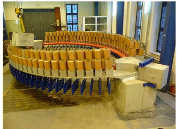
Obr. 7.84 ZS8, mezní zatížení na modelu
