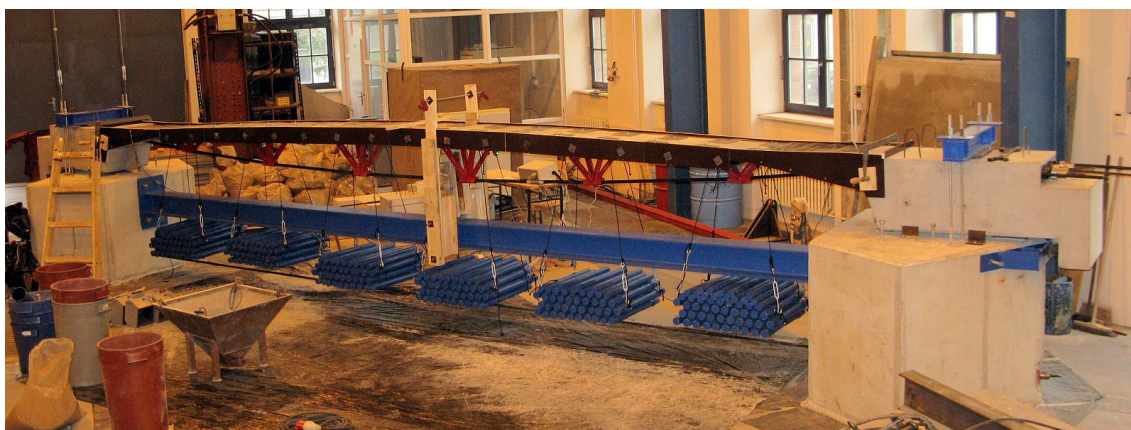
Obr. 7.52 Montáž na nosných lanech a vyzdvižení lávky do požadované geometrie
