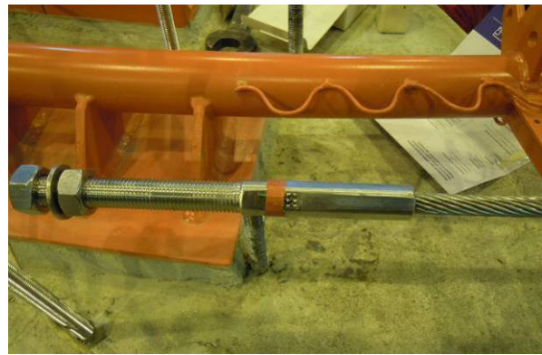
Obr. 7.114 Koncovka lana s tenzometry
