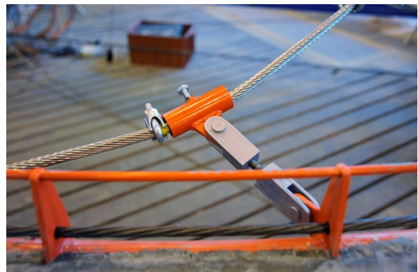
Obr. 7.103 Visutá varianta – vedení předpětí, kotvení závěsů
