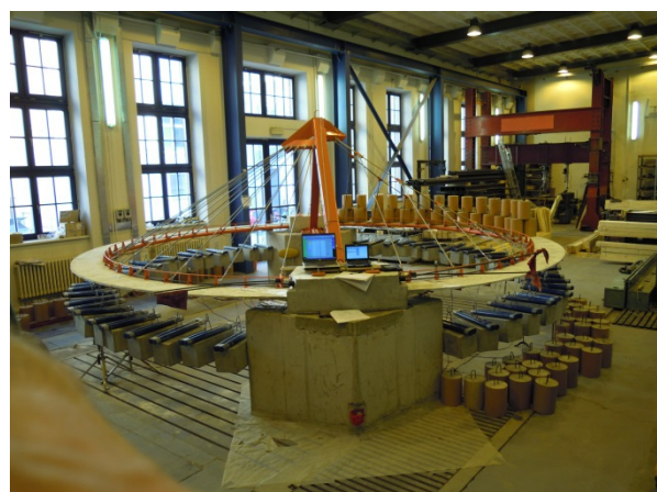
Obr. 7.125 Zatěžovací zkouška pro visutou část – zatížení vpravo
