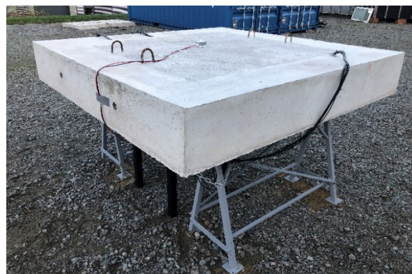
Obr. 8.45 Experimentální prvek pro měření teplot po výšce průřezu
