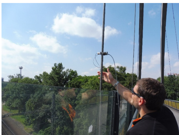
Obr. 9.57 Buzení závěsu osazeného snímačem zrychlení
