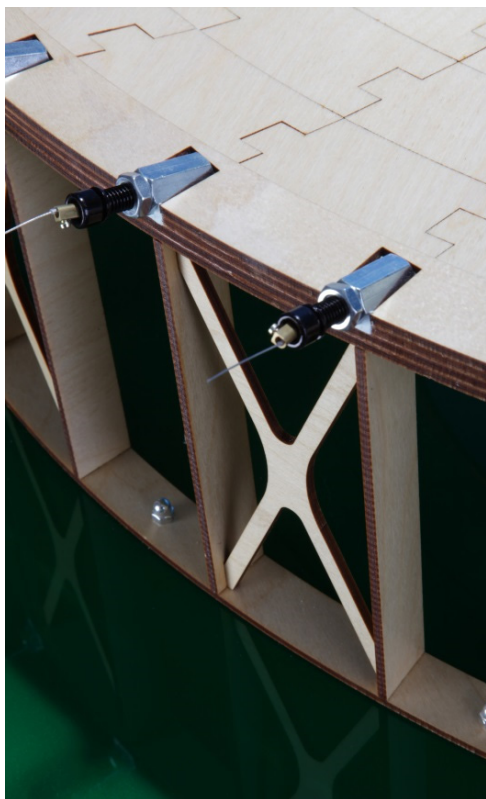
Obr. 10.13 Model, detail kotvení lan
