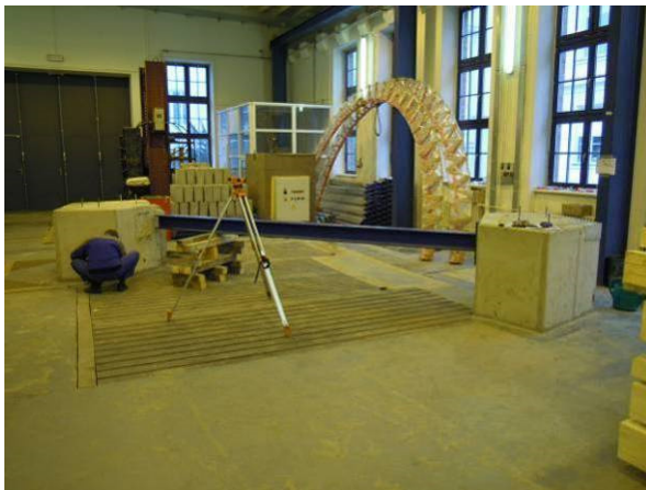
Obr. 7.105 Usazení opěrných bloků ve zkušební laboratoři
