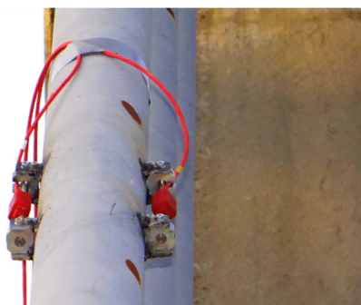
Obr. 9.51 Dvojice tenzometrů osazených na závěsu Z45P
