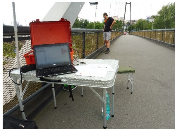
Obr. 4.5 Stanoviště s měřicí ústřednou a záznamovým notebookem
