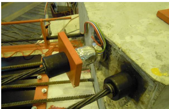
Obr. 7.117 Siloměr pod kotvou kabelu
