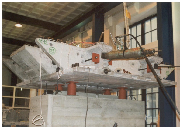
Obr. 7.11 Letmá montáž segmentů
