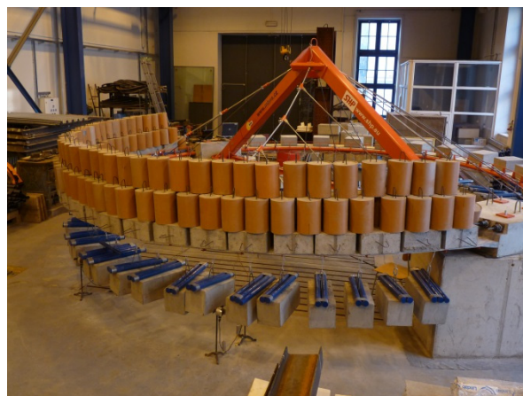
Obr. 7.127 Mezní zatěžovací zkouška pro visutou část
