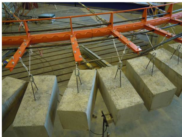
Obr. 7.119 Snímače průhybu v jednom měřičském řezu
