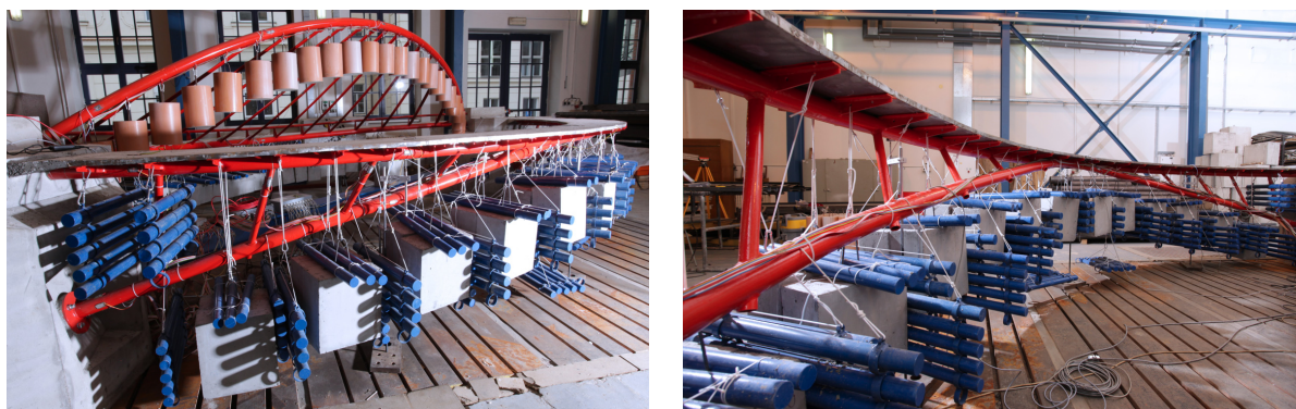
Obr. 7.142 Reálný model před zatěžovacími zkouškami, doplněné balastní zátěží
