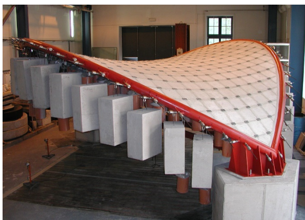
Obr. 7.31 Model střešní konstrukce
