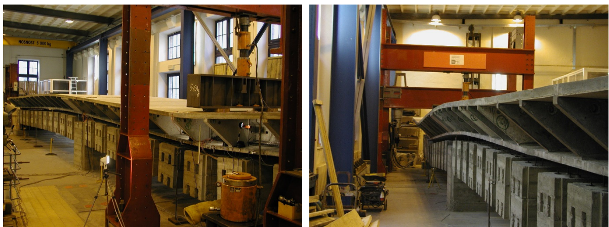
Obr. 7.17 Průhyb modelu při zatěžovací zkoušce
