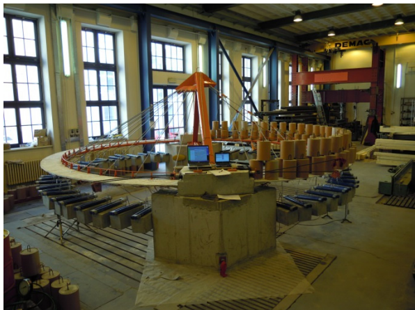
Obr. 7.122 Zatěžovací zkouška pro visutou část – zatížení po celé délce
