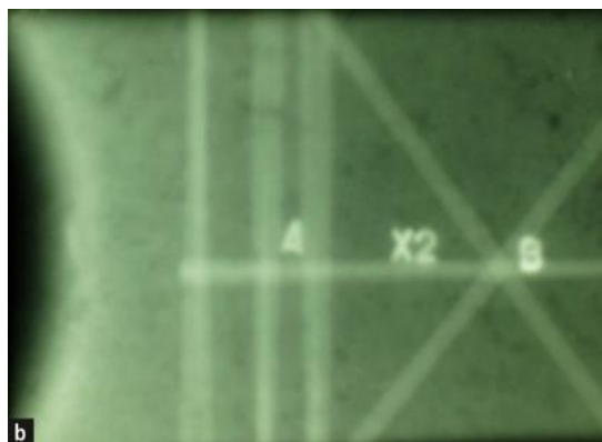
Obr. 160 Jeden z radiogramů v místě chybného vyztužení (vlevo) a jeho zasazení do výkresu výztuže (vpravo).
