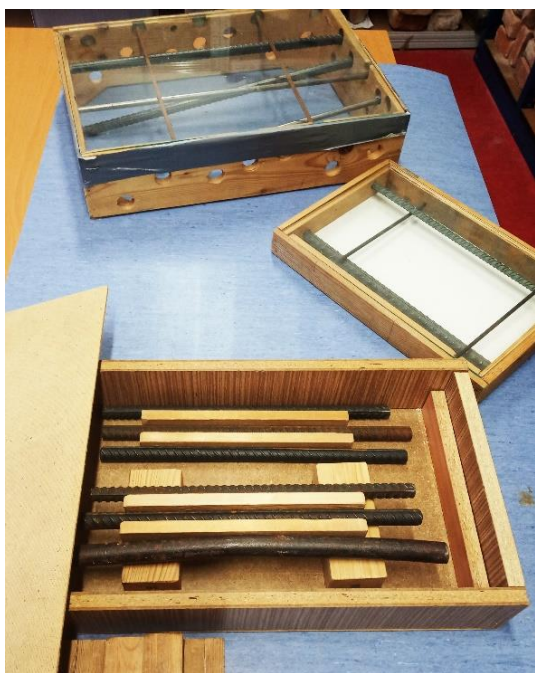
Obr. 39 Krabicové modely s libovolně měnitelnou polohou výztuže (vlevo), a alternativní krabicový model simulující vyztužení konkrétního reálného prvku (vpravo)
