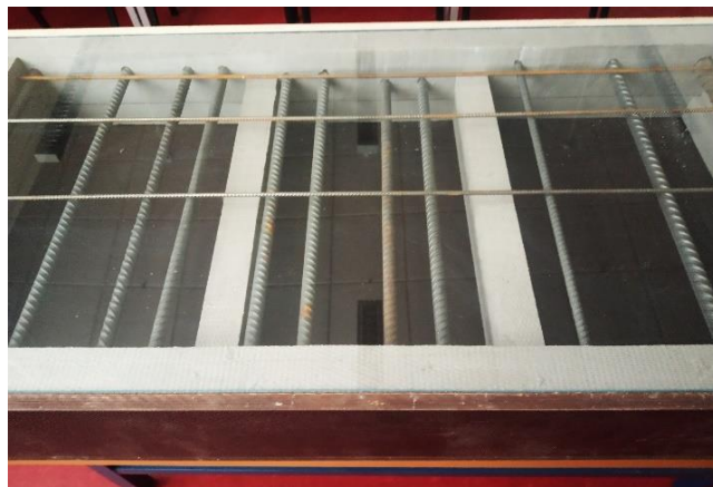
Obr. 39 Krabicové modely s libovolně měnitelnou polohou výztuže (vlevo), a alternativní krabicový model simulující vyztužení konkrétního reálného prvku (vpravo)
