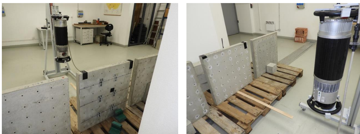
Obr. 221 Jedna ze zkušebních desek připravená k prozařování, na zadní straně je patrné rozložení olověných orientačních značek
