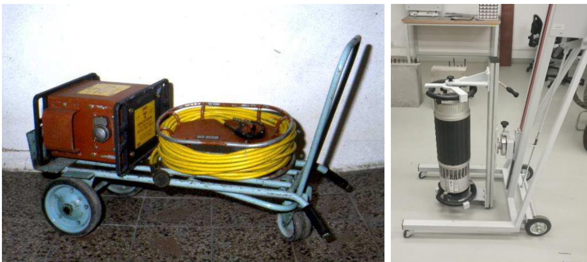
Obr. 2 Gamagrafičský kryt TECH/OPS se zářičem CO60, na transportním vozíku s hadicemi ovládacího zařízení (vlevo) [7] a technický rentgen YXLON SMART 300kV (vpravo)
