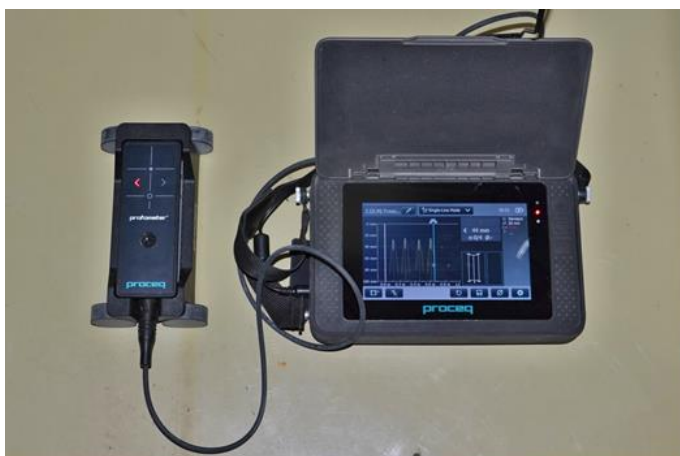
Obr. 23 Proceq Profometer PM 630, s oddělenou měřicí sondou. Profometer PM-6 s dotykovým displejem a integrovanou sondou; svítící šipky na sondě pomáhají lokalizovat výztuž, na displeji lze ihned kontrolovat správnost měření pomocí křivek intenzity signálu [9]
