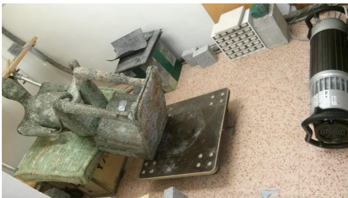
Obr. 175 Prozařování podstavce sochy, vpravo zdroj záření, rentgen YXLON300 kV
