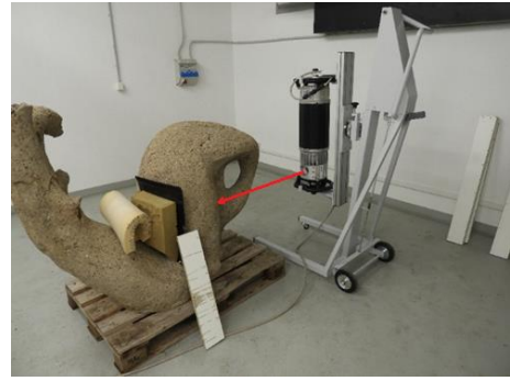
Obr. 199 Radiografie plastiky Torzo ženy. Konfigurace prozařování 8
