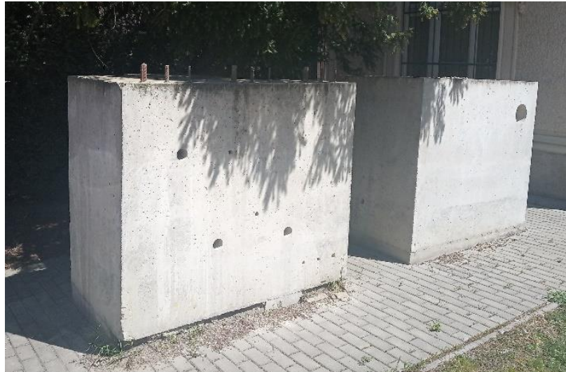
Obr. 41 Dvojice masivních testovacích bloků v areálu Fakulty stavební VUT v Brně. Levý blok obsahuje vybrané nehomogenity, pravý je z prostého betonu pro srovnávací měření
