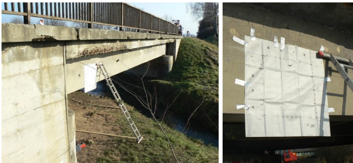
Obr. 97 Celkový pohled a detail umístění měřícího rastru při jednom ze série měření na bočním líci krajního trámu
