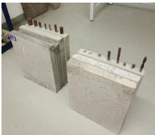
Obr. 45 Součásti testovací dráhy pro radiografii v ozařovně Ústavu stavebního zkušebnictví FAST VUT v Brně
