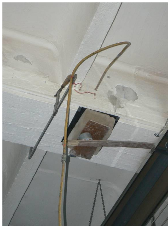
Obr. 15 Detail místa prozařování s patrnou kazetou s radiografickým filmem, hadice pro vysunutí zářiče zasunutá do předvrtaného otvoru [7]
