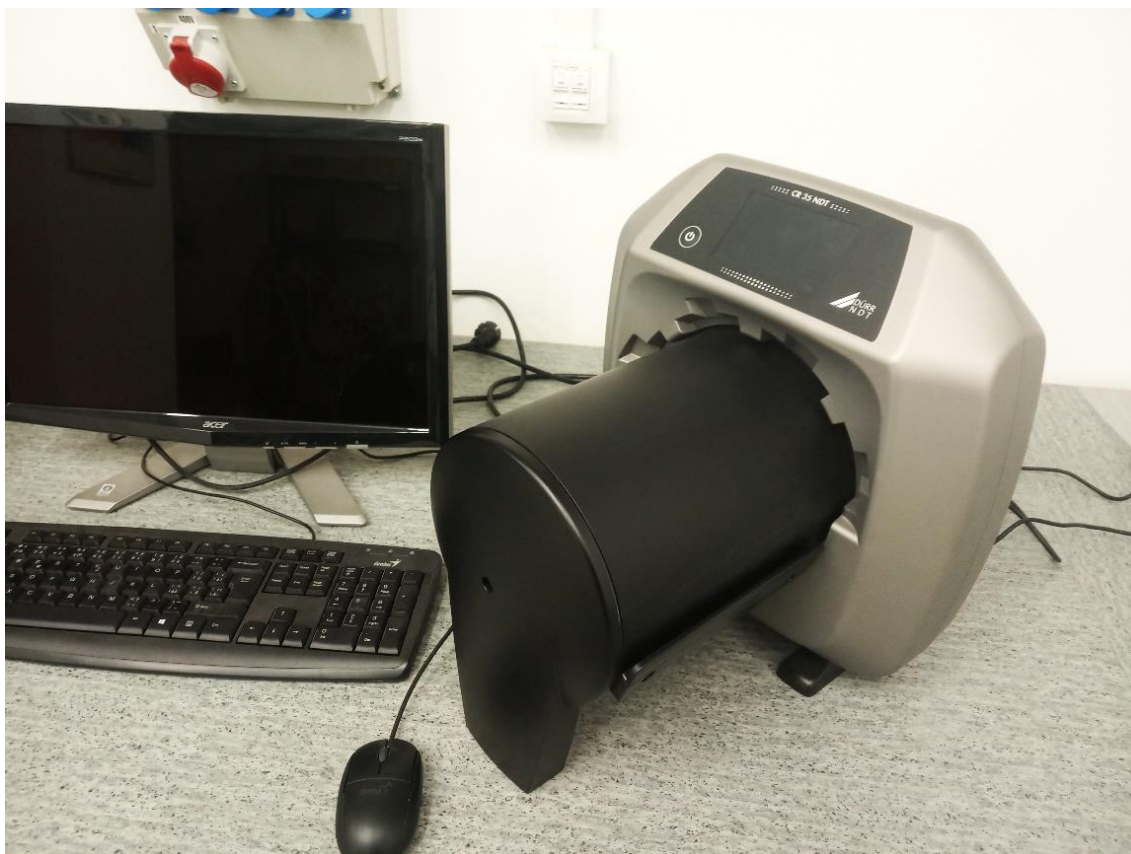
Obr. 3 Rotační laserový Scanner Dürer pro sejmutí obratu z paměťových folií
