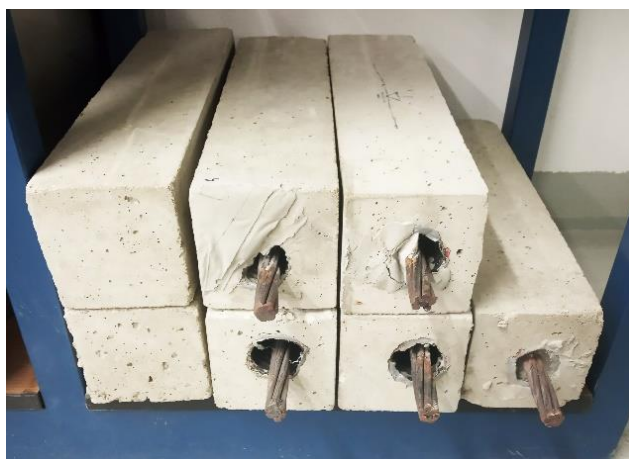
Obr. 45 Součásti testovací dráhy pro radiografii v ozařovně Ústavu stavebního zkušebnictví FAST VUT v Brně
