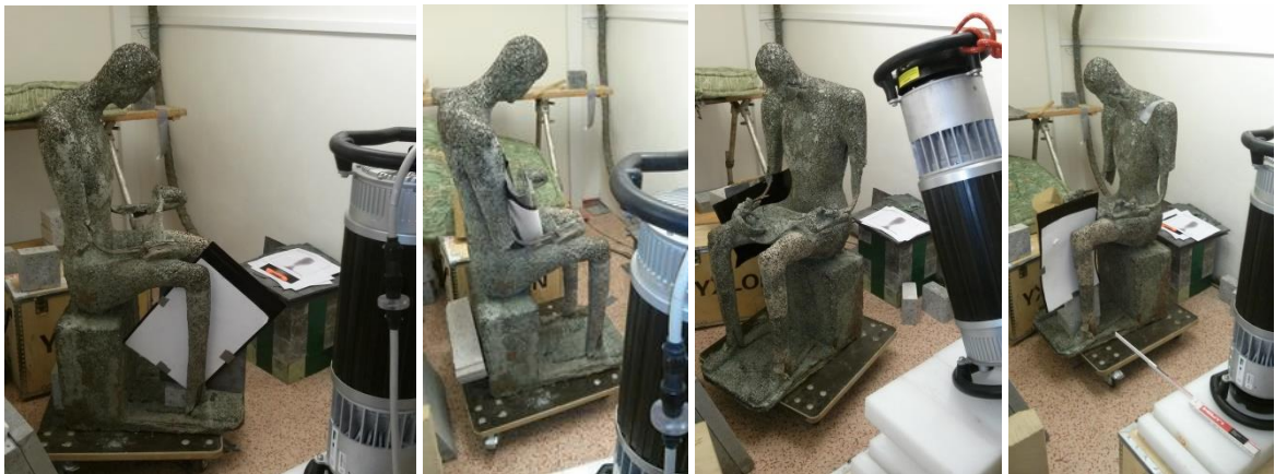
Obr. 179 Prozařování nohou sochy – varianty umístění flexibilní kazety s paměťovou fólií, pro zachycení průběhu výztuží v jednotlivých částech
