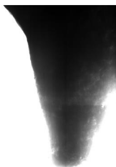
Obr. 215 Radiogram z konfigurace prozařování 9. Na radiogramu není zobrazena žádná výztuž s výjimkou drátěného pletiva
