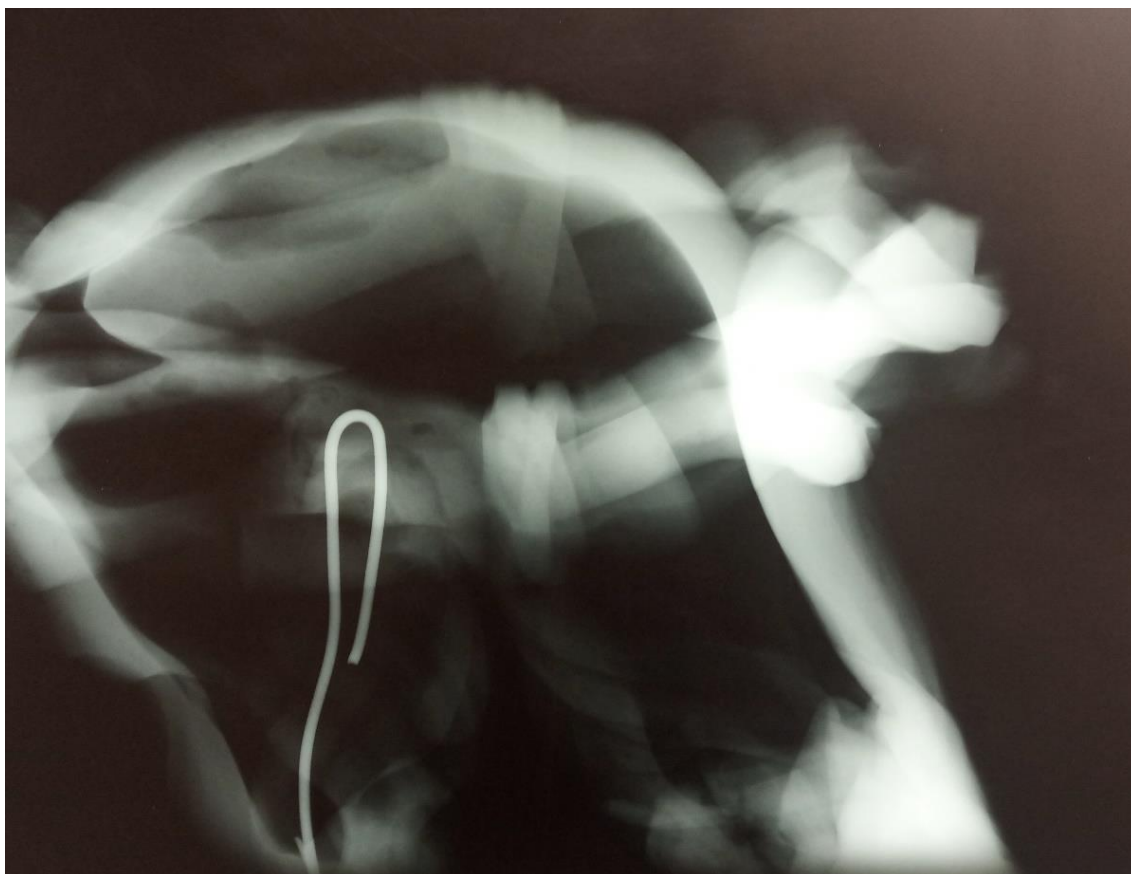
Obr. 20 Rentgenografie hlavy plastiky Krista (Fakulta architektury VUT v Brně), patrné prostorové detaily a vyztužení připojení drapérie trnové koruny
