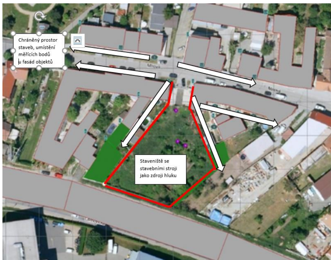
Obrázek 4 Chráněný venkovní prostor staveb, umístění měřících míst na liniích okolních fasád objektů vůči staveništi se zdroji hluku, příklad modelu [©kantova.r@fce.vutbr.cz]
