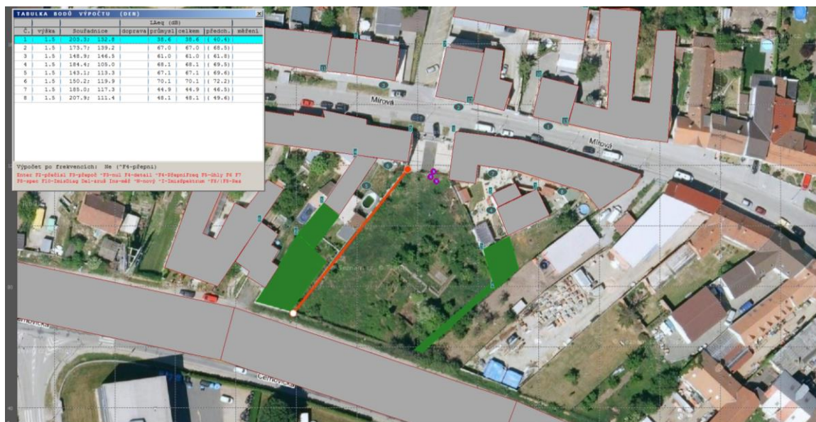
Obrázek 43 SM model v prostředí HLUK plus, screenshot 11, zemní práce pro inženýrské sítě po zohlednění akusticky významných prvků (bez oplocení staveniště a plnoplošné brány) pro vjezd na staveniště v řešeném území, oddělené zapojení strojů [©kantova.r@fce.vutbr.cz]
