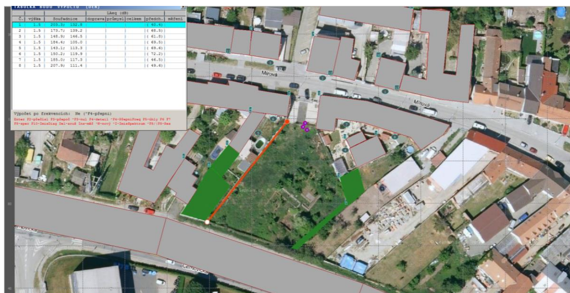
Obrázek 41 SM model v prostředí HLUK plus, screenshot 9, pro zemní práce pro inženýrské sítě po zohlednění akusticky významných prvků (bez oplocení staveniště a plnoplošné brány) pro vjezd na staveniště v řešeném území [©kanto-va.r@fce.vutbr.cz]
