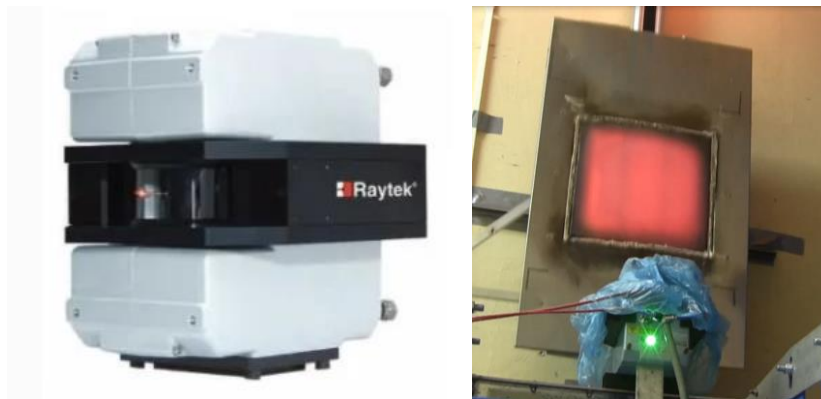
Obr. 105 Řádkový scanner Raytek RAYTMP150MT (vlevo), experimentální deska po průjezdu před řádkovým scannerem umístěným mezi chladicí sekci (dole) a pecí (nahore)
