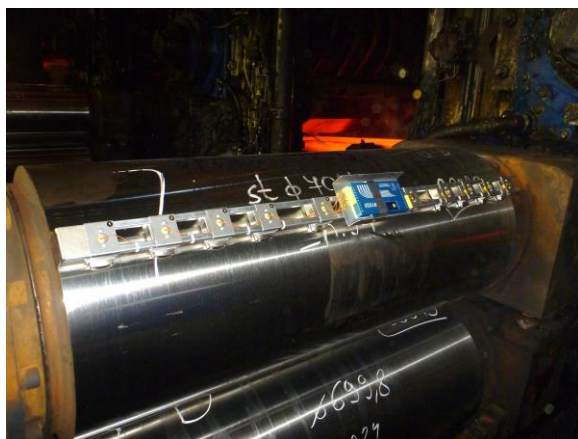
Obr. 24 Zařízení pro měření teplot pracovních válců po vyjmutí z válcovací stolice
