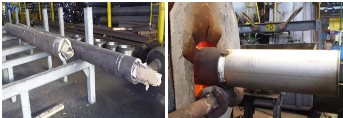
Obr. 73 Trubky osazené termočlánky a nachystané pro připojení dataloggeru (vlevo) a kryt dataloggeru (umístěný na konci trubky) vjíždí do tunelové pece (vpravo), publikováno v [20]
