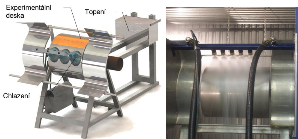
Obr. 22 Schéma experimentálního rotačního zařízení zvané válec (vlevo), fotka tohoto zařízení s chladicími kolektory (vpravo)
