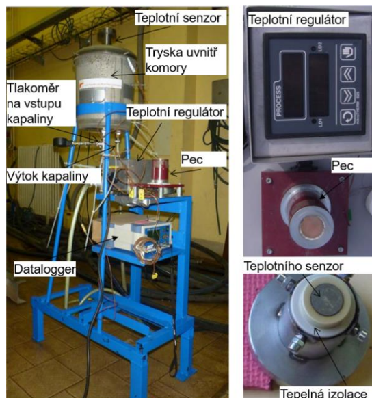
Obr. 27 Zařízení pro statické měření vlivu emulzí a různých přísad na velikost součinitele přestupu tepla, řez teplotního senzoru se zabudovaným termočlánkem, publikováno v [14]
