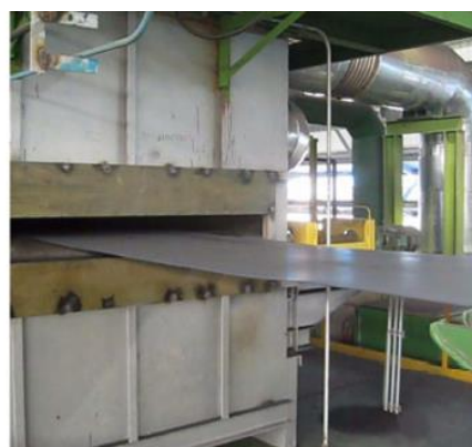
Obr. 90 Porovnání predikovaných (vypočítaných) průtoků s reálnými pro 6 různých režimů chlazení (vlevo), rovinnost plechu po vyjetí z chladicí sekce (napravo), publikováno v [26]
