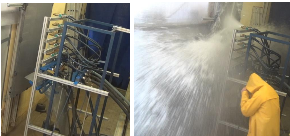
Obr. 99 Ukázka chladicí sekce při studených testech (vlevo), ukázka ze studeného testu (vpravo)
