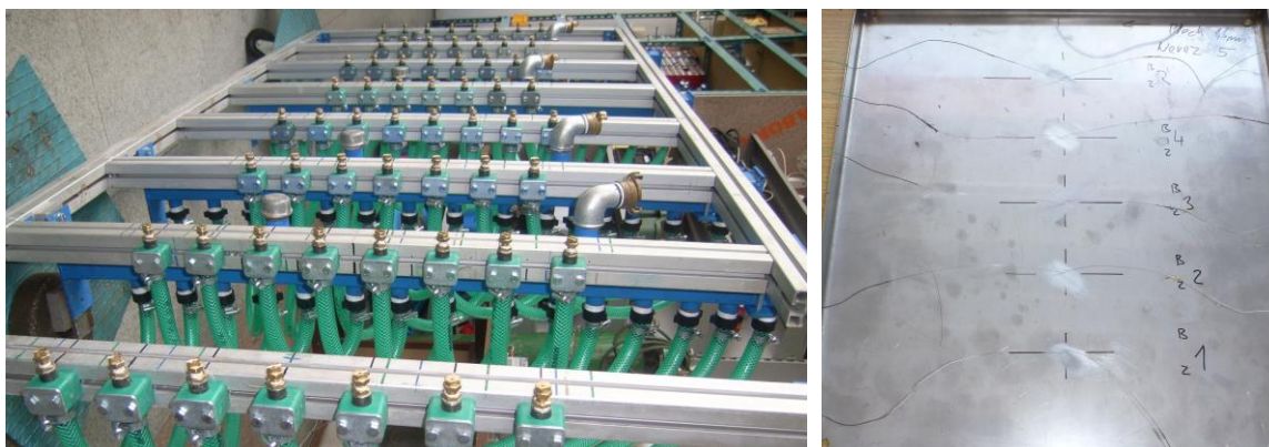
Obr. 87 Ukázka laboratorní chladicí sekce (vlevo), přivařené termočlánky na zadní straně plechu (vpravo)
