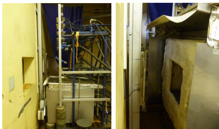
Obr. 101 Ukázka chladicí sekce pro teplotní testy (vlevo), pec umístěná pod chladicí sekci (vpravo)
