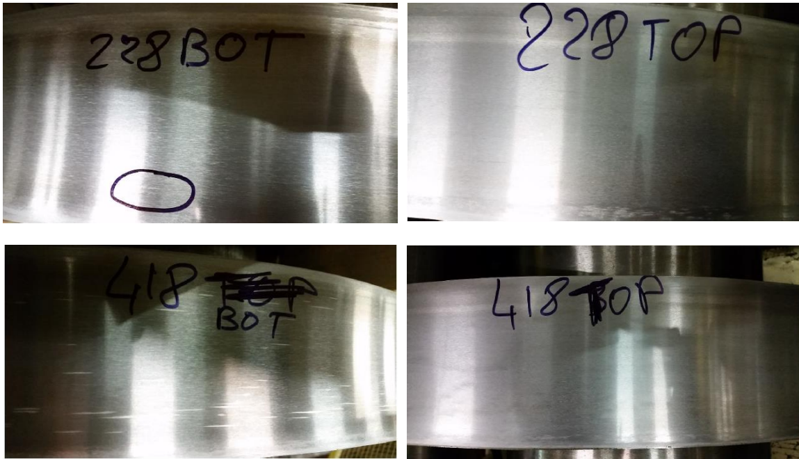
Obr. 26 Vrypy na plechu způsobené při válcování za studena na testovací trati, spodní strana plechu vlevo a horní strana plechu vpravo
