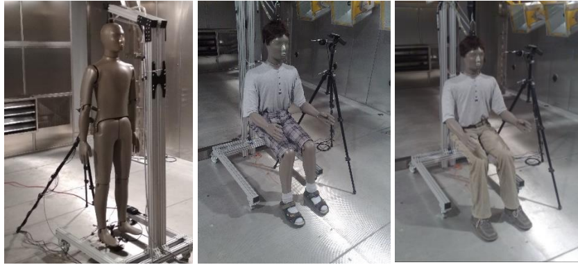
Obr. 181 - Fotodokumentace různých oděvů a poloh při kalibraci manekýna přímo v klimatické komoře. Zleva: Stojící manekýn bez oděvu a vlasů, sedící manekýn lehký letní oděv, letní oděv. Vše kalibrace přímo v klimatické komoře bez boxu. Zdroj archiv autora.
