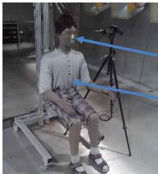
Obr. 183 – Schématický postup výpočtu kalibračních koeficientů h_{cal} pro část manekýna Tvář (Face) a Hrud' (Chest). Převzato a upraveno z [363].
