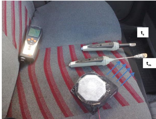
Obr. 70 – Improvizovaný psychrometr pro ověření vlhkosti vzduchu měřené elektronickým vlhkoměrem v kabině automobilu při teplotě vzduchu cca 48 °C. Teploměr t_s měřil teplotu suchého teploměru, teploměr t_m s navlhčenou bavlnou měřil teplotu mokrého teploměru, radiální ventilátor zajišťoval proudění vzduchu. Výsledky měření byly: t_s = 47.5 °C, t_m = 29.2 °C, relativní vlhkost dle h - x diagramu cca 25 %, změřená vlhkost el. vlhkoměrem byla 23 %.
