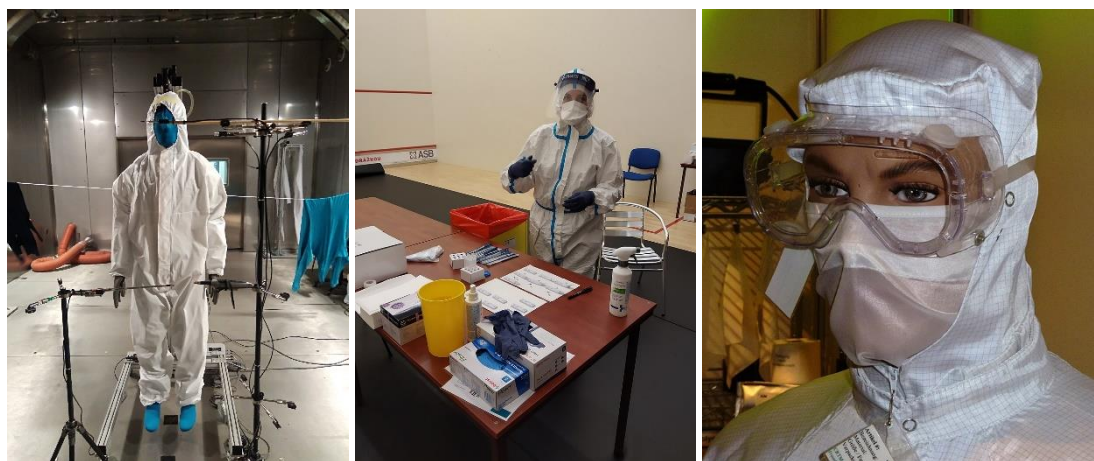
Obr. 44 – Vlevo: Ochranný jednorázový oděv pro biologicky kontaminované prostředí – měření vlastností na tepelném manekýnovi Newtonovi (archiv autora). Uprostřed: Ochranný oděv proti biologické kontaminaci využívaný na odběrových místech pro testování na COVID-19. Vpravo: Detail opakovaně použitelného oděvu do čistých prostor s ochranou očí a dýchacích cest. Převzato z [186], [187].
