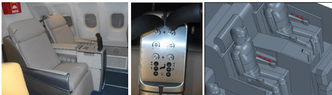
Obr. 170 – Vlevo: Plně vybavené dvojsedadlo určené pro business třídu instalované v FTF maketě. Střed: Ovládací panel integrovaných HVAC technologií pro ohřívání vzduchu, zvlhčování vzduchu, vyhřívání a ventilaci kontaktní plochy sedadla. Vpravo: Model sedadla a virtuálních manekýnů v CFD simulaci. Zdroj archiv autora.
