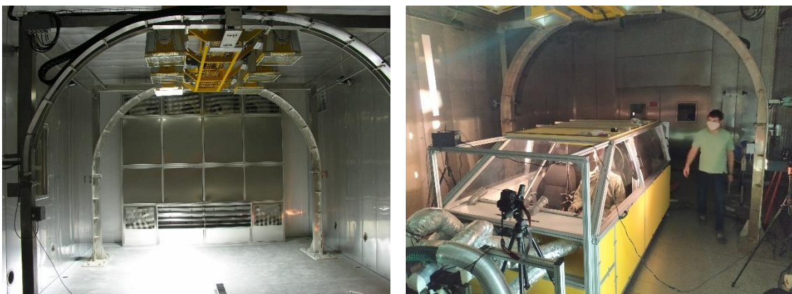
Obr. 162 – Vlevo: Klimatická komora FSI, VUT v Brně s částečně zapnutým solárním simulátorem. Vpravo: Kolega O. Pech kontroluje nastavení makety kabiny pro testování HVAC systémů umístěnou v klimatické komoře při testech větracího systému se stropní výustkou. Zdroj archiv autora.
