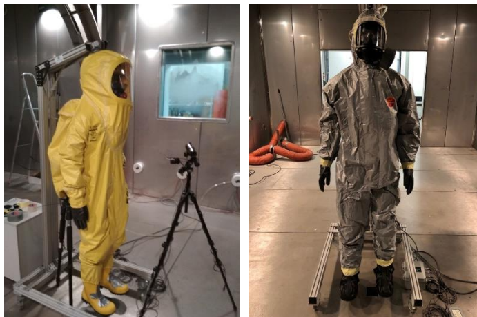
Obr. 45 – Vlevo: Ochranný opakovaně použitelný protichemický oděv OPCH. Vpravo: Jednorázový oděv Tychem-F. Měření vlastností na tepelném manekýnovi Newtonovi (archiv autora).
