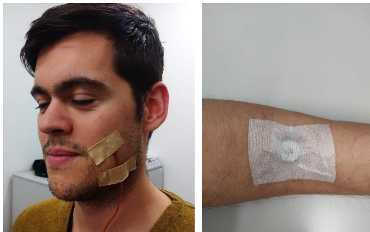
Obr. 113 – Vlevo: Připevnění termočláneku k pokožce na tváři pokusné osoby. Využití „obyčejné“ náplasti se neosvědčilo a bylo později nahrazeno prodyšným materiálem Omnifix fy Hartmann. Vpravo: Kompaktní teploměr s loggerem typu iButton připevněným páskou Omnifix na paži pokusné osoby. Zdroj archiv autora.
