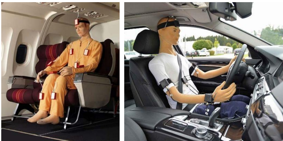
Obr. 81 – Vlevo: Systém DRESSMAN (Dummy Representing Suit for Simulation of huMAN heat loss) ve verzi z 90. let. Hlavní vlastností senzorů byla bezdrátovost, jak v přenosu dat, tak v napájení. Vpravo: Aktuální podoba systém DRESSMAN 3.2, která je v současné době dostupná na trhu má senzory připojeny pomocí kabelů a umožňuje i nezávislé měření teploty vzduchu u každého senzoru. Převzato z [280], [285]
