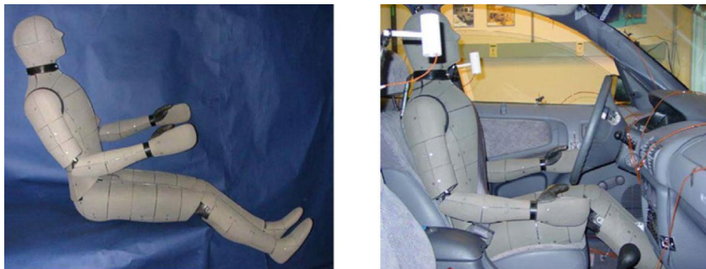
Obr. 100 – Kompletní tepelný manekýn ADAM vytvořený speciálně pro testování prostředí v automobilech. Uvedení do provozu 2001-2003, USA. Převzato z [285].
