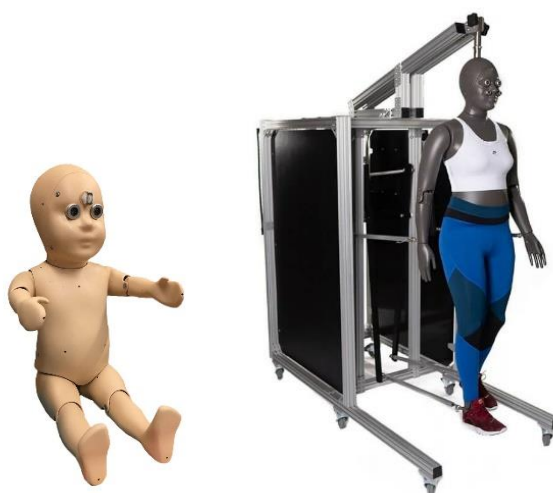
Obr. 102 – Vlevo: RUTH dětský manekýn s 11 segmenty a možností simulace pocení o velikosti dítěte věku 9 měsíců, uvedení na trh 2017, USA. Vpravo: LIZ manekýna s dámskou geometrií odvozená od systému NEWTON. Uvedení na trh 2021, USA. Převzato z [319]
