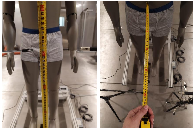
Obr. 71 – Příklad jednoduché fotografické dokumentace polohy anemometrické sondy (stříbrná „tyčka“ s černým koncem) vůči manekýnovi a podlaze klimatické komory. Zdroj archiv autora.
