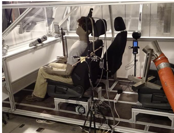
Obr. 74 – Kulový teploměr jako sonda umístěná nad přístrojem Testo 480 (modrý display) použitý k určení střední radiální teploty v maketě kabiny. Teploměr je umístěn za sedadlem, aby nebyl ovlivněn povrchovou teplotou manekýna. Zdroj archiv autora.
