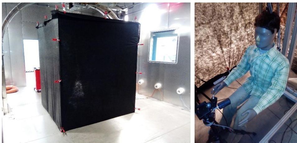
Obr. 182 – Vlevo: Kalibrační box 2 x 2 x 2 metry pro kalibraci manekýna postavený v klimatické komoře. Vpravo: Kalibrace manekýna s oděvem pro jarní/podzimní podmínky (tričko, košile, kalhoty, uzavřené boty), poloha v sedě. Zdroj archiv autora.
