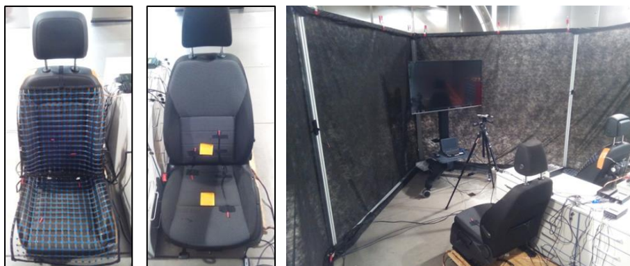
Obr. 168 – Vlevo: Větraná sedačka se speciální sítí pro měření hustoty tepelného toku [W/m 2 ] v kontaktních plochách sedadla a kontrolní sedačka bez větrání. Vpravo: Pohled do klimatické komory s kompletním vybavením pro experiment. Zdroj archiv autora.
