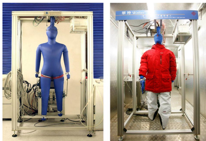
Obr. 96 – Vodní tepelný manekýn Walter pro testování oděvů. Uvedení do provozu 2002, Hong Kong. Převzato z [291].
