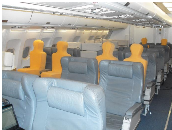
Obr. 108 – Část letecké kabiny uzavřená v podtlakové komoře je určena pro testování nových systémů a vybavení kabiny dopravních letadel. V letectví je to maximální možné přiblížení reálným podmínkám při testech s necertifikovanými technologiemi. Testování v projektu iSPACE probíhalo v této kabině za účasti 3 skupin po 18ti osobách v roce 2013. Fotografie byla pořízena večer před začátkem prvního testovacího týdne v listopadu 2013. Zdroj archiv autora.
