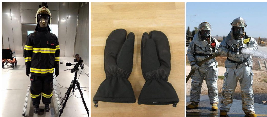
Obr. 43 – Vlevo: haličský oděv Tiger používaný HZS ČR (archiv autora). Uprostřed: speciální rukavice pro práci v mrazárnách, kontaktní chlad při teplotách -15 až -20 °C (archiv autora). Vpravo: ochranný oděv pro zásahy s intenzivním radičním přenosem tepla (stříbrný povrch oděvů má nízkou emisivitu a tím snižuje přenos tepla radiací). Převzato z [185].
