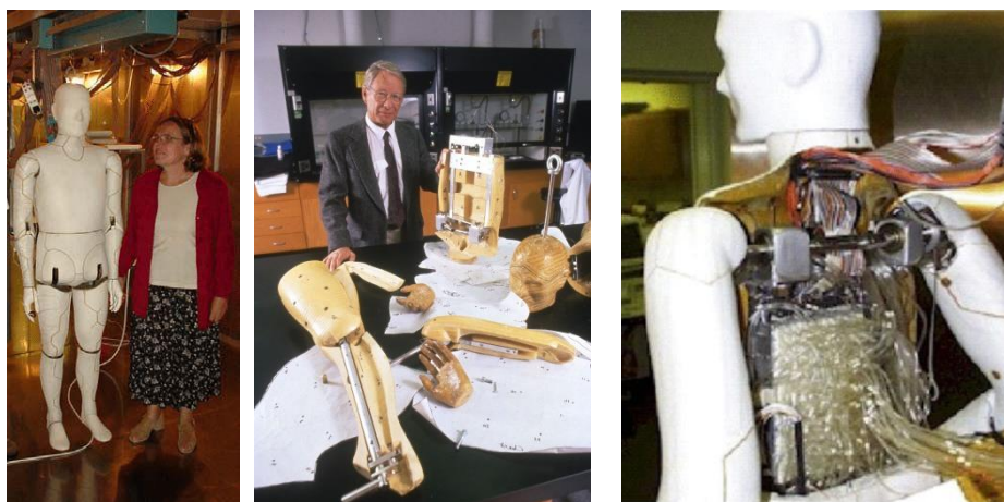
Obr. 92 – Vlevo: Originální COPPELIUS vyvinutí v roce 1988 na Universitě v Tampere, Finsko po vedení Dr. Harriet Meinander. Uprostřed: Dr. Ben Malstorm s konstrukčními částmi manekýna COPPELIUS licencovaného na NC State University, USA. Fotografie zobrazuje průběhu výroby manekýna, kdy na povrch ještě není aplikována bílá textilie pro distribuci vody z pórů. Vpravo: Pohled od útroby manekýna s detailem na trubičky systému pro simulaci pocení. Převzato z [252], [301], [307].
