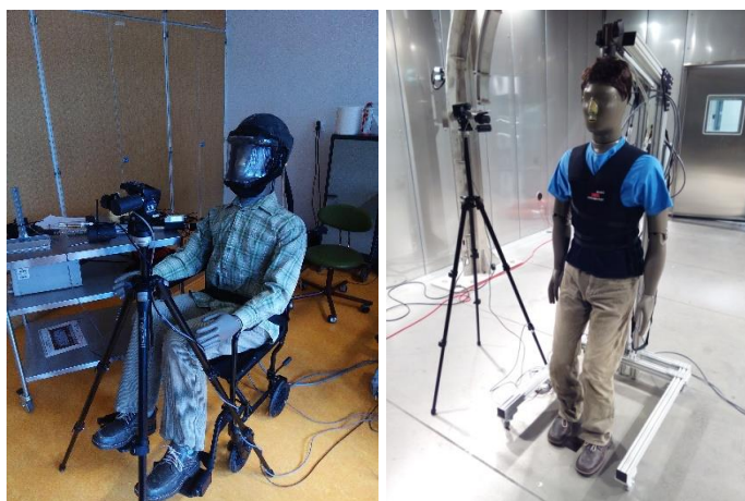
Obr. 65 – Vlevo: Speciální ochranná kukla s dodávkou filtrovaného vzduchu při testování na manekýnovi. Vpravo: Testování tepelných vlastností a akumulčních schopností chladicí vesty s PCM materiálem na tepelném manekýnovi. Zdroj osobní archiv autora.
