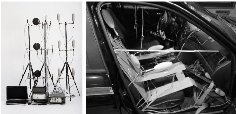
Obr. 80 – Vlevo: Data logger INNOVA 1221 a stojan s připojenými sondami. Zdroj archiv autora. Vpravo: Systém Flatman použitý při projektu EQUIV využíval celkem šest senzorů s geometrií elipsoidu pro určení ekvivalentní teploty v kabině testovaného vozidla. Převzato z [281].
