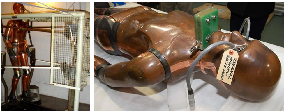
Obr. 90 – Vlevo: USARIEM 1984, nový pohyblivý manekýn UNCLE WIGGLY. Vpravo: Retrofit vyhřívacích elementů a řídicí elektroniky 2003 od firmy Thermetrics. Zařazen do sbírek National Museum of Health and Medicine v roce 2015. Převzato z [301], [303].
