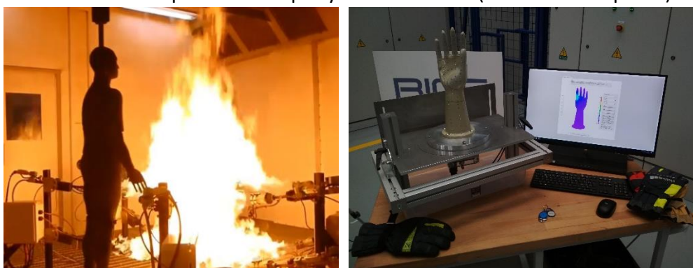
Obr. 105 – Vlevo: Manekýn Burnnie před průchodem plameny. Převzato z [291]. Vpravo: Speciální testovací ruka pro vývoj hasičských rukavic a testů odolnosti před radičním přenosem tepla. ZČU-RICE 2019. Zdroj archiv autora.
