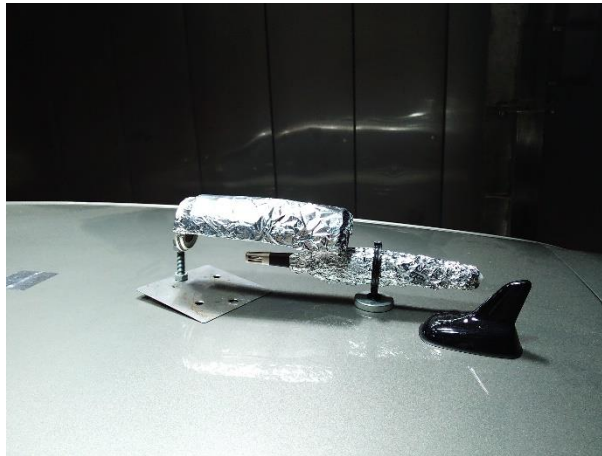
Obr. 69 – Dvakrát stíněný digitální teploměr kombinovaný s hygrometrem pro měření teploty a vlhkosti vzduchu nad střechou automobilu při měření tepelné zátěže kabiny automobilu v klimatické komoře FSI. Alobal pokrývající tělo sondy chrání elektroniku před intenzivní tepelnou zátěží od solárního záření. Zdroj archiv autora.
