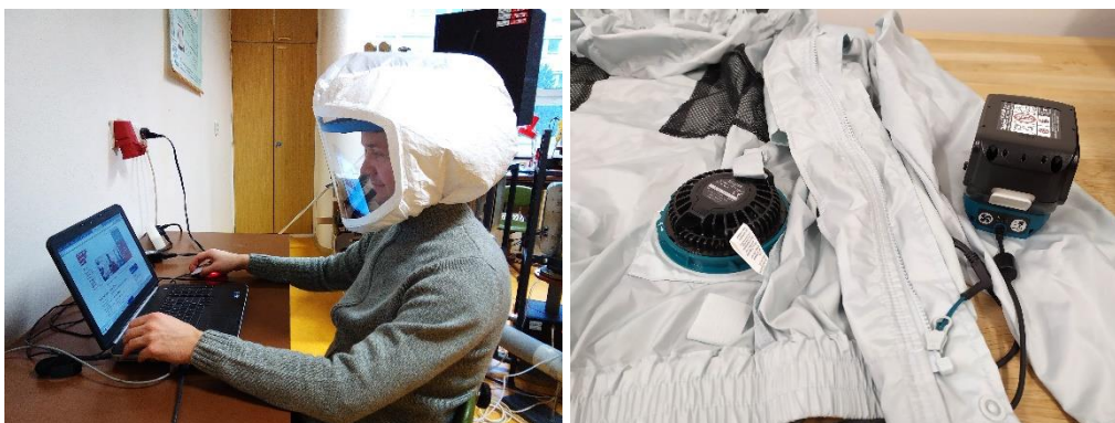
Obr. 67 – Vlevo: Testování ventilované kápě (s filtrem z nanovláken) určené do čistých prostor. Vpravo: Detail na pracovní bundu zn. Makita s vestavěnými ventilátory, akumulátorem a jednotkou pro regulaci ventilace. Zdroj archiv autora.
