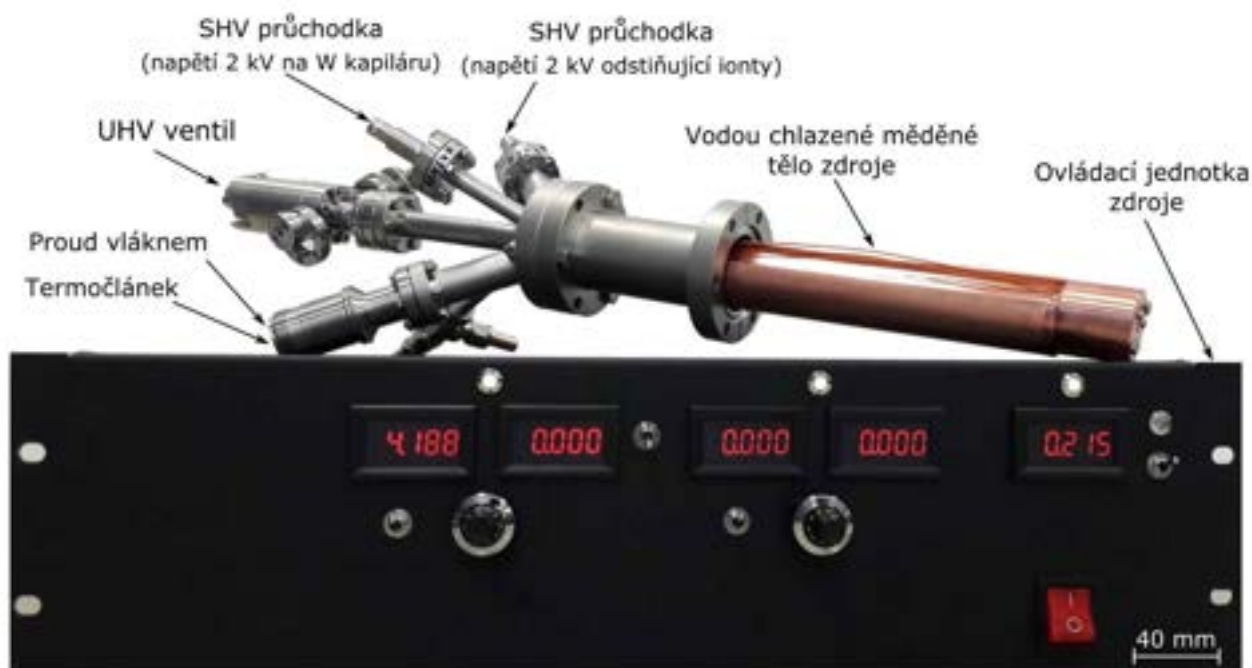
Obrázek 171: Fotografie realizovaného termálního disociačního zdroje atomů s elektronickou jednotkou. Zdroj je navržený pro přímé pozorování interakce atomů vodíku s materiály v rastrovacích elektronových mikroskopech (funkční vzorek VaV ID 154978).
