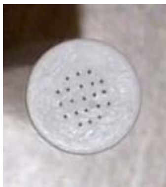
Obrázek 9: Multikolimátor z PBN vyrobený na ÚFI tvoří zaslepená trubička o průměru 10 mm, jejíž čelo je opatřeno 21 otvory o průměrech 0,1 mm.
