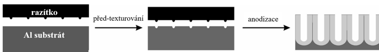
Obr. 6 Výroba ideálně uspořádaného anodického porézního oxidu hlinitého pomocí razítka. Převzato a upraveno podle [72].
