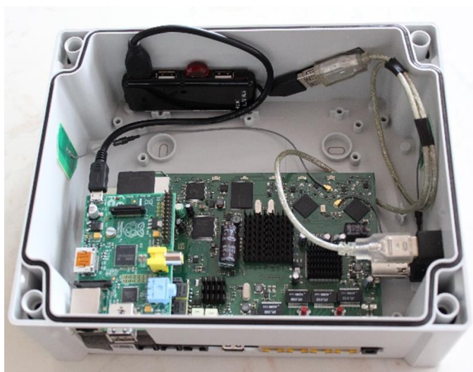
Obr. 5.2: Hardwarová realizace testovacího vzorku chytrého domácího serveru
