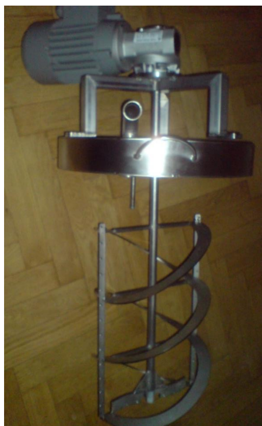
Obr 42. Schéma a fotografie poloprovozní verze dehydratačního zařízení a fotografie míchadla s motorovou částí a víkem.
