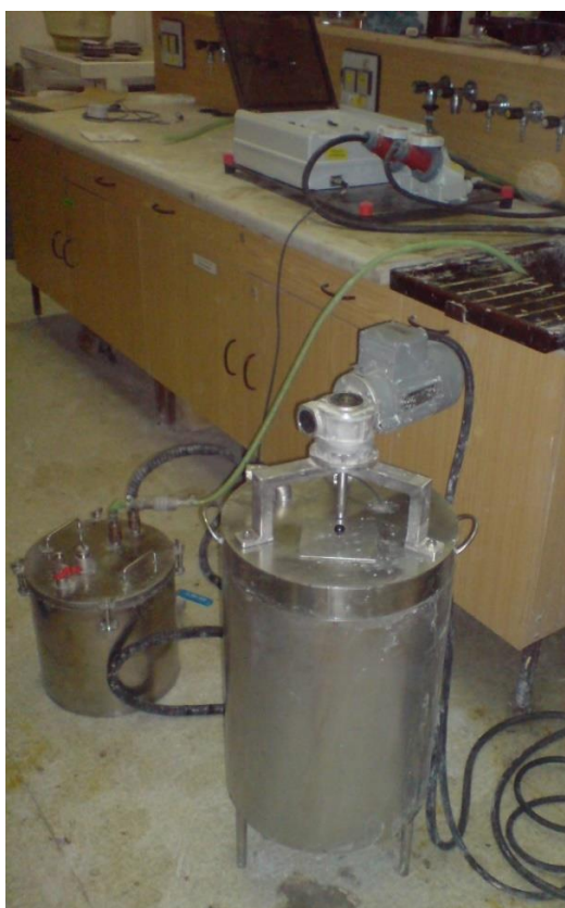
Obr 42. Schéma a fotografie poloprovozní verze dehydratačního zařízení a fotografie míchadla s motorovou částí a víkem.
