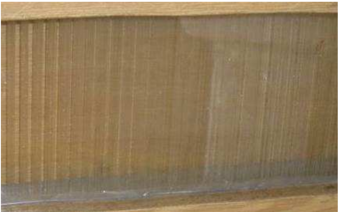
Obr. 6.31 Kondenzace na vláknech výměníku
