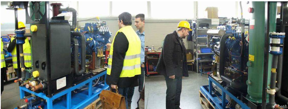
Obr. 5.14 Výroba prototypu jednotky GHP, detail motorového ústrojí
