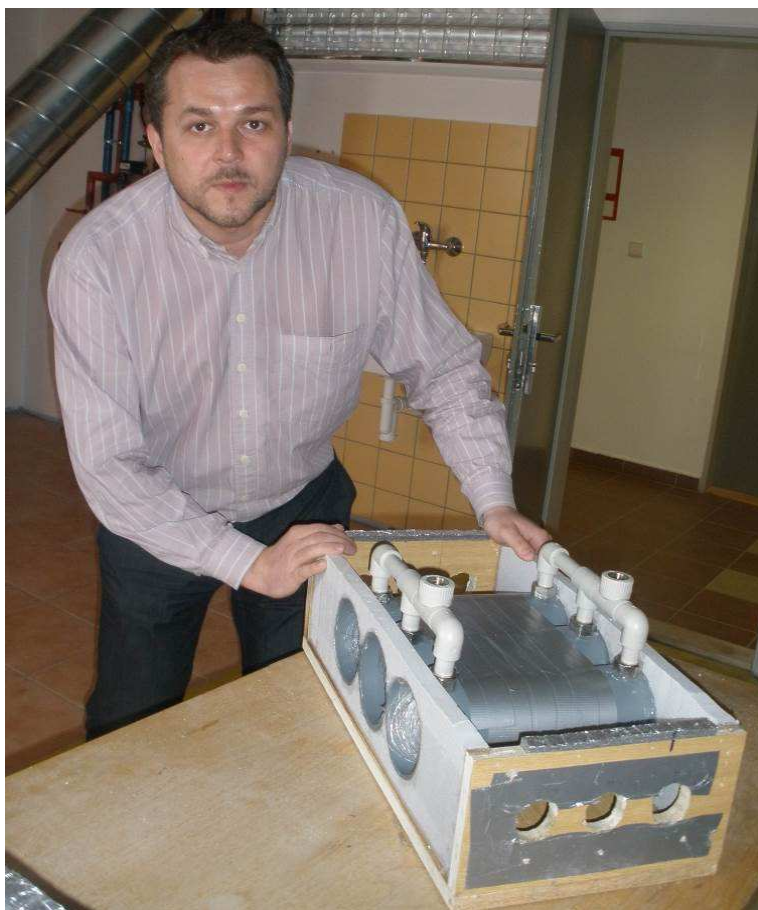
Obr. 6.19 Prototyp 3, vlásečnicový výměník v kruhovém potrubí
