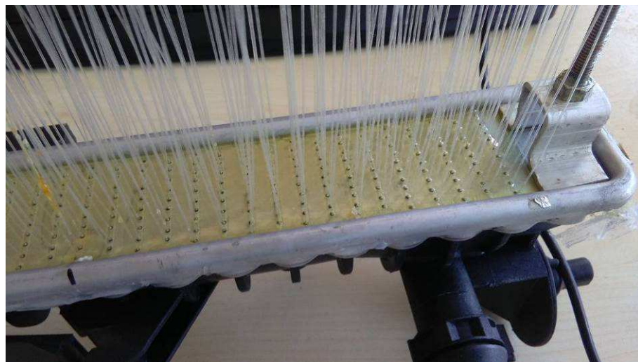
Obr. 6.28 Detail na uchycení vláken, VV prototyp 4
