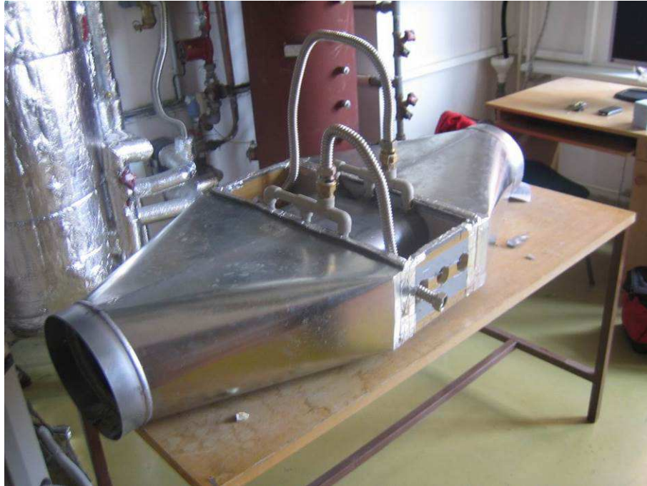
Obr. 6.21 Prototyp 3 s přechodovými kusy před instalací do měřicího okruhu
