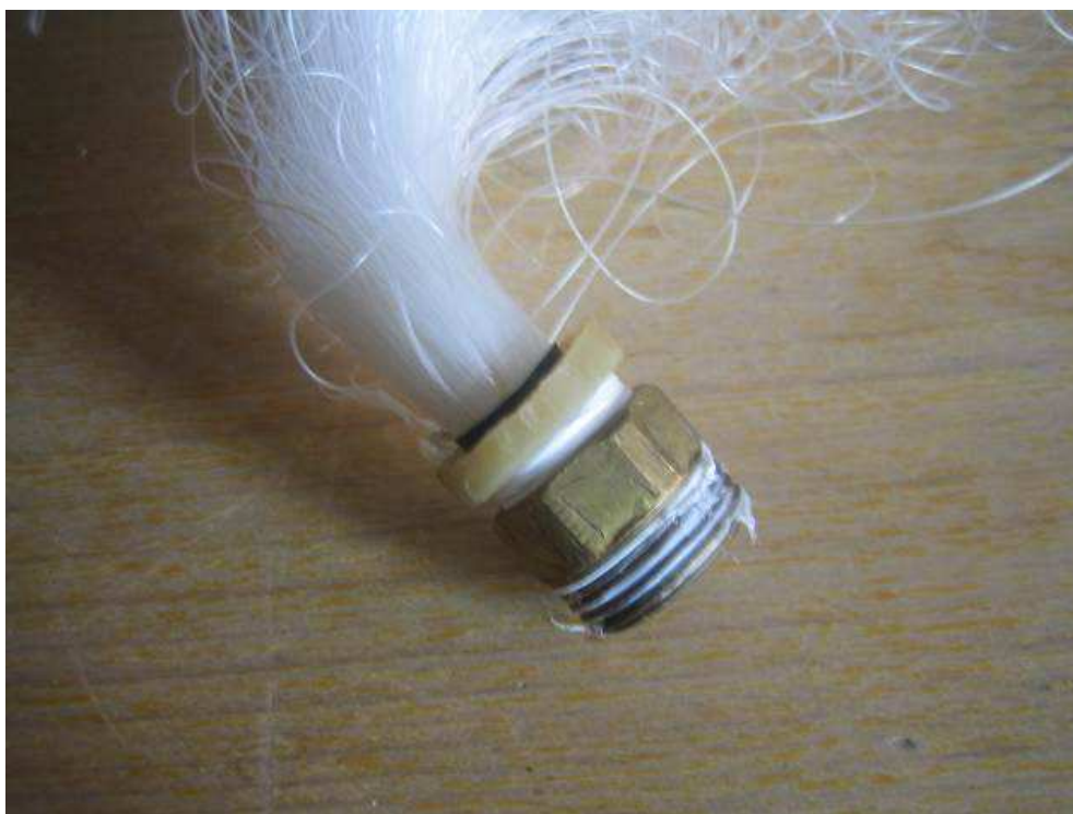
Obr. 6.2 Detail koncovky vlásečnicového výměníku
