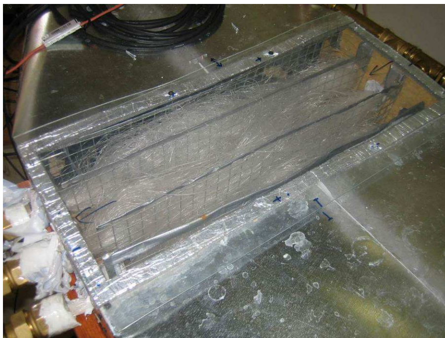
Obr. 6.16 Prototyp 2, vlásečnicový výměník s načebranými vlákny
