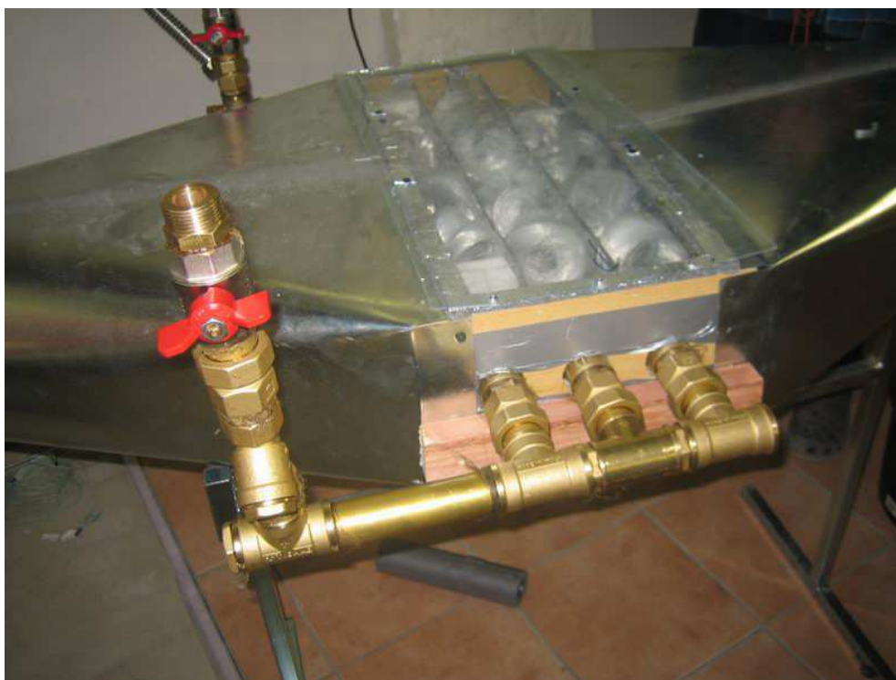
Obr. 6.10 Prototyp 1, vlásečnicový výměník, detail napojení
