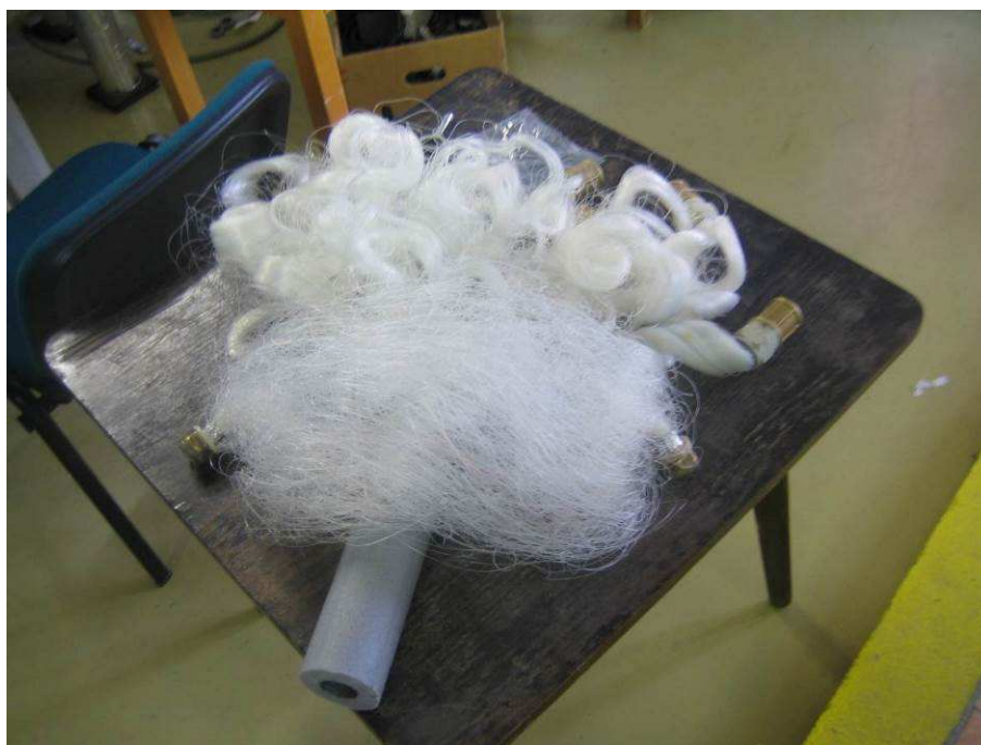
Obr. 6.15 Porovnání načechraných vláken (prototyp 2) a uhlazených vláken (prototyp 1)
