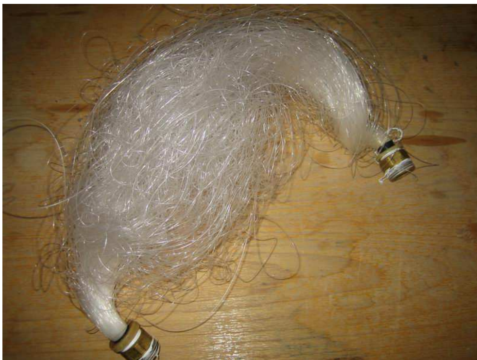
Obr. 6.1 Svazek vlásečnicového výměníku
