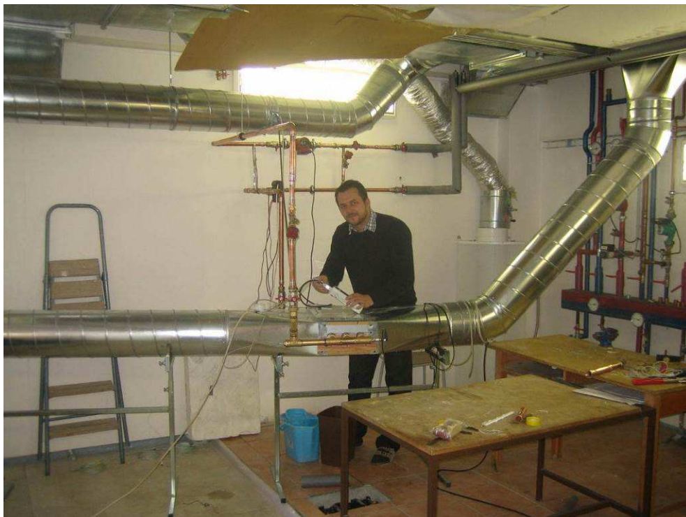
Obr. 6.4 Měřicí okruh pro vlásečnicové výměníky
