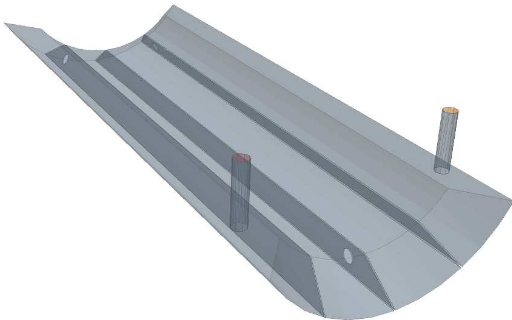
Obr. 4.1 Geometrie stokového výměníku do kruhového potrubí
