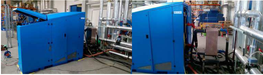
Obr. 5.15 Testování prototypu jednotky GHP, připojení na externí výměník
