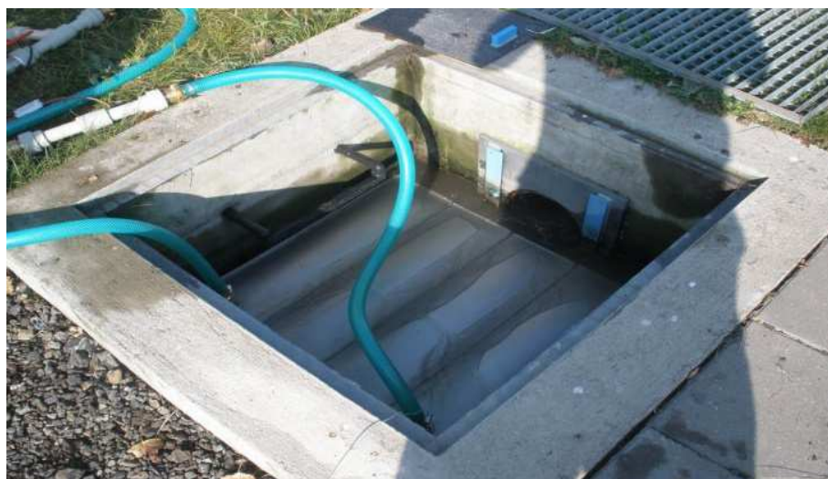
Obr. 4.5 Prototyp výměníku do šachty při měření [31]
