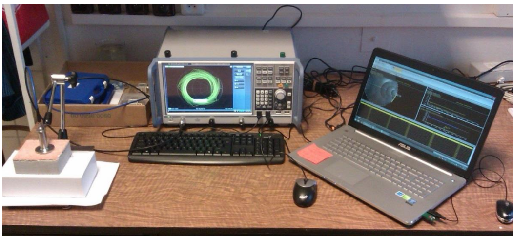
Obr. 5.2b Vyobrazení měřicího pracoviště: vektorový analyzátor ZNC od firmy Rohde Schwarz, sonda DAK-12 od firmy SPEAG [SPEAG], testovaný vzorek, osobní počítač vybavený měřícím softwarem.
