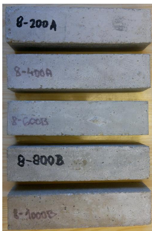
Obr. 9.1b Vyobrazení tepelně namáhaných vzorků betonu o velikostech 40x40x160 mm.
