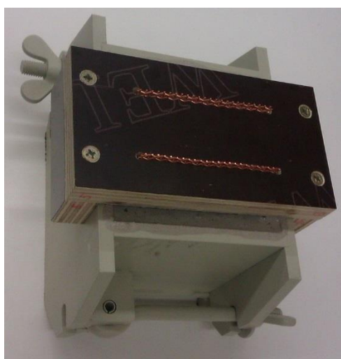
Obr. 13.1b Namíchaná směs ve formě se zapuštěnými elektrodami.
