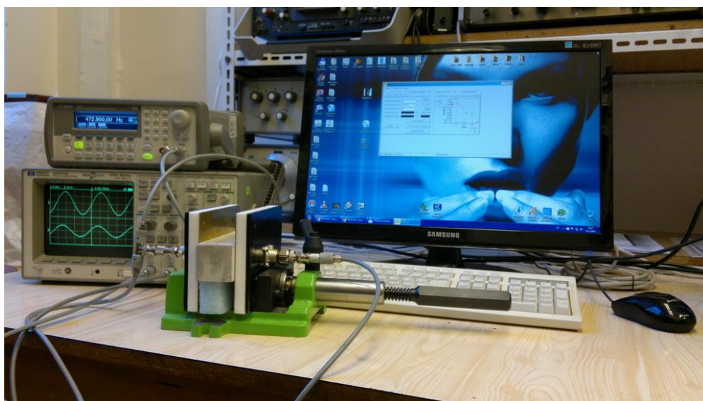
Obr. 5.1e Vyobrazení měřícího pracoviště: zdroj střídavého napětí (RC Generátor Agilent 33220A), dvoukanálový osciloskop, testovaný vzorek, osobní počítač vybavený měřícím softwarem.
