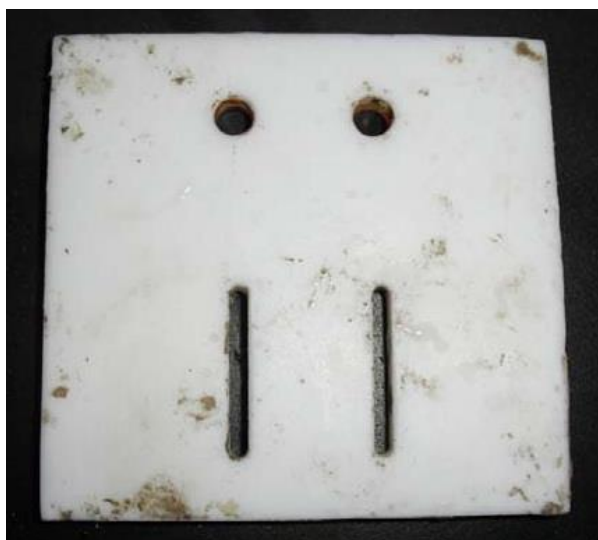
Obr. 7a Celkový vzhled přípravku na uchycení válcových a deskových elektrod vkládaných do čerstvého betonu.
