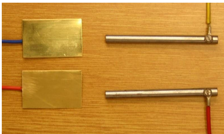
Obr. 7b Typy elektrod zapouštěných do betonu.
