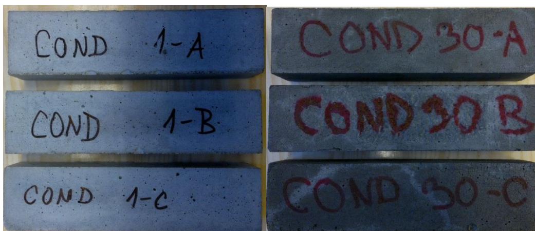
Obr. 11.1a Vyobrazení vzorků s přidavkem grafitu 1 % a 30 %. Velikost vzorků 40x40x160 mm.
