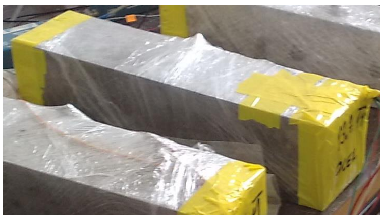
Obr. 8.1b Ilustrativní obrázek betonových těles hydratujících ve smršťovací fólii.
