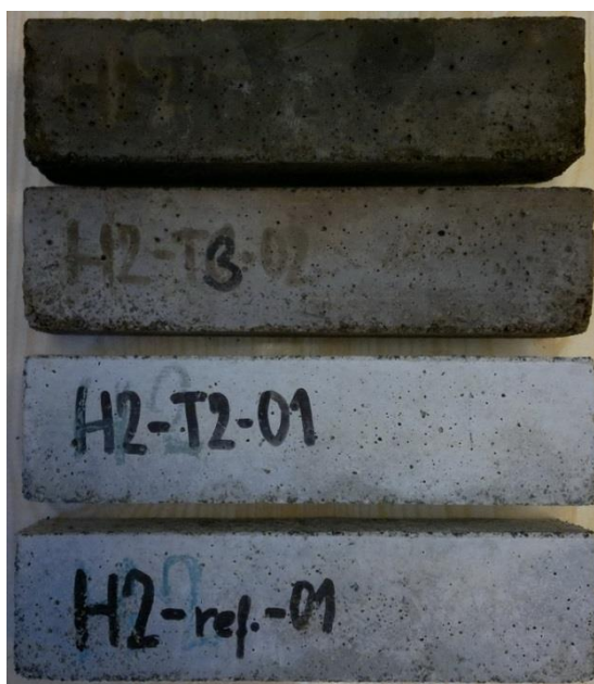
Obr. 10.1a Vyobrazení tepelně namáhaných vzorků betonu s pryžovým granulátem o velikostech 40x40x160 mm.
