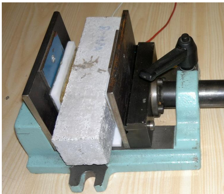
Obr. 9.1a Uchycení testovaného vzorku v přípravku mezi mosazné elektrody o ploše 7x3,5 cm.
