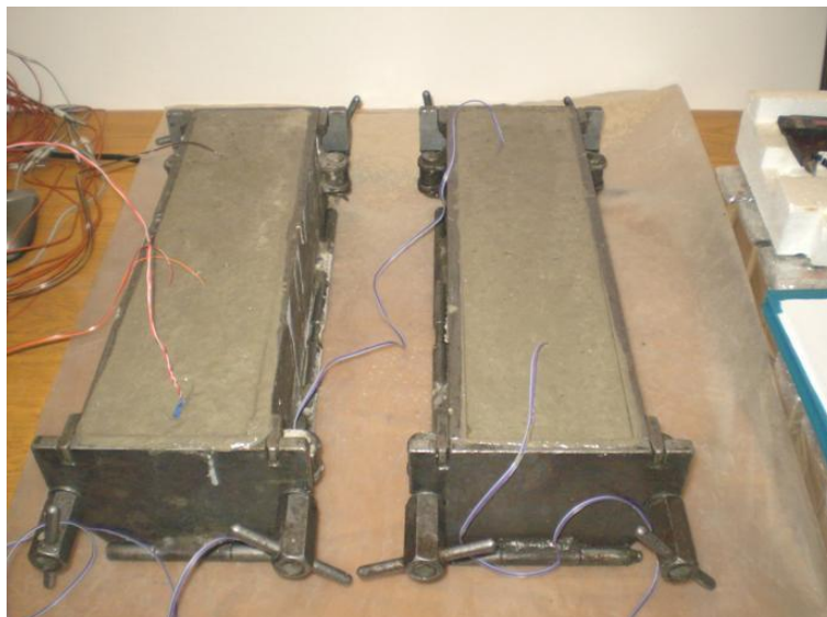
Obr. 8.1a Betonová tělesa těsně po nalití do ocelových forem.
