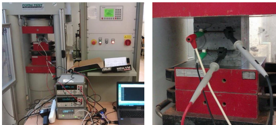
Obr. 13.1d Experimentální uspořádání při zkoušce senzoričských vlastností.
