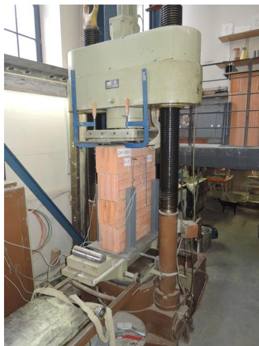
Obr. 21 Zkušební vzorek ZK1 -240 -1 a) připravený na osazení do lisu, b) osazený do zatěžovacího lisu.
