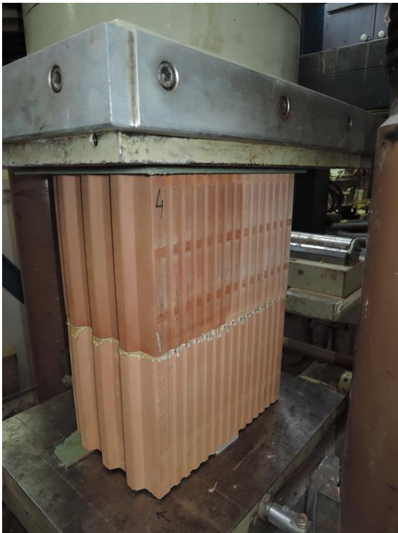
Obr. 114 Vzorek ZK6-240-4 před zkouškou.
