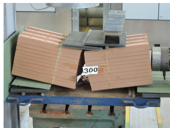
Obr. 88 Vzorek ZK4-300-5 po zkoušce, neplatná zkouška.
