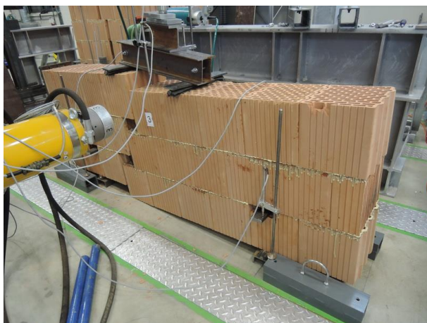
Obr. 102 Vzorek ZK5-300-3 po zkoušce.
