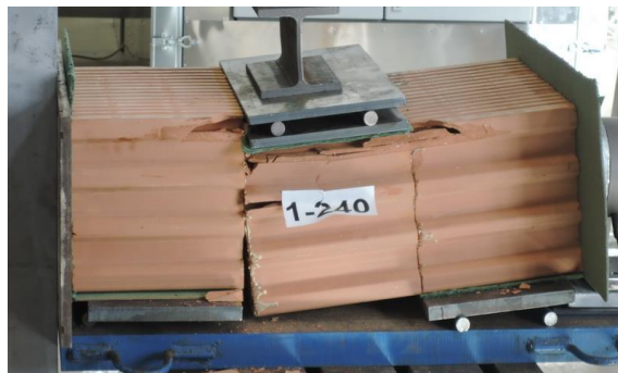
Obr. 62 Vzorek ZK4-240-1 po zkoušce.
