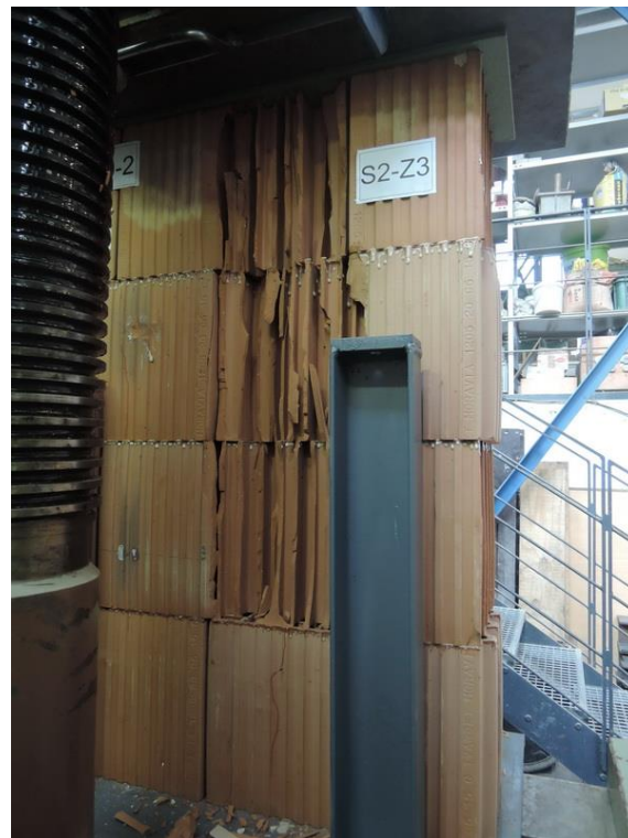
Obr. 24 Vzorek ZK1-240-2 po zkoušce.
