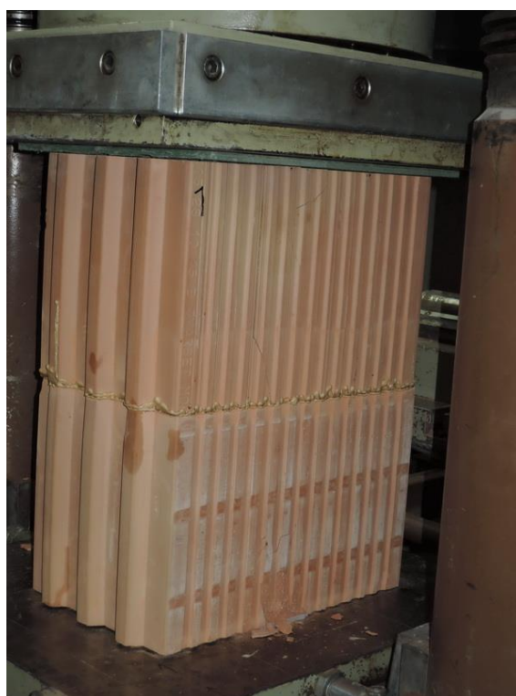
Obr. 109 Vzorek ZK6-240-1 po zkoušce.
