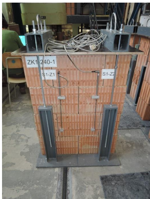
Obr. 21 Zkušební vzorek ZK1 -240 -1 a) připravený na osazení do lisu, b) osazený do zatěžovacího lisu.
