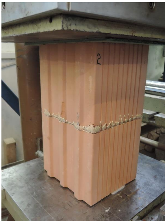
Obr. 128 Vzorek ZK6-300-2 před zkouškou.
