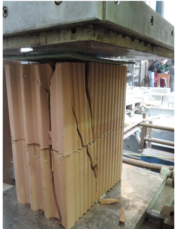
Obr. 113 Vzorek ZK6-240-3 po zkoušce.
