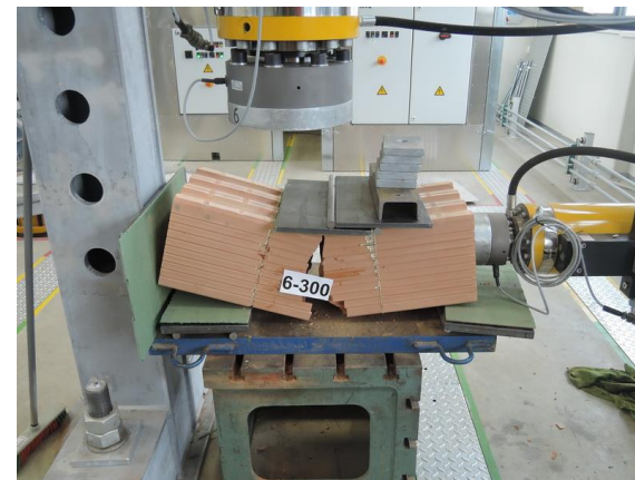
Obr. 90 Vzorek ZK4-300-6 po zkoušce, neplatná zkouška.
