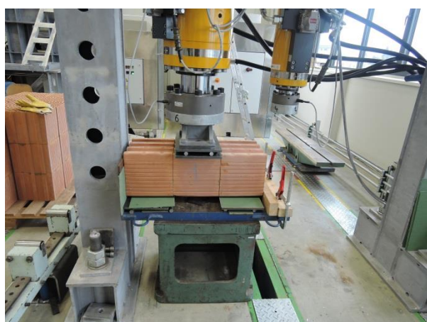
Obr. 160 Zatěžovací zkouška pro stanovení počáteční pevnosti zkušebních vzorků ve smyku.
