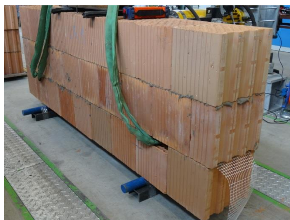
Obr. 161 Zatěžovací zkouška pro stanovení únosnosti ve vlastní rovině zkušebních vzorků s vyztužnou tkaninou.
