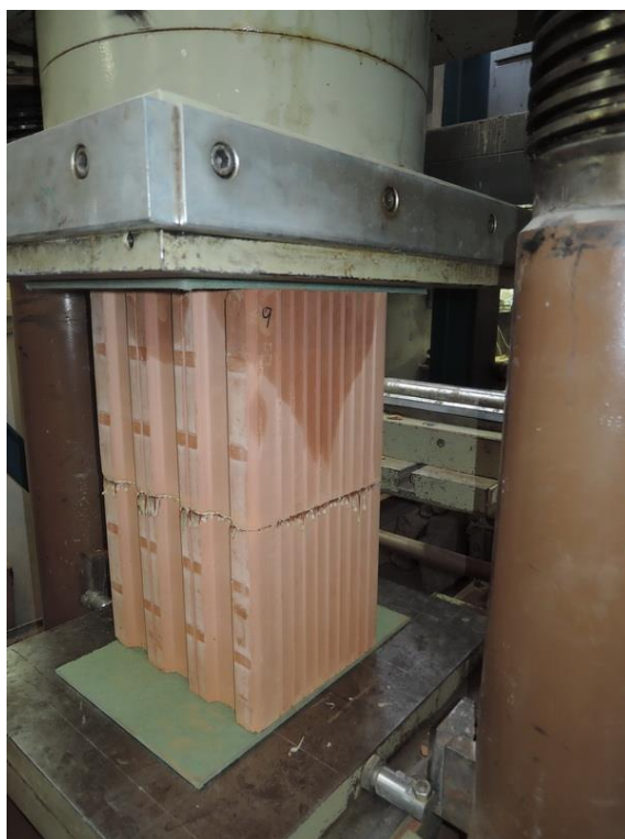
Obr. 142 Vzorek ZK6-300-9 před zkouškou.
