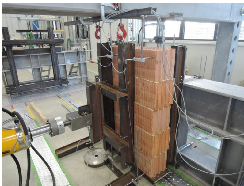
Obr. 31 Uspořádání zkoušky pro stanovení pevnosti zdiva v ohybu v rovině porušení kolmé na ložné spáry.
