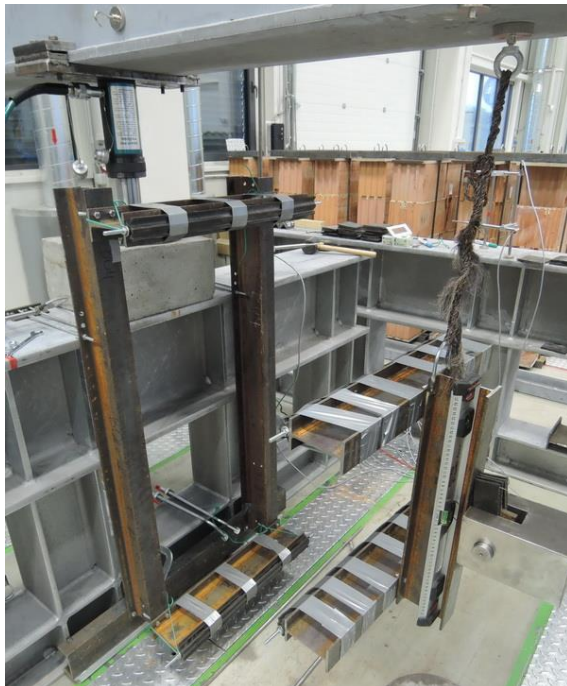
Obr. 45 Zkušební sestava pro zkoušky pevnosti zdiva v tahu za ohybu při porušení v rovině rovnoběžné s ložnými spárami.
