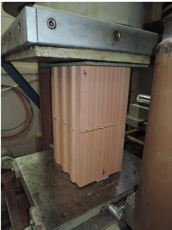
Obr. 132 Vzorek ZK6-300-4 před zkouškou.
