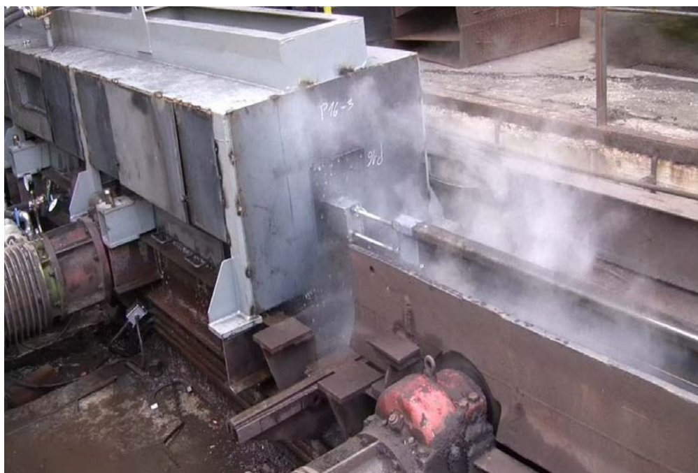
Obr. 47 Segment vyjždějí z chladicí sekce.
