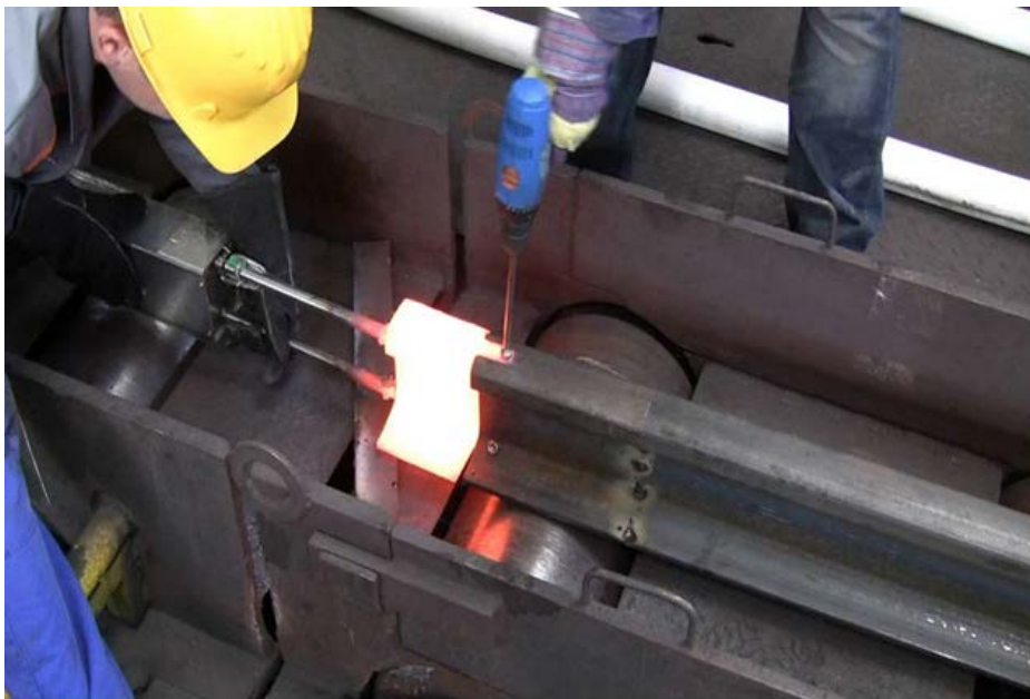
Obr. 46 Segment osazený termočlánky napojenými do datalogeru. Začátek měření.
