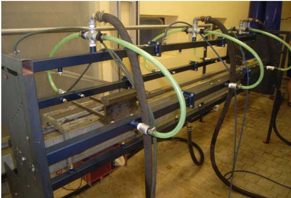
Obr. 39 Experimentální ostřiková sekce nabudovaná na lineárním zařízení
