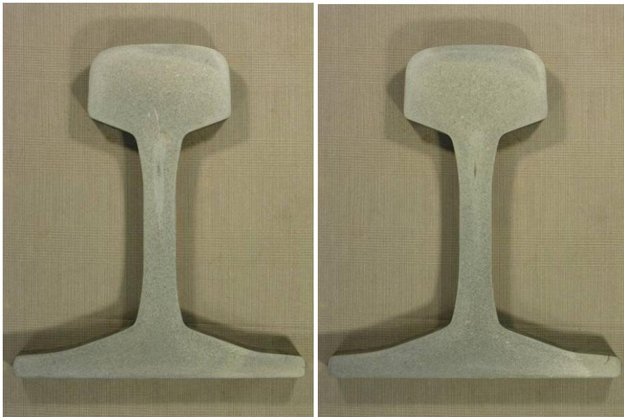
Obr. 52 Vlevo kolejnice A. Vpravo kolejnice B. – vzorky 250 mm ohříváné v peci. Upravená chladicí sekce s tolerancí vedení +/-15 mm
