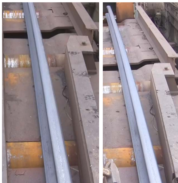
Obr. 53 Konečný tvar kolejnice po průjezdu chladicí sekcí. Zkouška č. 3 (R260) – vlevo. Zkouška č. 4 (R260) – vpravo. Tolerance vedení kolejnice ( \pm 15 mm), rovnoměrným průjezdem chladicí sekcí.
