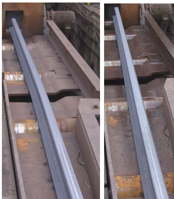
Obr. 54 Konečný tvar kolejnice po průjezdu chladicí sekcí. Zkouška č. 2 (AREMA25Cr) – vlevo. Zkouška č. 3 (AREMA25Cr) – vpravo. Tolerance vedení kolejnice ( \pm 15 mm), rovnoměrným průjezdem chladicí sekcí.
