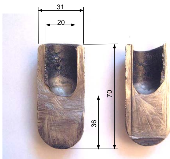
Obr. 26 Řez U-trubicí. Teplota 1420 °C (58% solidu), rychlost 0,5 cm/min.
