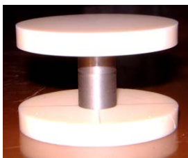
a) Zkušební vzorek mezi korundovmi disky.
