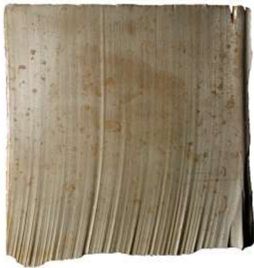
Obr. 2-5 Kvalita řezu provedeného abrazivním vodním paprskem (Autor obrázku: Ing. Libor Sitek, Ph.D.)
