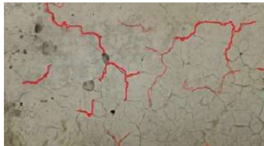
Obr. 10-10 Beton R2-BL-I-F (CEM I 42,5 R, 1kg/m 3 PP, čedič Bílčice) po zatížení na 850 °C, trhlinky na povrchu vzorku jsou zvýrazněny červeně, šířka trhlin 0,1-0,2 mm
