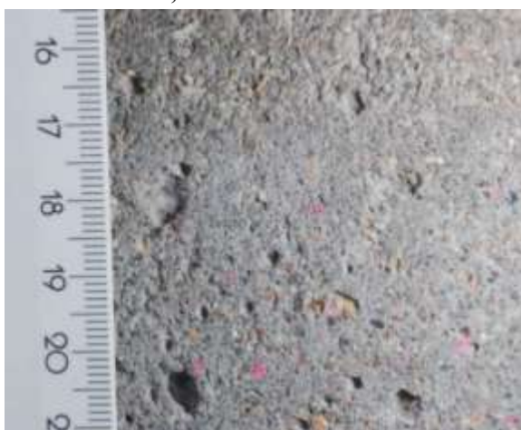
Obr. 7-8 Beton C 50/60, přechod mezi neotryskaným povrchem betonu (dole) a otryskaným povrchem betonu (nahore), tlak 130 MPa, měřítko v cm
