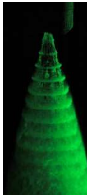
Obr. 2-10 Pulzující vodní paprsek – fotografováno digitální kamerou, osvětlení pulzujícím laserem (Autor fotografie Ing. Josef Foldyna, CSc.) [38]
