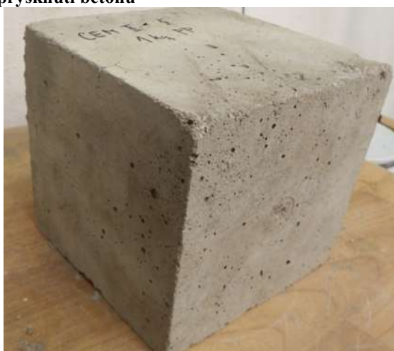
Obr. 10-13 Beton R11-OL-I-F (CEM I 42,5 R, kamenivo biotický granodiorit Olbramovice, 1kg/m 3 PP) po zatížení na 850 °C
