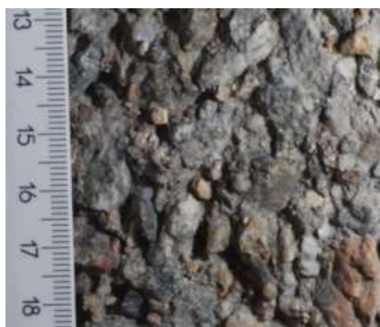
Obr. 7-7 Beton C 40/50, otryskaný povrch betonu, tlak 210 MPa, měřítko v cm
