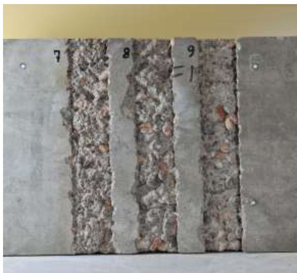
R11-OL-I-F-CEM I (Mokrý), 1 kg PP, biotický granodiorit, po tepelném zatížení
