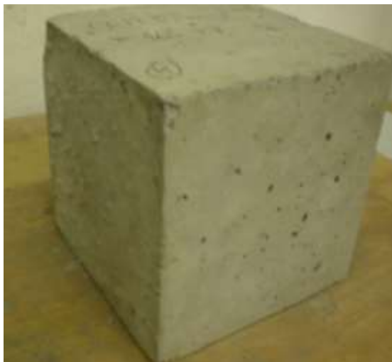
Obr. 10-9 Beton R2-BL-I-F (CEM I 42,5 R, 1kg/m 3 PP, kamenivo čedič Bílčice) po zatížení na 850 °C
