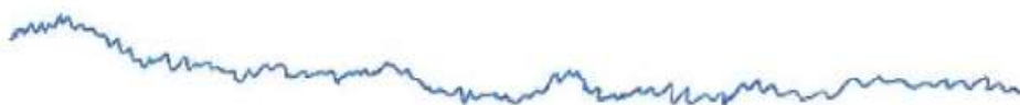
Profil povrchu betonu ošetřeného pneumatickým kladivem a následně otryskaný abrazivním vysokorychlostním paprskem
