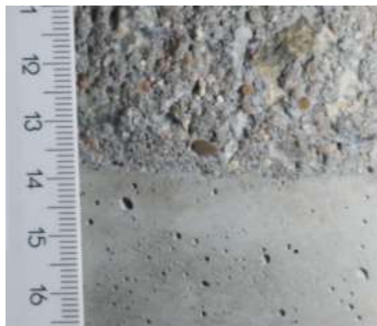
Obr. 7-9 Beton C 50/60, přechod mezi neošetřeným povrchem betonu (dole) a otryskaným povrchem betonu (nahore), tlak 20 MPa, měřítko v cm
