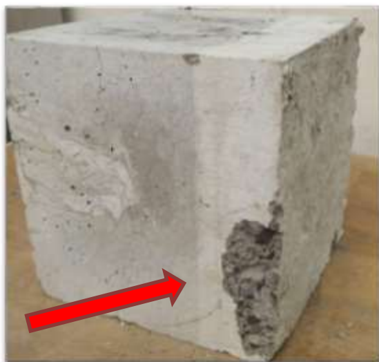
Obr. 10-7 Beton R1-BL-I (CEM I 42,5 R, kamenivo čedič Bílčice) po zatížení na 850 °C, červená šipka ukazuje odštěpování betonu
