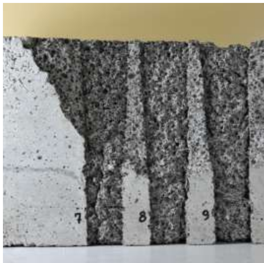
L-II CEM II/B-M (S-LL) 32,5 R (Mokrý), lehké kamenivo Liapor, po tepelném zatížení
