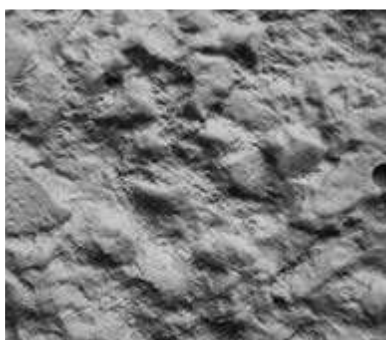
CSP10 – odstraňování ručními nástroji – pneumatická kladiva, odsekávání a následné otryskávání (handheld concrete breaker followed by abrasive blasting)
