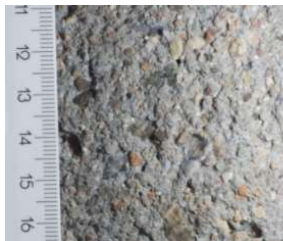
Obr. 7-9 Beton C 50/60, přechod mezi neošetřeným povrchem betonu (dole) a otryskaným povrchem betonu (nahore), tlak 20 MPa, měřítko v cm
