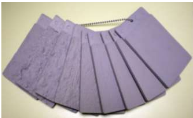
Obr. 4-7 Vzorník povrchů profilů betonu – repliky povrchů betonů [62]
