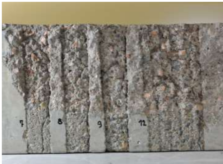
R7-OL-I - CEM I 42,5 R (Mokrý), biotický granodiorit, po tepelném zatížení
