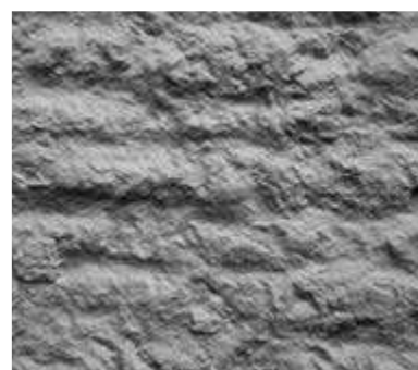
CSP9 – drážkování rotačními nástroji (heavy scarification – rotomilled)
