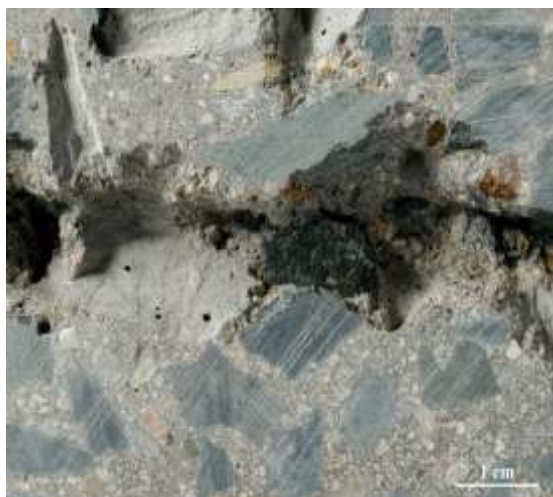
Obr. 8-7 Drážka po rozpojování betonu třídy C25/30. Vysokorychlostní vodní paprsek kontinuální pulzující. Tlak vody 40 MPa, průměr vodní trysky 1,98 mm, rychlost řezání 5 m.min -1 . Průměrná hloubka řezu 9,6 mm. [14]
