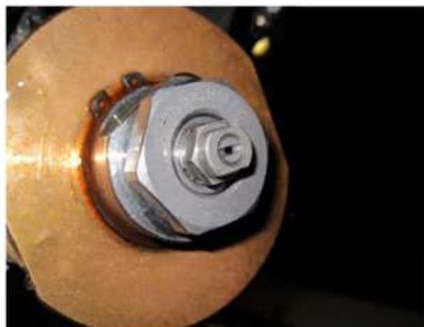
Obr. 8-2 Upevnění ploché trysky firmy Lechler 1508 k ramenu robota ABB
