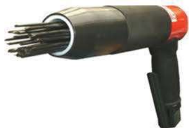
CSP4 – kartáčování, drážkování, otryskávání jehlami (light scarification)
