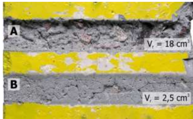
Obr. 8-13 Drážky vytvořené plochým pulzujícím (A) a plochým kontinuálním paprskem (B) ve vzorku betonu C 45/55 XF4. Jeden průchod. ( V_r – rozpojený objem, tlak vody 30 MPa, ekvivalentní průměr trysky 2,05 mm, vzdálenost vzorku od trysky 40 mm, rychlost řezání 0,2 m.min -1 )
