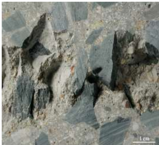
Obr. 8-6 Drážka po rozpojování betonu třídy C25/30. Vysokorychlostní vodní paprsek kontinuální. Tlak vody 40 MPa, průměr vodní trysky 1,98 mm, rychlost řezání 5 m.min -1 . Průměrná hloubka řezu 6,3 mm. [14]
