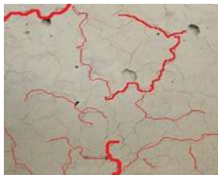
Obr. 10-12 Beton R7-OL-I (CEM I 42,5 R, kamenivo biotický granodiorit Olbramovice) po zatížení na 850 °C, trhlinky na povrchu vzorku jsou zvýrazněny červeně, šířka trhlin 0,1-0,5 mm
