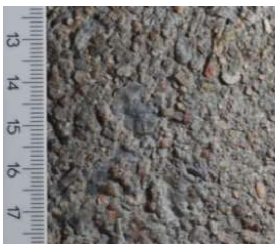
Obr. 7-6 Beton C 40/50, otryskaný povrch betonu, tlak 130 MPa, měřítko v cm
