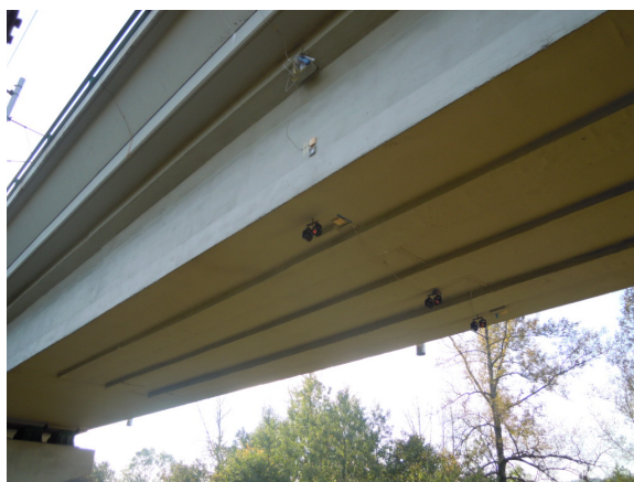
Obr. 140 - Pole 2 - umístění teplotních čidel v řezu
