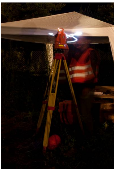
Obr. 132 - Měřící stanice Geodimeter 630 pro přesnou trigonometrii
