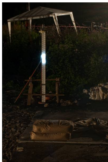
Obr. 133 - Měřící invarová lať na bodě vztažné soustavy
