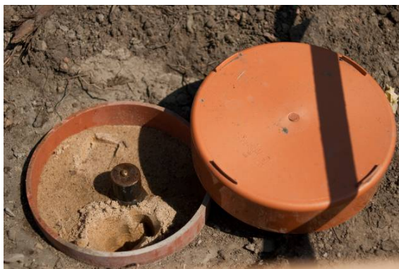
Obr. 126 - Stabilizovaný bod vztažné soustavy pro geodetická měření - mikropilota
