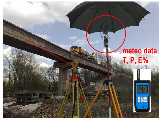
Obr. 96 - Elektronická stanice Topcon GTS-300 a datalogger meteorologických dat
