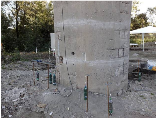
Obr. 128 - Soustava měřících strun pro měření stlačení ložisek velmi přesnou nivelací
