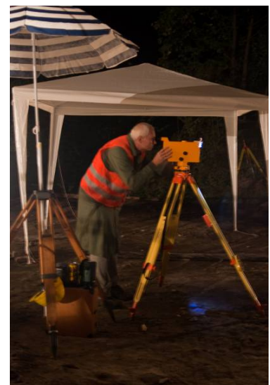
Obr. 134 - Měření velmi přesnou nivelací s přístrojem Zeiss NI 002
