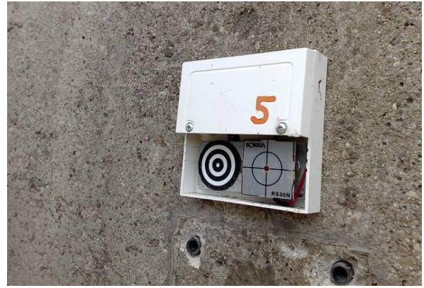
Obr. 129 - Detail měřické značky pro přesné trigonometrické měření - světelný bod
