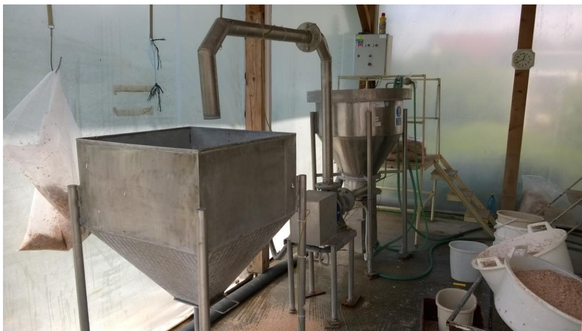
Obr. 4.12 Technologická linka určená pro praní vaječných skořápek
