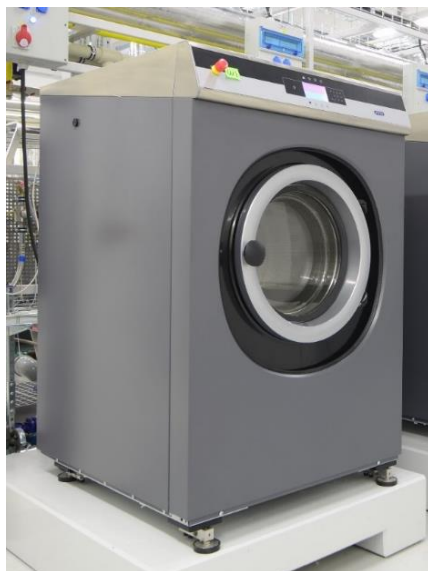
Obr. P1.5 Vsádková pračka PRIMUS FX 24 s kapacitou 24 kg suchého prádla
