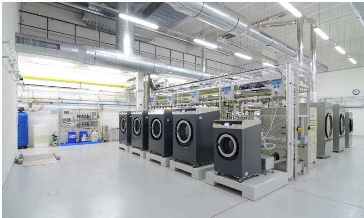
Obr. P4.1 Experimentální infrastruktura s modelem průmyslové prádelny v hlavní hale Laboratoře energeticky náročných procesů, NETME Centre
