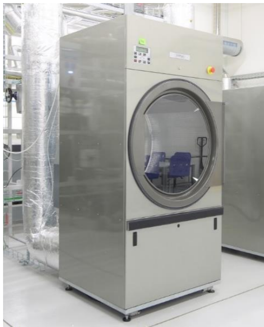
Obr. P1.7 Sušič PRIMUS T 24 s kapacitou 24 kg suchého prádla
