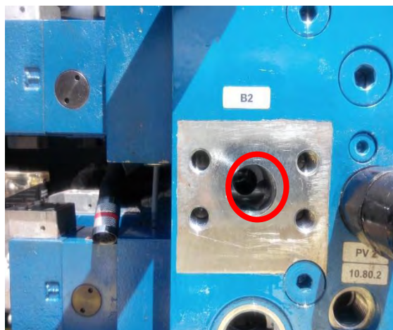
Obr. 82 Fotografie chybně provedeného vrtání hydraulického kanálu v prvním prototypu ventilového bloku
