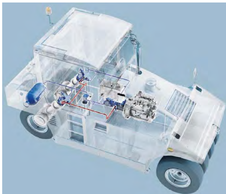
Obr. 19 Pneumatikový válec s paralelním rekuperačním modulem Hydraulic flywheel [28]
