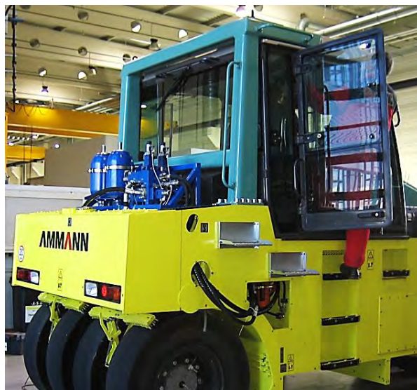
Obr. 80 Prototyp první verze rekuperačního modulu na vozidle s tlakovými zásobníky o objemu 10 l [38]
