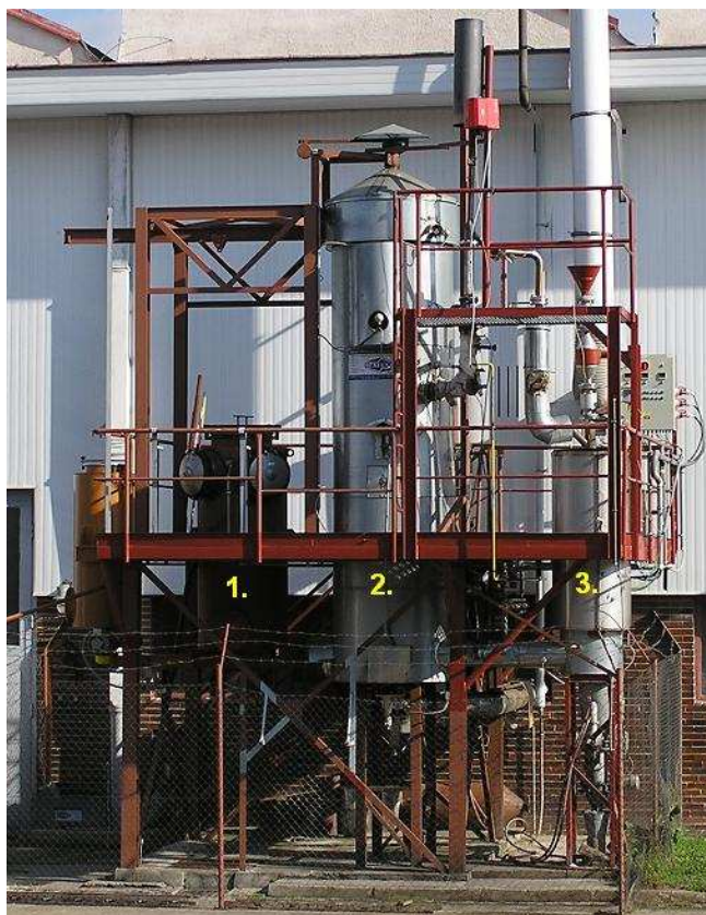
Obr. 94 Zařízení Biofluid 100 – 1–zásobník paliva, 2–zplyňovací reaktor, 3–horký filtr
