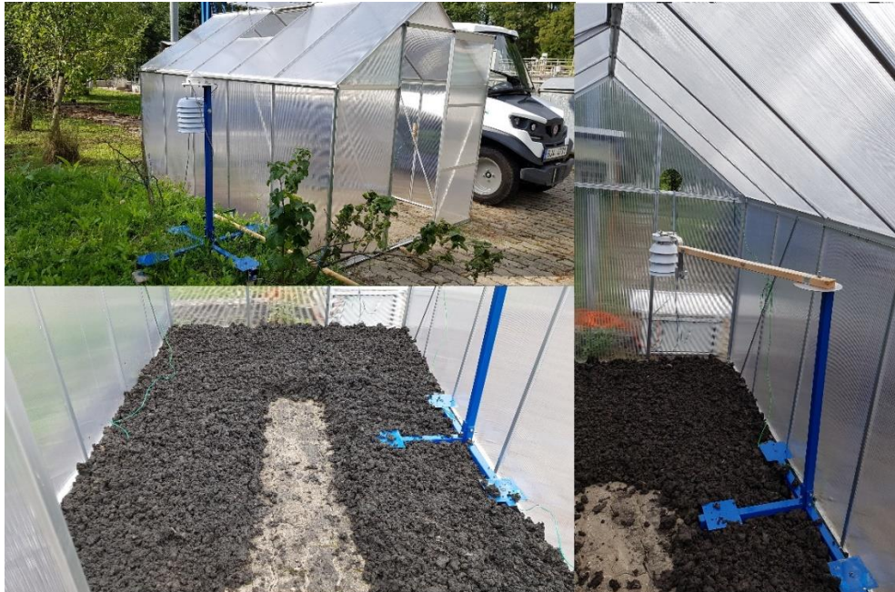
Obr. 5 Pohled na pilotní instalaci solární sušárny ČK ve městě Třešť, venkovní a vnitřní pohled na prostor měřeného skleníku s rozmístěním instalovaných měřících bodů (teploty, vlhkost, intenzita slunečního záření) (Hlavínek et al., 2019)
