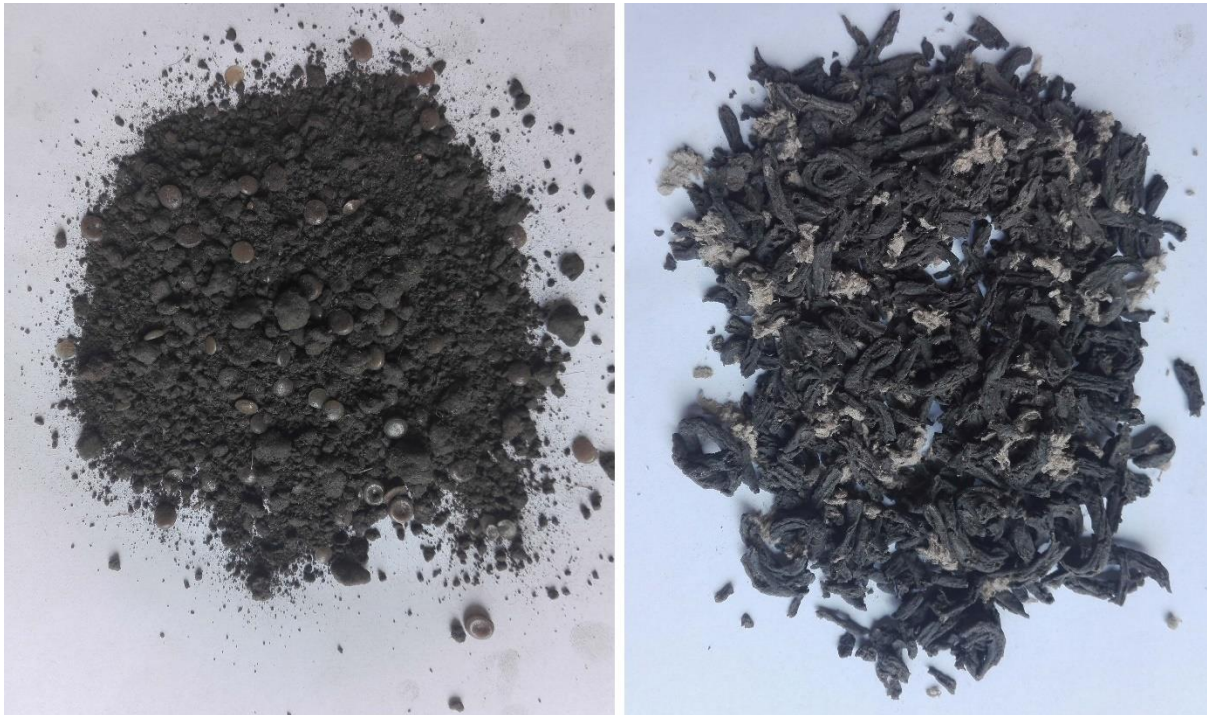
Obr. 8 Příklad směsi „mixu“ sušeného ČK s organickou přísadou před peletizací (vlevo: s plastovým odpadem LDPE, vpravo: s celulózu) (Raček et al., 2022)
