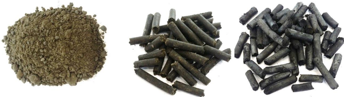
Obr. 15 Sušený ČK prachovité konzistence (vlevo), ČK zpracovaný do podoby pelet jako vstupní materiál do pyrolýzy (uprostřed) a SCP / biochar po pyrolýze (vpravo)
