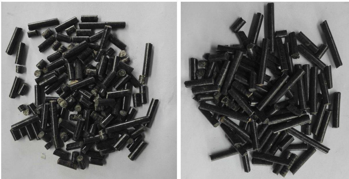
Obr. 9 Příklad peletizovaného ČK s organickou přísadou a katalyzátorem před mikrovlnnou pyrolýzou (vlevo: s dřevěnými pilinami, vpravo: s drceným vápencem) (Raček et al., 2022)
