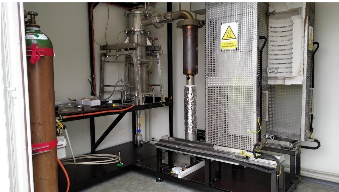
Obr. 13 Malá jednotka středněteplotní termické pyrolýzy (TP1) s maximální kapacitou 3 kg-pokus -1 instalována a provozována na AdMaS VUT v Brně
