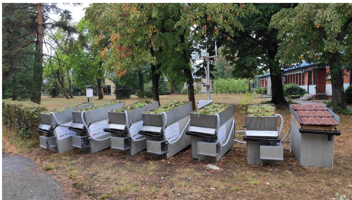
Obr. 28 Fotografie pořízená v srpnu 2022 při dokončení testovacích modulů zelených střech v areálu Univerzity Banja Luka
