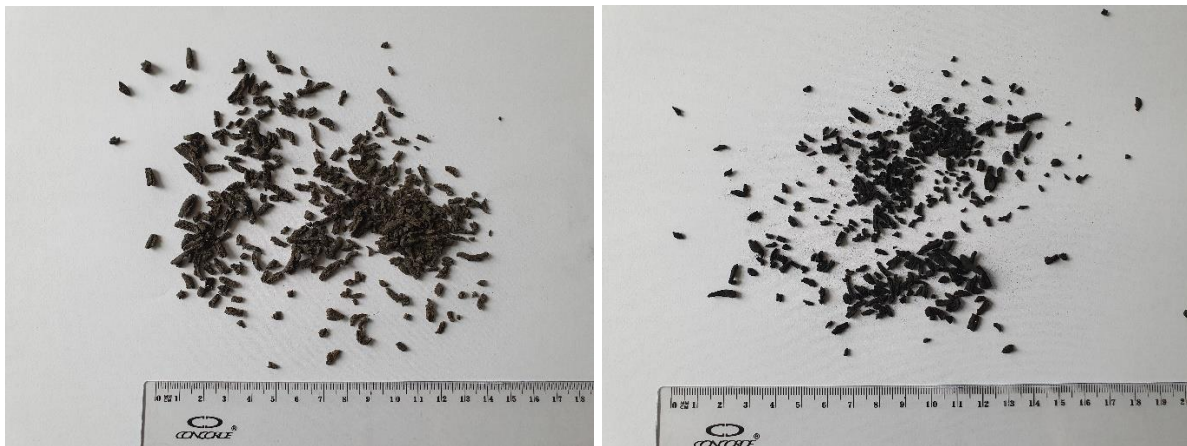
Obr. 19 Sušený ČK nudlovitého tvaru z komunální ČOV6 před procesem pyrolýzy (vlevo), SCP / biochar po středněteplotní pyrolýze průmyslovou jednotkou TP3 (vpravo) (Hlavínek et al., 2022)
