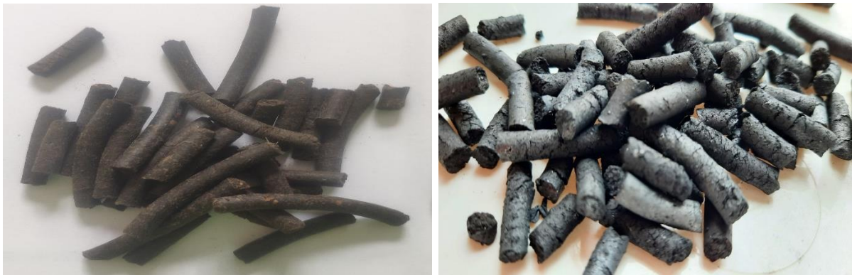
Obr. 10 Příklad peletizovaného ČK se sušeným gastro odpadem v poměru 50:50 (vlevo: vstupní peletizovaná surovina, vpravo: SCP / biochar po procesu středněteplotní pyrolýzy) (Hlavínek et al., 2021)
