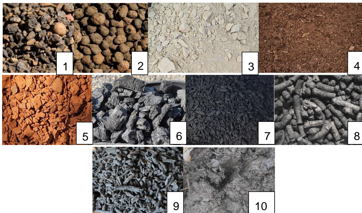
Obr. 27 Ukázka materiálů použitých v substrátech pro zelené střechy (1: keramzit frakce 4/8 mm, 2: keramzit frakce 8/16 mm, 3: drcená opuka frakce 0/12 mm, 4: rašelina, 5: cihelná drť frakce 4/8 mm, 6: biochar ze dřeva, 7: biochar z ČK, 8: biochar z gastro odpadu, 9: sušený ČK, 10: kompost s ČK) (Novotný et al., 2022)
