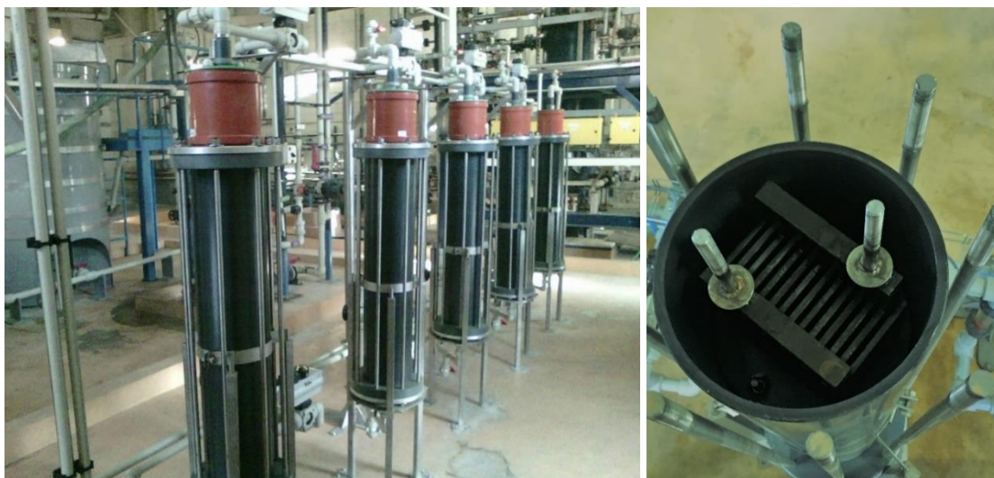
Obr. 26 Vlevo – provozní linka elektrokoagulace; Vpravo – detail na umístění elektrodové kazety (dle komentované položky 15). Vlastní foto.
