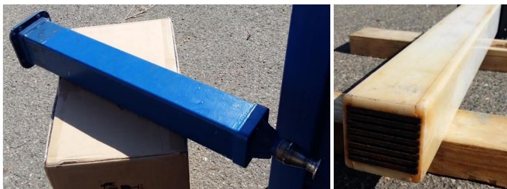
Obr. 21 3D tištěná elektrokoagulační cela v pilotní jednotce. Vlevo – vnější plášť; vpravo – detail (dle komentovaných položek 12 a 13). Vlastní foto.
