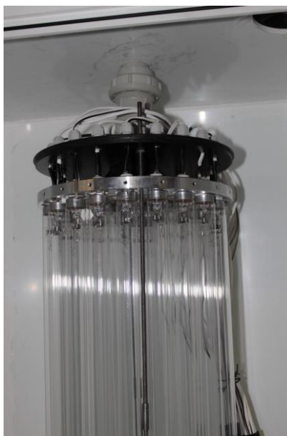
Obr. 8 Detail reaktorové části jednotky RECHEBA-L (dle komentované položky 5 a 6). Průměr křemenné trubice je 153 mm. Vlastní foto.
