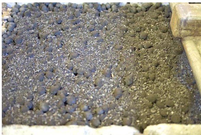
Obrázek 154 Čerstvá vsázka se zapalovací vrstvou
