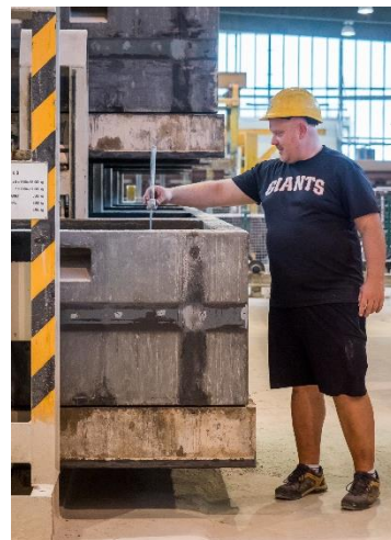
Obrázek 81 Měření teploty pórobetonové hmoty na zracím poli
