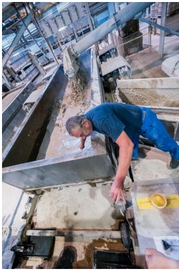
Obrázek 78 Lití směsi do formy a odběr vzorku pro stanovení rozlití
