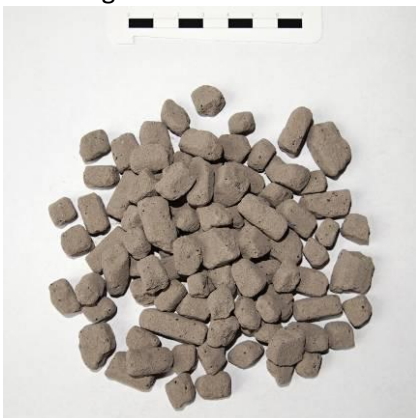
Obrázek 14 Nevypálená zrna z válců
