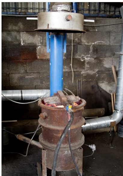
Obrázek 21 Technologická pec pro samovýpal kameniva
