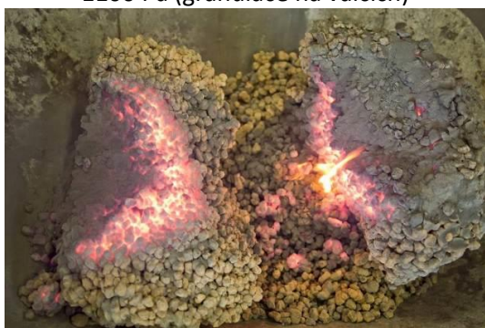
Obrázek 137 Výrazné snížení prodyšnosti vsázky a nevypálení středu při granulaci na válcích
