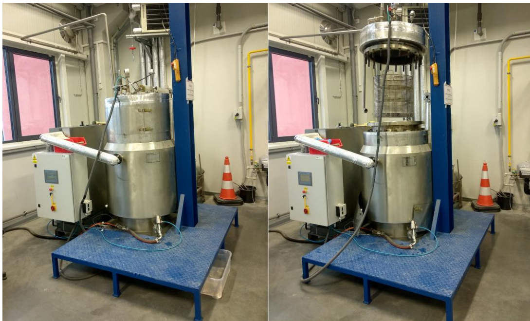
Obrázek 11 Fotografie laboratorního autoklávu
