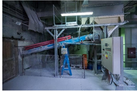
Obrázek 77 Druhý stupeň drcení pórobetonové hmoty
