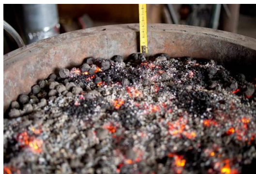
Obrázek 136 Propad vsázky při podtlaku 1100 Pa (granulace na talíři)
