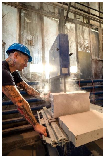
Obrázek 88 Řezání výrobku na zkušební tělesa
