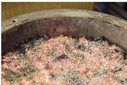
Obrázek 135 Propad vsázky při podtlaku 1100 Pa (granulace na válcích)
