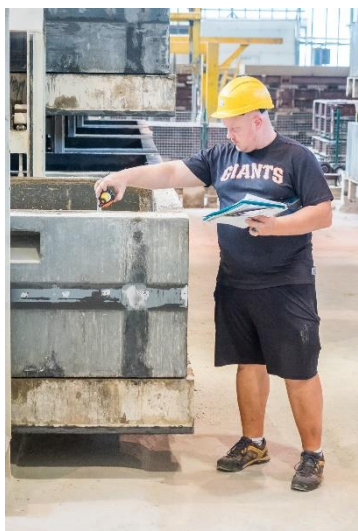
Obrázek 82 Měření nárůstu pórobetonové hmoty na zracím poli
