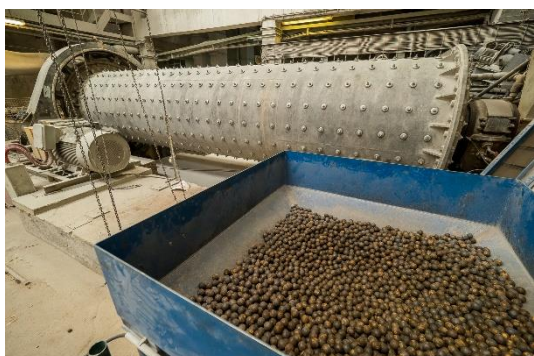
Obrázek 73 Mletí písku na požadovaný měrný povrch
