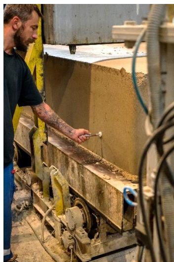
Obrázek 83 Měření plastické pevnosti pórobetonové hmoty
