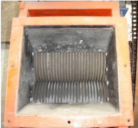
Obrázek 12 Pohled do násypky granulačních válců
