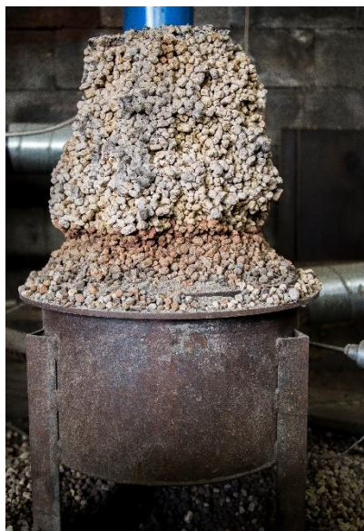
Obrázek 21 Technologická pec pro samovýpal kameniva
