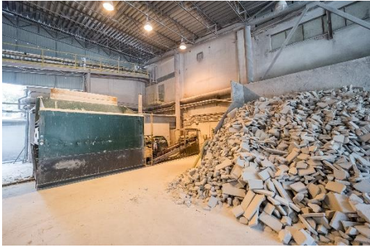
Obrázek 77 Druhý stupeň drcení pórobetonové hmoty
