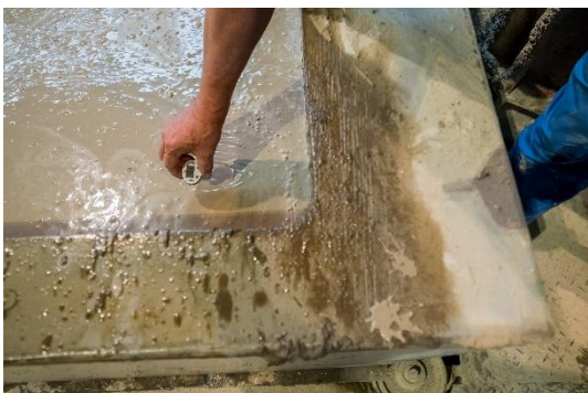
Obrázek 80 Měření teploty odlevu
