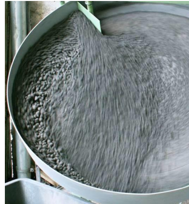
Obrázek 13 Vytváření pelet na granulačním talíři
