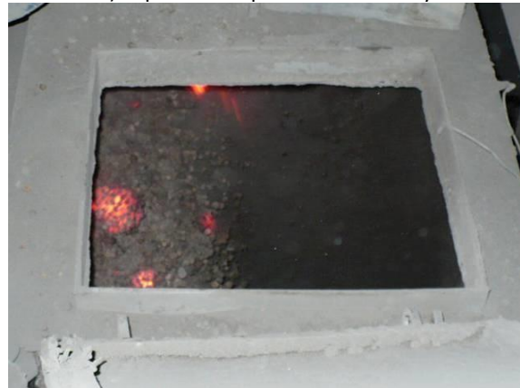
d) Vypadávání vypálené vsázky k drcení a třídění
