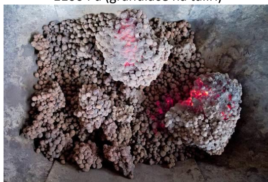
Obrázek 136 Propad vsázky při podtlaku 1100 Pa (granulace na talíři)
