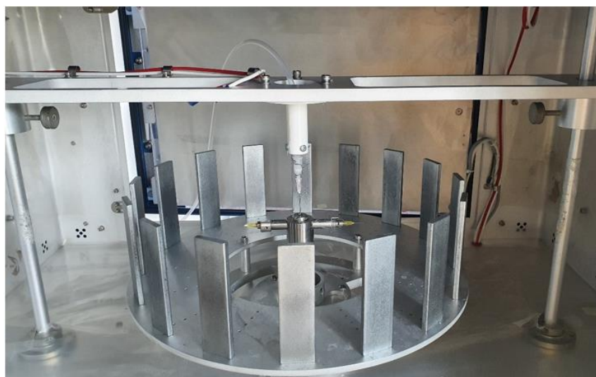
Obr. 37: Přístroj FibeRio CycloneL1000 s upraveným kontinuálním dávkováním
