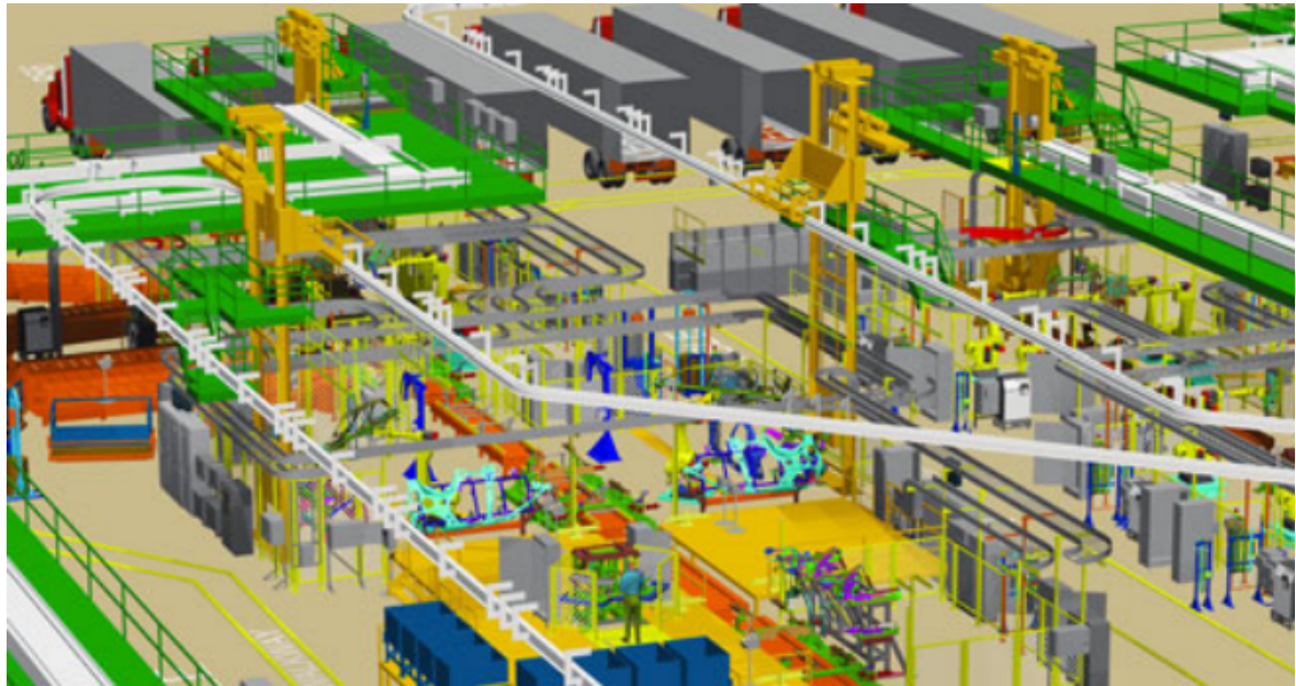
Obrázek 2.12: Vyobrazení digitální továrny - 3D model výrobní linky
