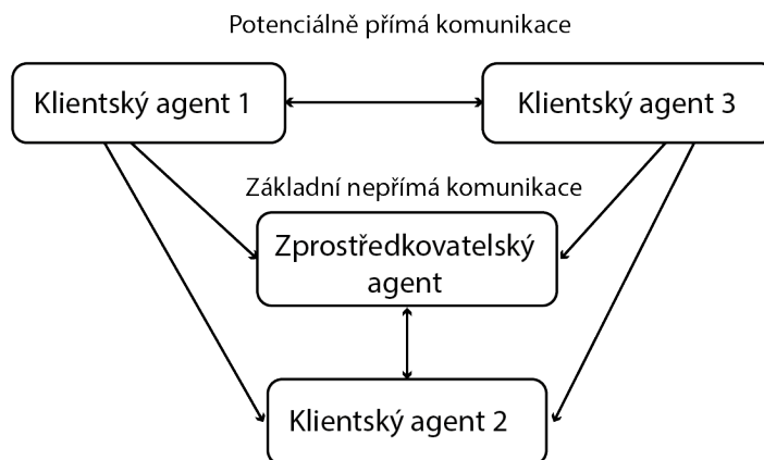
Obrázek 6.3: Architektura federovaného multiagentního systému
