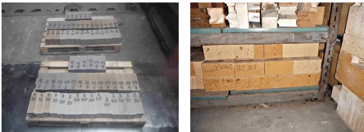
Obrázek 46 Vzorky po vysušení (vlevo) a po výpalu (vpravo), foto Karel Lang
