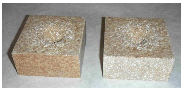
Obrázek 52 Zkušební vzorek receptury č.5 a č.6 po stanovení odolnosti vůči abrazi
