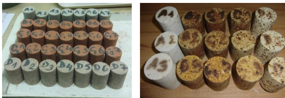
Obrázek 39 Zkušební tělesa před a po výpalu, výpal 1,2,3
