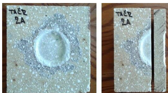
Obrázek 53 Zkušební vzorek dle receptury č.2 po působení alkalických par
