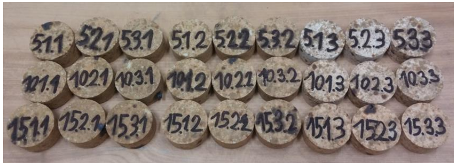
Obrázek 95 Vzorok vypálené na teplotu 1550 °C [134]
