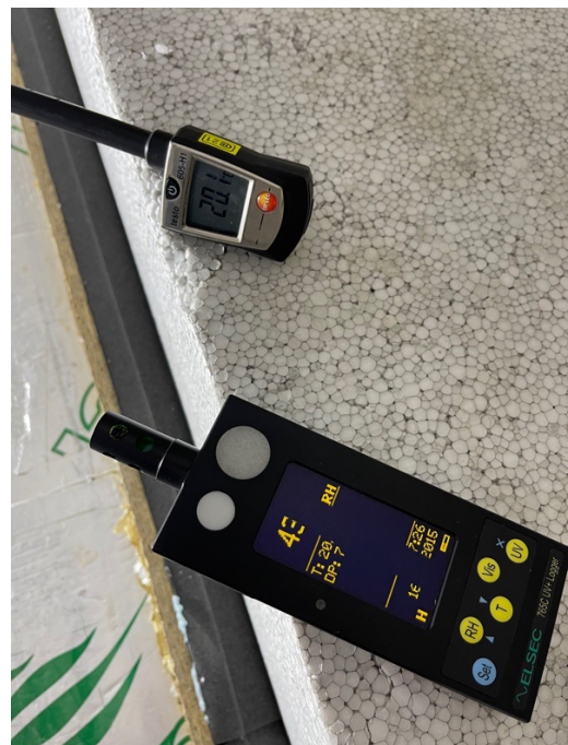
Obr. 87 a 88) Měření povrchových teplot, parametrů prostředí a vzduchové netěsnosti (zdroj: autor)
