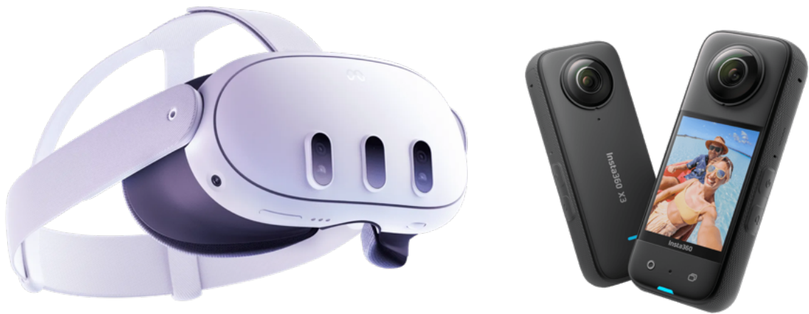
Obr. 31 a 32) Vlevo VR/AR brýle Meta Quest 3 s rozlišením 4K+ a integrovanou baterií (zdroj: https://www.meta.com ). Vpravo sférická 360°kamera s rozlišením 5,7K InstaOne X3 (zdroj: https://www.insta360.com )
