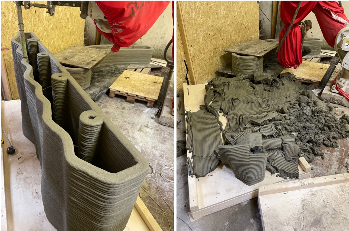
Obr. 75) Vlevo tisk stěny s jednostrannou tvarovou profilací proměnlivou po výšce. Vpravo její kolaps z důvodu nízkých teplot prostředí tisku a nezačínání procesu tuhnutí tiskové směsi (zdroj: autor)
