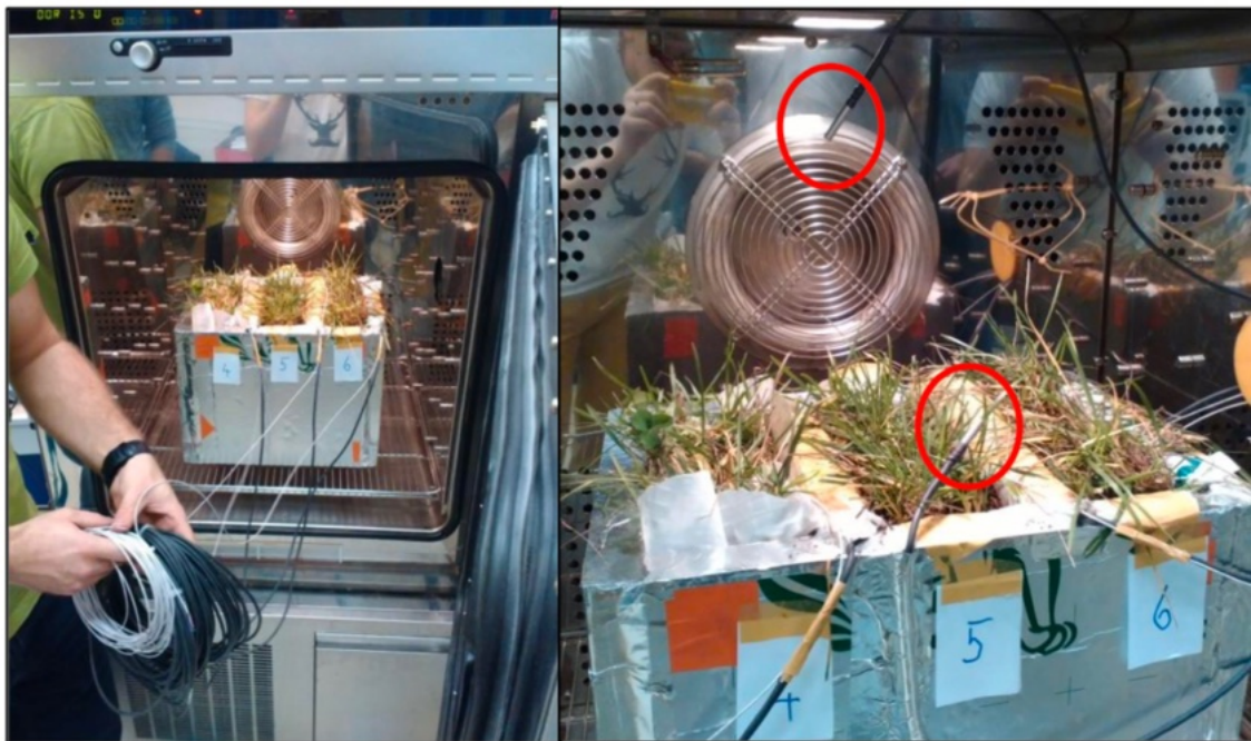
Obr. 47) Pohled do klimakomory Memmert CT256 se vzorky [28]
