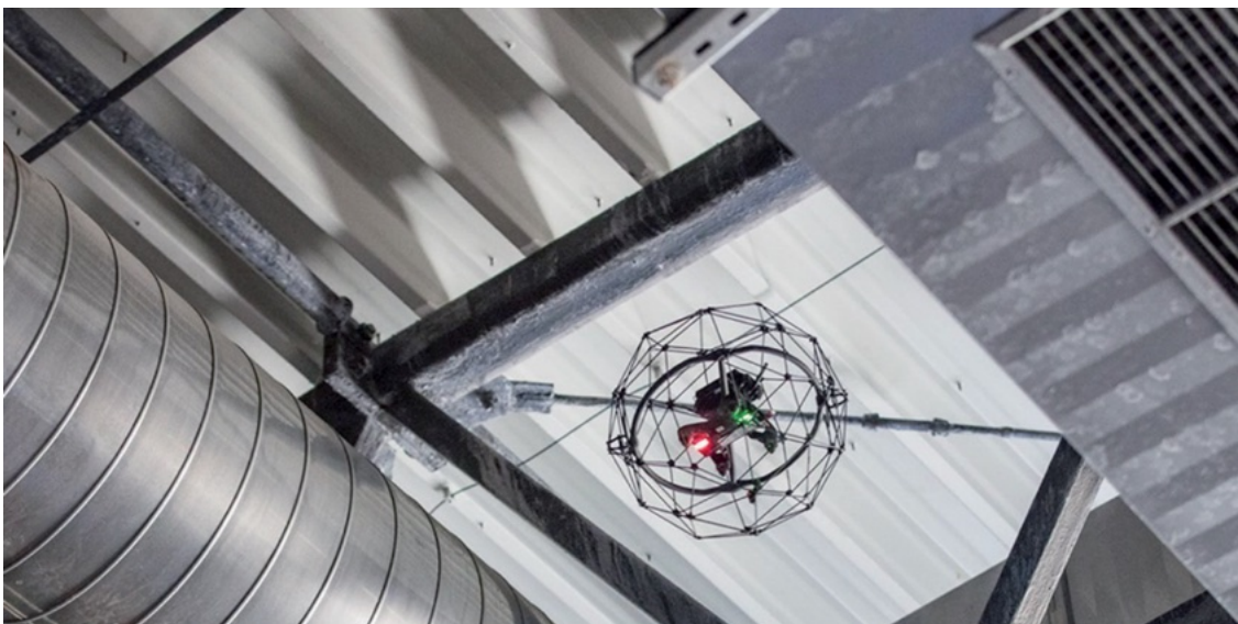
Obr. 5) Výhodou dronů, je možnost kontroly těžko dostupných míst ve výškách. Na obrázku dron Elios 2 Flyability [3]
