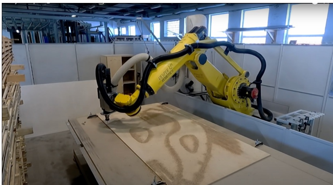
Obr. 67) Obráběcí robot Vesper Robotics, frézující dřevěné lamely koruny stromu. Každá z lamel má unikátní nezaměnitelný tvar definovaný algoritmem parametrického návrhu. (zdroj: Michal Šopík)
