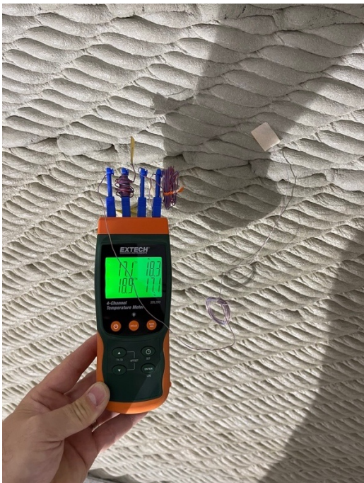
Obr. 87 a 88) Měření povrchových teplot, parametrů prostředí a vzduchové netěsnosti (zdroj: autor)
