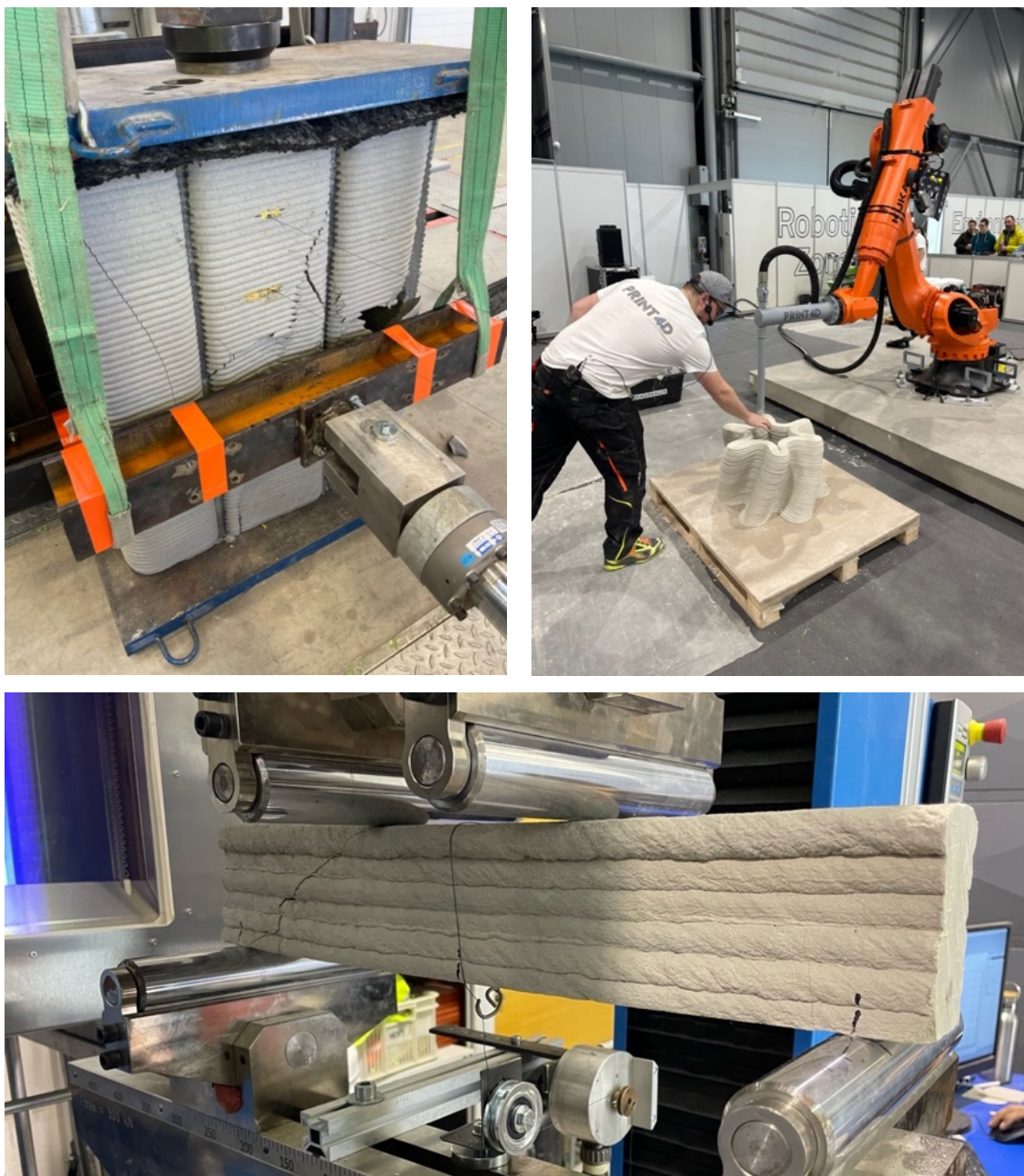
Obr. 98, 99, 100) Vlevo nahoře a dole pohled na 3D tištěné elementy a jejich testování v centru AdMaS a na Ústavu pozemního stavitelství. Vpravo nahoře ukázka tisku sloupu. (zdroj autor + Vojtěch Vaněk)
