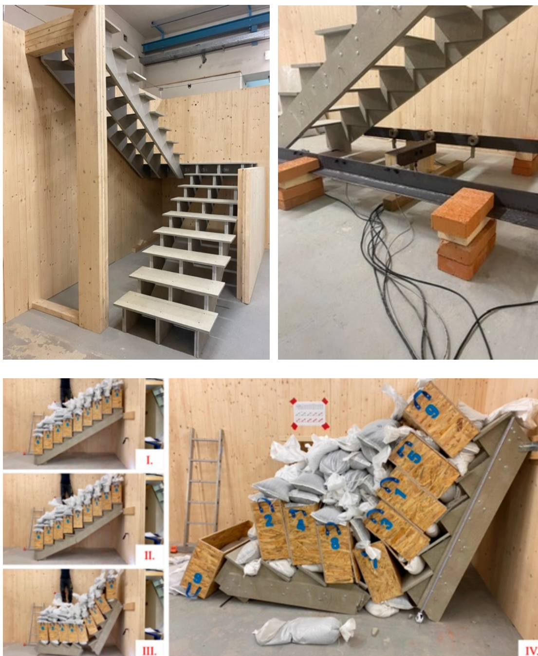
Obr. 95, 96, 97) Pohled na prefabrikované schodiště a jeho testování na polygonu Ústavu pozemního stavitelství (zdroj: autor + Ondřej Nespěšný)
