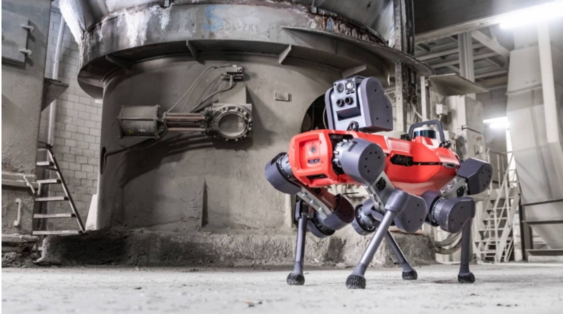
Obr. 8) Mezi klíčové schopnosti robota ANYmal patří zpětnovazební učení, umožňující robustní manévrování a to i ve vícepodlažních průmyslových zařízeních. (zdroj: https://www.anybotics.com )
