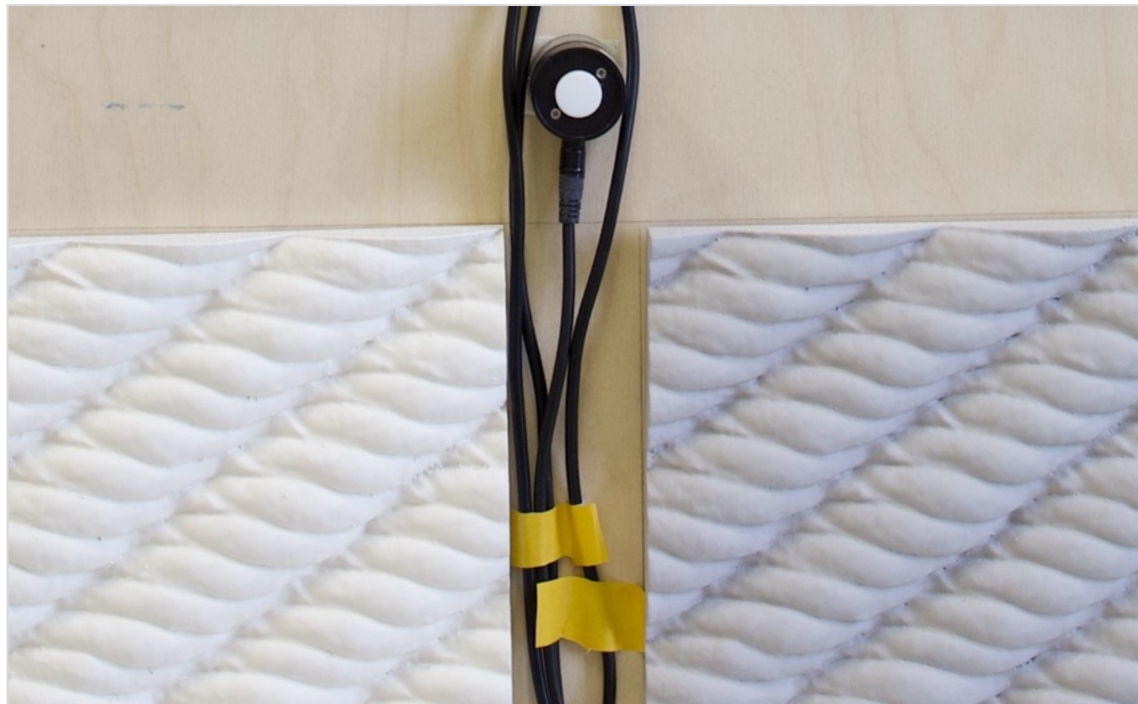
Obr. 109, 110 a 111) Měření a analýza světelně technických vlastností parametricky navržené 3D tištěné stěny (zdroj: autor + František Vajkay)
