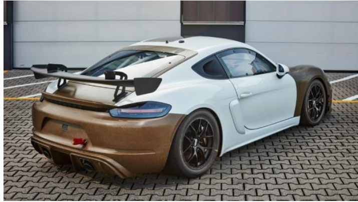
Obr.1 Lněné šasi závodního Porsche Cayman [6].
