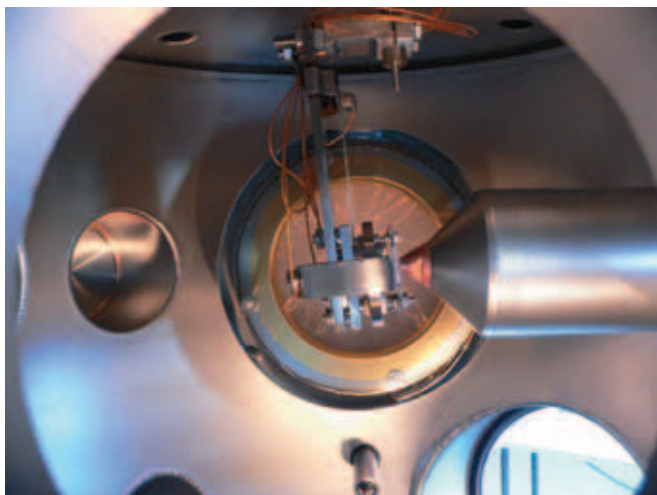
Držák se vzorkem před zařízením pro hmotnostní spektroskopii odpařených atomů (Laboratoř povrchů, tenkých vrstev a nanotechnologií, Ústav fyzikálního inženýrství, FSI, VUT v Brně)
