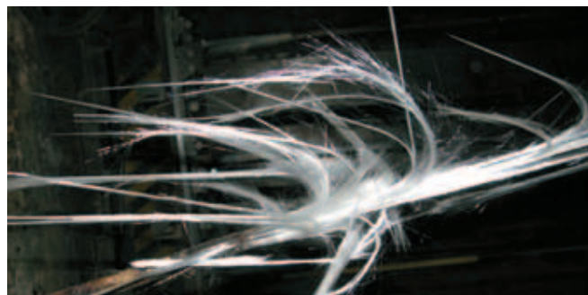
Kompozitní výztuž (Glass Fibre Reinforced Polymer) přetřezená při požární zkoušce
