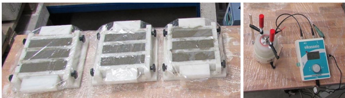
Obr. 55 Zkušební tělesa 40 \times 40 \times 160 mm (vlevo); uspořádání změření UZ přístrojem [66].
