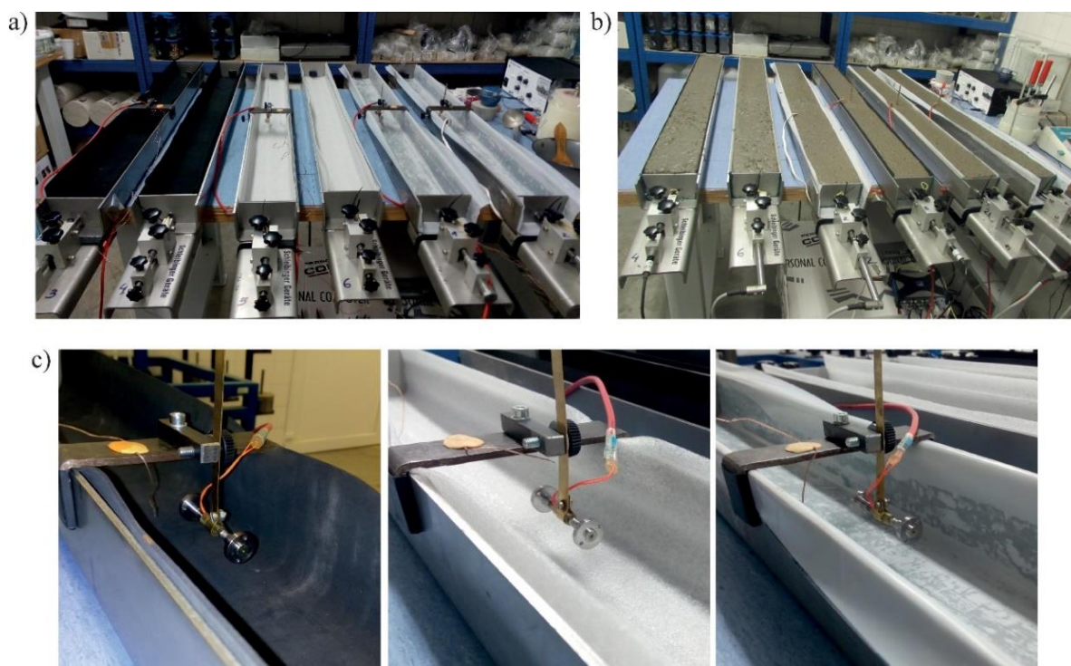
Obr. 49 Celkový pohled na smršťovací žlaby před betonáží (a) – zleva neopren, polyetylén, teflon; po naplnění (b); detail umístění tenzometrů ve žlabech před jejich naplněním betonem (c) [65].
