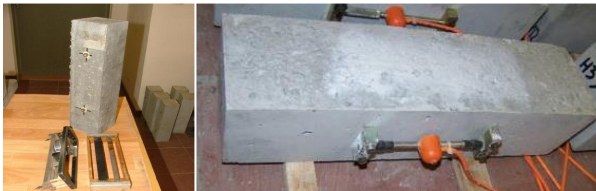
Obr. 13 Měření smrštění na podélných stranách zkušebních těles (vlastní experiment).
