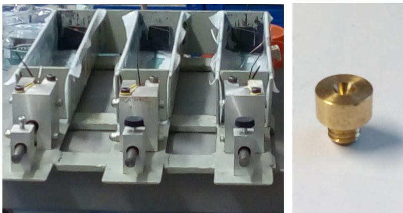
Obr. 16 Měřicí žlaby s vnitřními rozměry 50 \times 50 \times 300 mm; speciální šroubovací kontakty pro účely dlouhodobého měření (vpravo).
