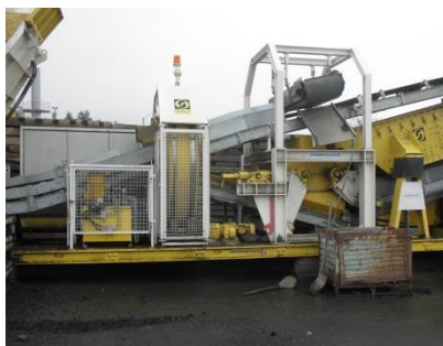
Obrázek 1 Stacionární technologická linka pro drcení asfaltového recyklátu
