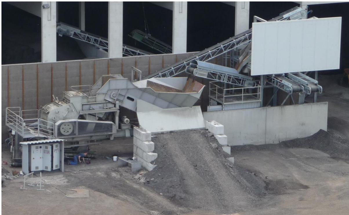
Obrázek 8: Drticí zařízení pro přípravu R-materiálu
