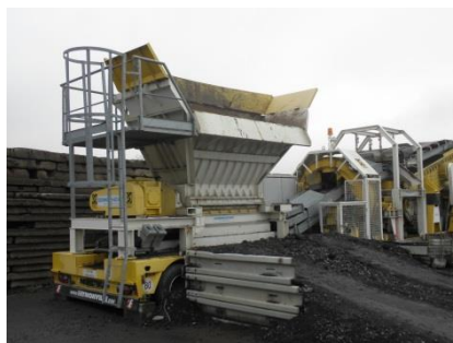
Obrázek 1 Stacionární technologická linka pro drcení asfaltového recyklátu
