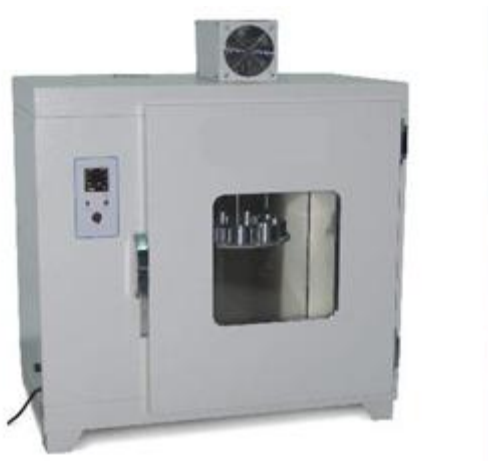
Obrázek 1: Zkušební zařízení pro zkoušku tepelné stálosti tenkého filmu (Thin Film Oven Test – TFOT) [9]
