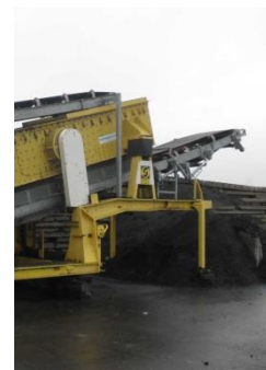
Obrázek 1 Stacionární technologická linka pro drcení asfaltového recyklátu
