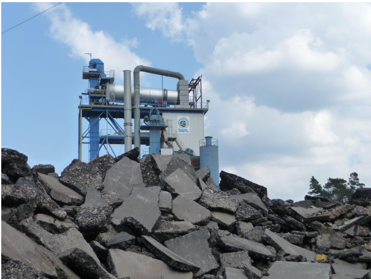
Obrázek 7: Znovuzískaná asfaltová směs ve formě vybouraných ker
