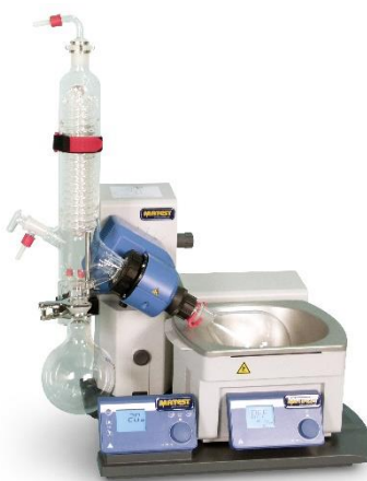
Obrázek 2: Rotační vakuové destilační zařízení k provedení zkoušky krátkodobého stárnutí metodou RFT (Rotating Flask Test) [10]
