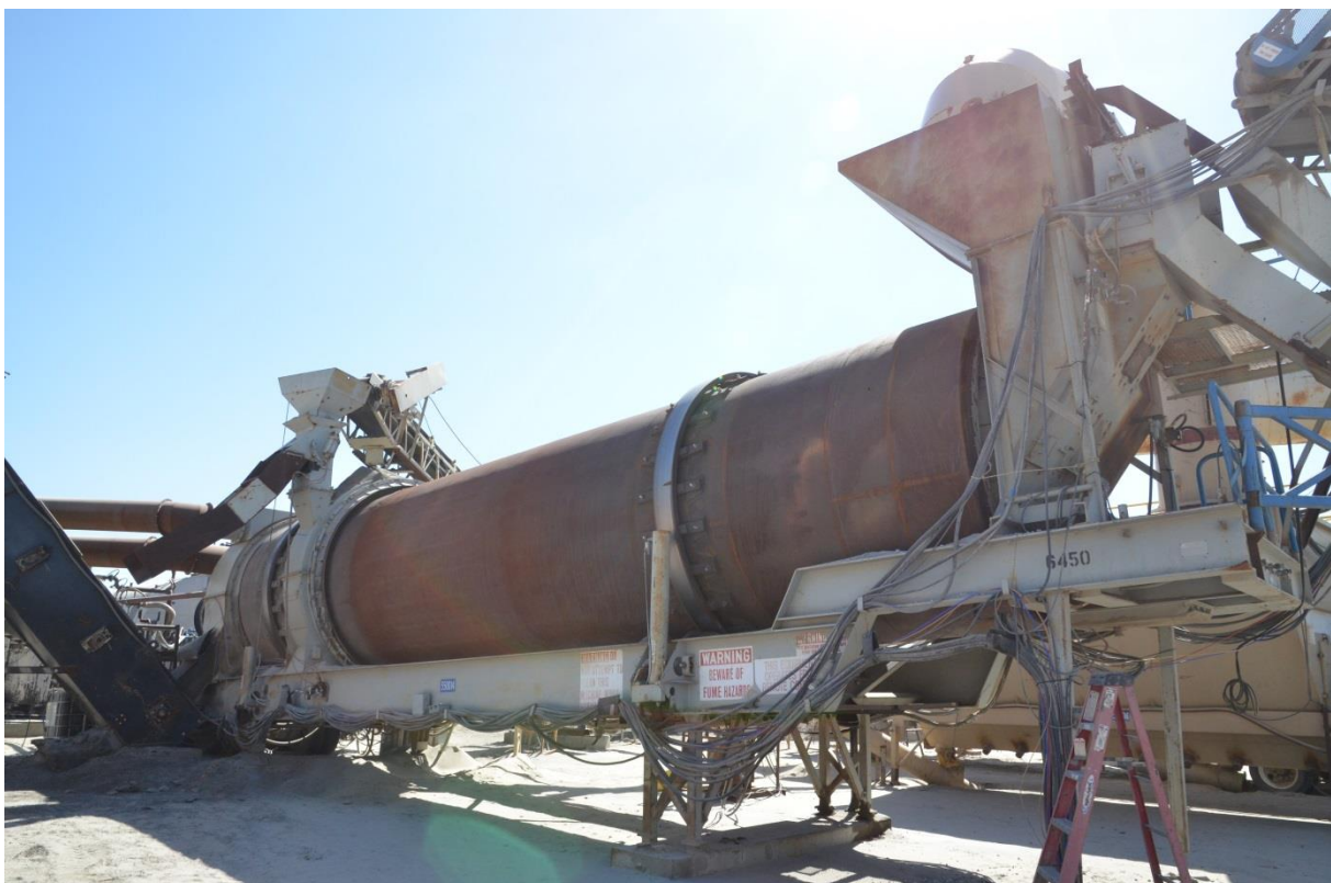
Obrázek 17: Kontinuální obalovna s násypkou pro dávkování R-materiálu a systémem přidávání R-materiálu proti proudu horkého vzduchu
