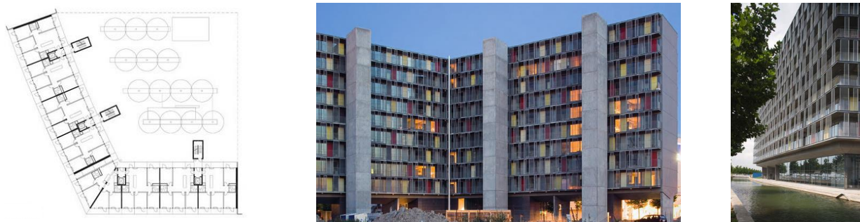
Obr. 2: Pôdorys a priestorové usporiadanie vysokoškolského domova Signalhuset v Orestade v Dánsku. Súvislý lineárny zalomený pôdorys a jednotná výška objektu predstavuje typ kompaktného monobloku. ( Zdroj: FRIEDMAN, A. Innovative student residences: new directions in sustainable design, s.61, 62. )
