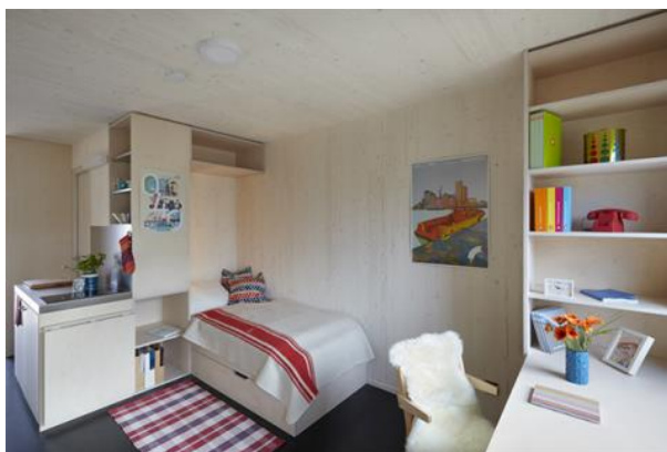
Obr. 167: Realizácie študentských izieb v modulárnych vysokoškolských domovoch v rôznych stupňoch prefabrikácie interiéru. Drevený nábytok izby v internáte Woodie v Hamburgu bol plne integrovaný vo fabrike. V študentskej bunke internátu Frankie & Johnny v Berlíne je prefabrikovaný priestor kúpeľne so zabudovaným úložným nábytkom ju obopínajúcim. ( Zdroj: Woodiefy your life [online]; EBA Berlin (Eichbuschallee) [online]. )
