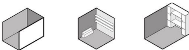
Obr. 166: Schémy rôzneho stupňa prefabrikácie interiéru, mobiliáru ubytovacích buniek. ( Zdroj: FRIEDMAN, A. Innovative student residences: new directions in sustainable design, s. 47. )
