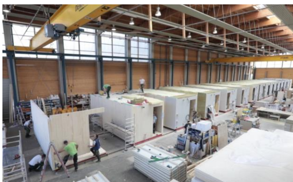
Obr. 115: Drevená prefabrikovaná modulárna jednotka zaizolovaná minerálnou vatou je po zhotovení v špecializovanej fabrike osadená na mieste výstavby. ( Zdroj: Woodiefy your life [online]. )
