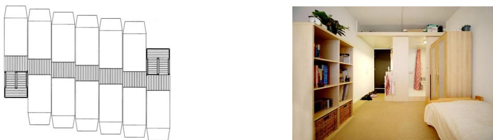
Obr. 84: Princíp radenia modulov Spacebox v rámci typického podlažia. Pohľad do interiéru študentskej bunky: integrovaná kuchynka a otvorená kúpeľňa. ( Zdroj: HOLLAND COMPOSITES. Prefabricated living modules [online]. )
