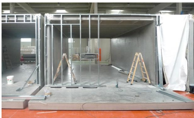
Obr. 103: Výroba vo fabrike a osadenie betónových prefabrikátov na miesto výstavby. Vysokoškolský domov v Barcelone. ( Zdroj: GOULA, A. 57 Viviendas Universitarias En El Campus De L'Etsav [online]. )
