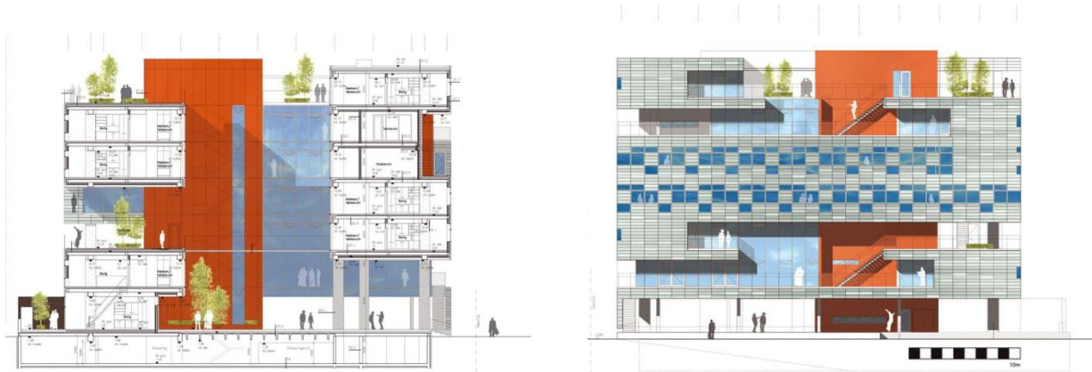
Obr. 30: Vysokoškolský domov Bikuben v Kodani: rez objektom a pohľad. Elimináciou niektorých modulov v systémovej dispozičnej skladbe vznikli spoločné exteriérové plochy a zaujímavé priehľady. ( Zdroj: ESKEROD, T. Aart a/s: Bikuben Student Residence [online].)
