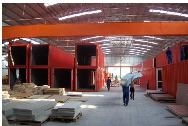
Obr. 122: Konverzia kontajnerov na študentské obytné bunky prebiehala vo fabrike. Na mieste výstavby boli kontajnery ukladané a pripevňované na seba v piatich radoch. ( Zdroj : Keetwonen [online]. )
