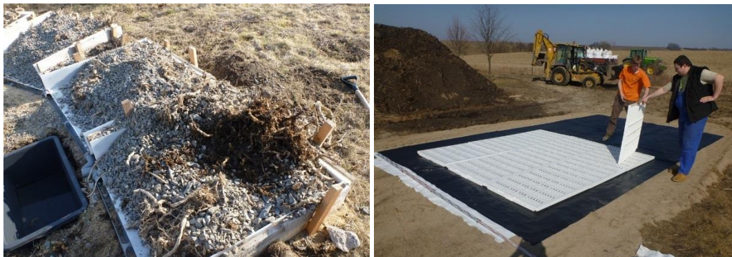
Obr. 63 Testovací plochy pro regeneraci filtračního materiálu
