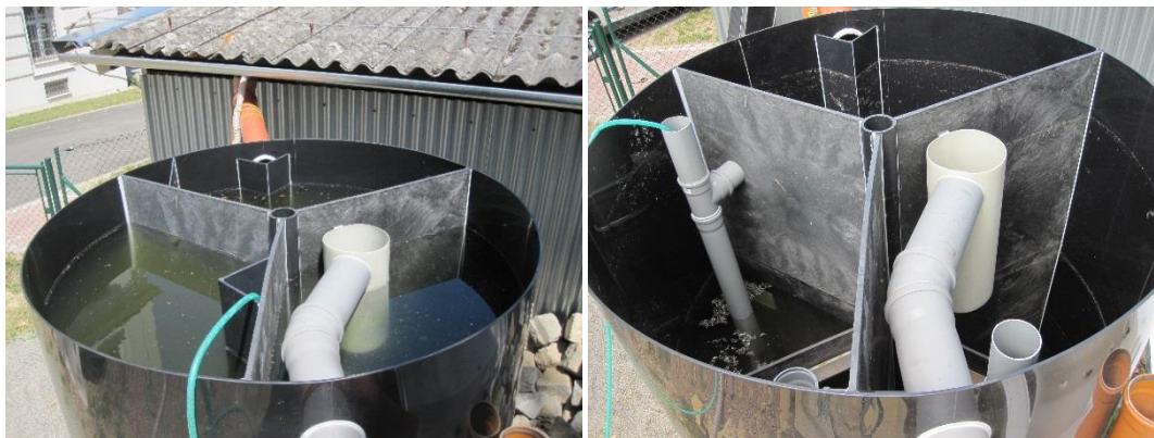
Obr. 33 První verze testovacího septiku před a po úpravách na základě získaných výsledků
