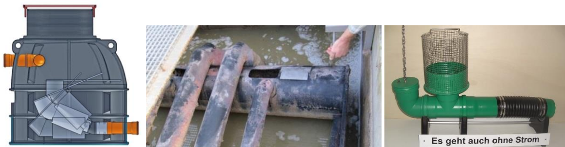
Obr. 48 Řešení pulzního dávkování odpadní vody (Rak., Francie, Německo)
