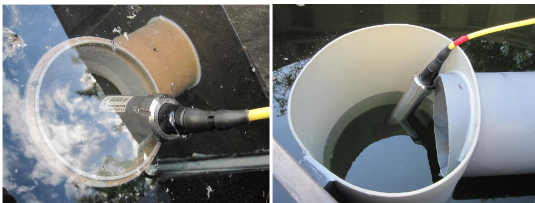
Obr. 34 Umístění sondy na prostupu přepážkou a v odtokovém profilu
