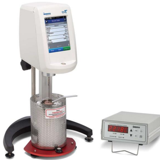
Obrázek 12: Brookfieldův viskozimetr s jednotkou thermosel [77]
