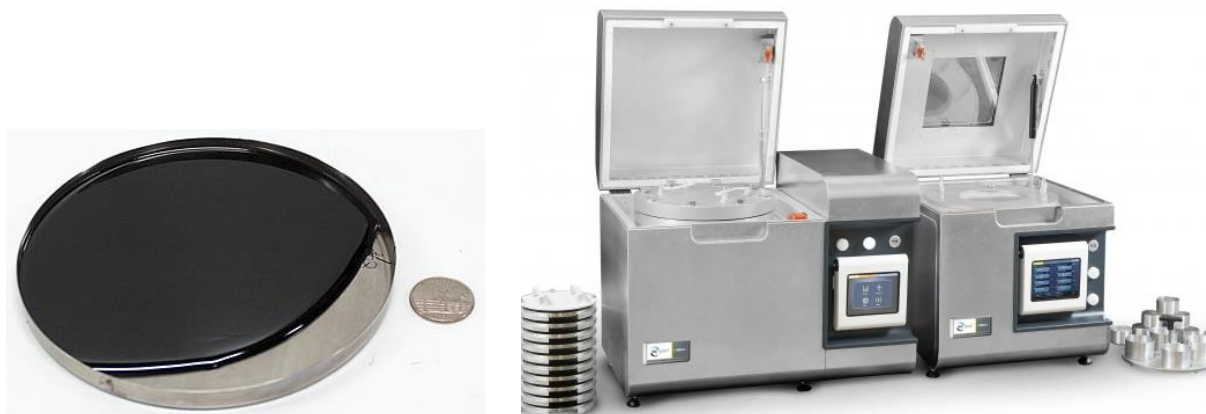
Obrázek 8: Zkušební miska s nalitým vzorkem asfaltu pro zkoušku v PAV (vlevo) [8] a zařízení PAV a VDO (vpravo) [73]
