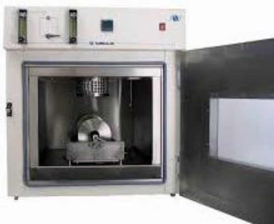
Obrázek 7: Zařízení pro urychlené dlouhodobé stárnutí metodou rotujícího válce (Rotating Cylinder Ageing Test – RCAT) [67]
