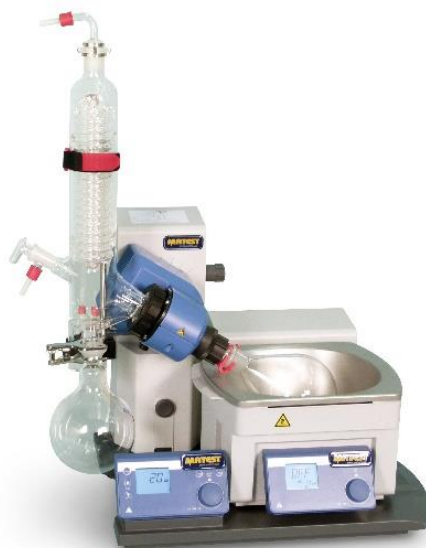
Obrázek 6: Rotační vakuové destilační zařízení k provedení zkoušky krátkodobého stárnutí metodou RFT [68]
