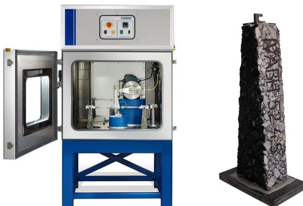
Obrázek 23: Zařízení pro provedení dvoubodové zkoušky ohybem (vlevo) [76] a zkušební těleso tvaru trapezoidu vlepěné do podložek (vpravo) [44]
