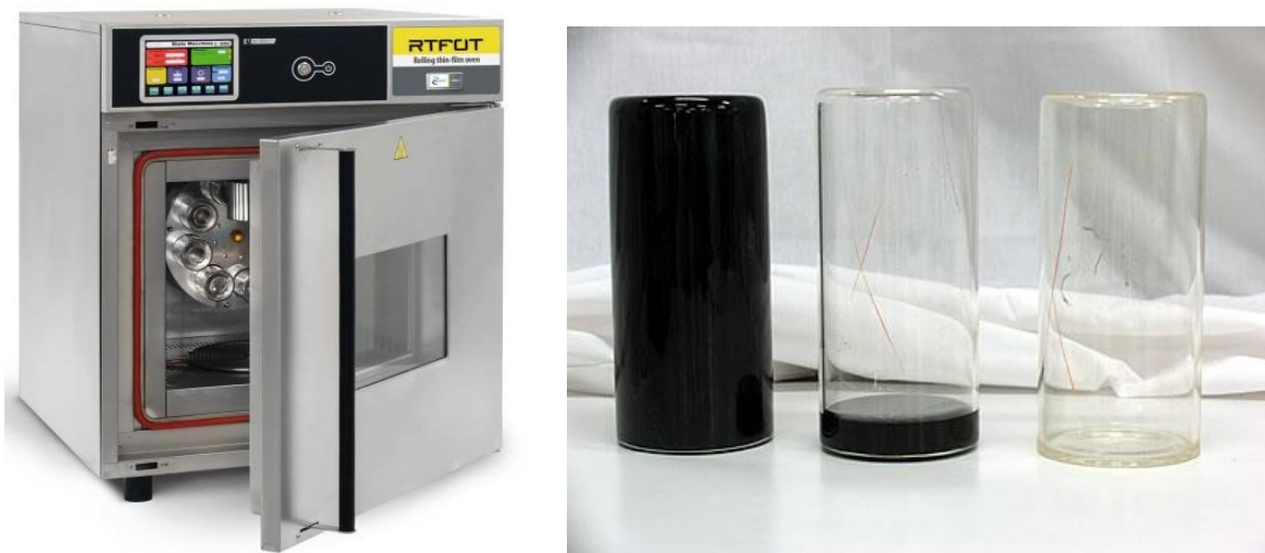
Obrázek 4: Zařízení RTFOT (vlevo) [74] a skleněné nádoby (vpravo) [72]
