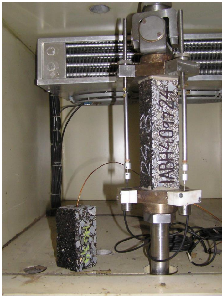
Obrázek 20: Zkušební těleso upevněné do zařízení TSRST v silniční laboratoři VUT v Brně [44]
