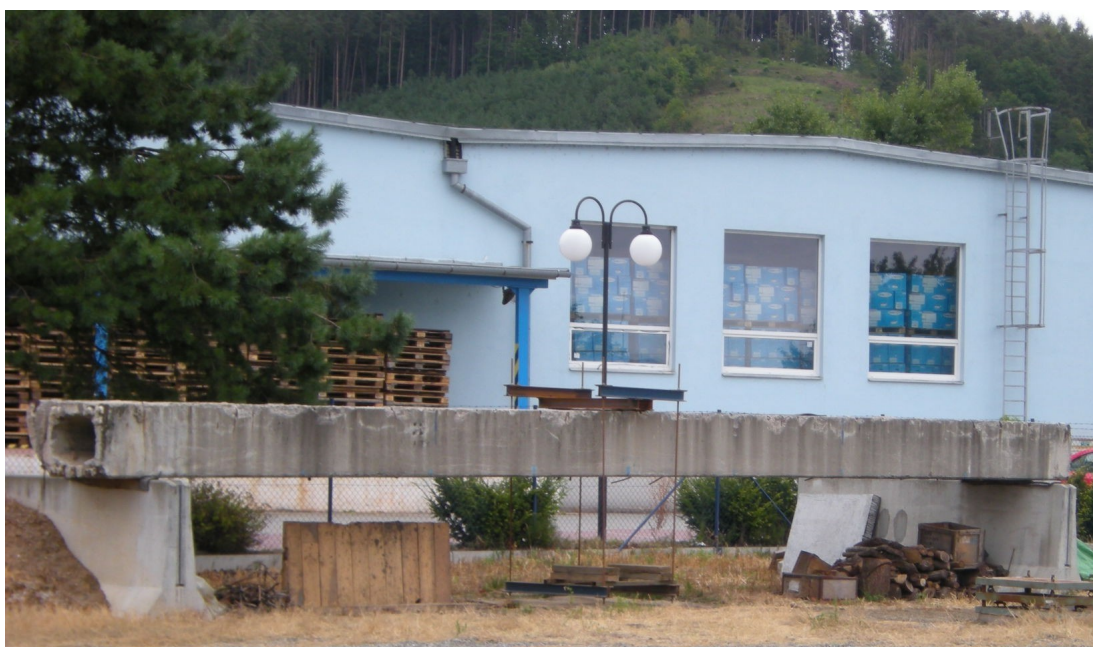
Obr. 5.54. Železobetonový nosník s osazeným zatěžovacím rámem.
