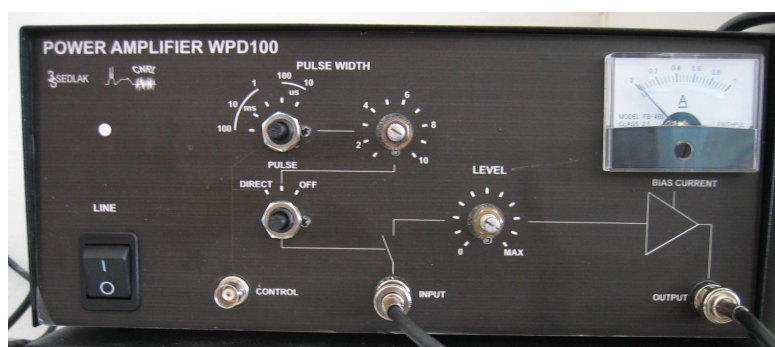
Obr. 4.3. Řízený výkonový zesilovač pro buzení ultrazvukových vysílačů.
