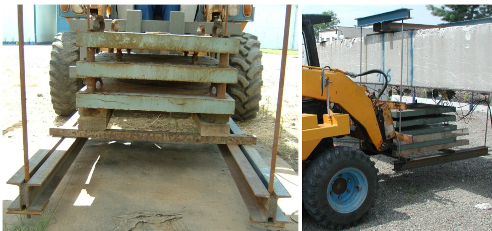
Obr. 5.58. Ukázka dynamického zatěžování nosníku.
