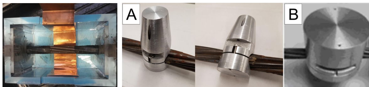
Obr. 5.74. Vlevo – detail korozního boxu s vloženým lanem; vpravo – jednotlivé typy vlnovodů.
