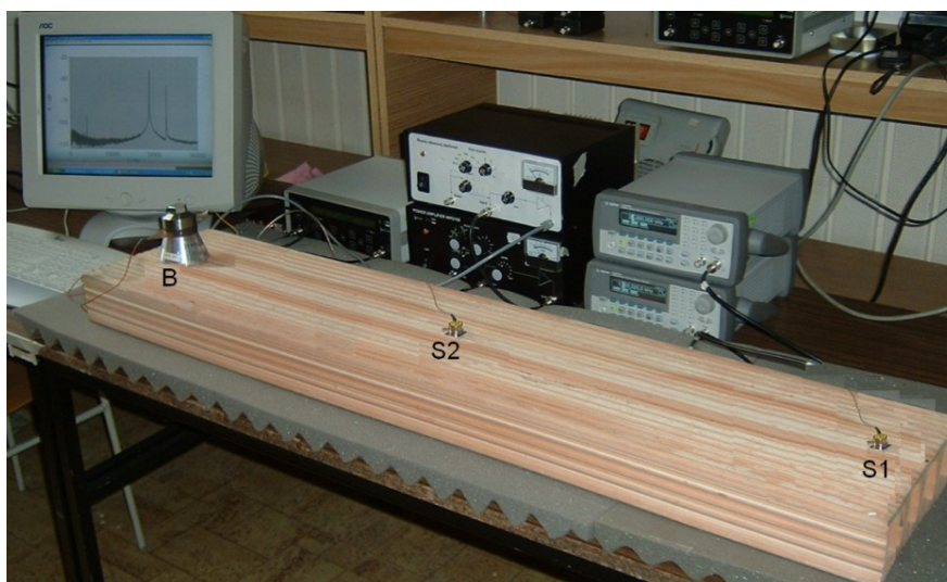
Obr. 5.13. Ukázka stropní desky s vyznačenou polohou budiče B a pozicemi snímače (S1, S2) při aplikaci metody s jedním budícím signálem.
