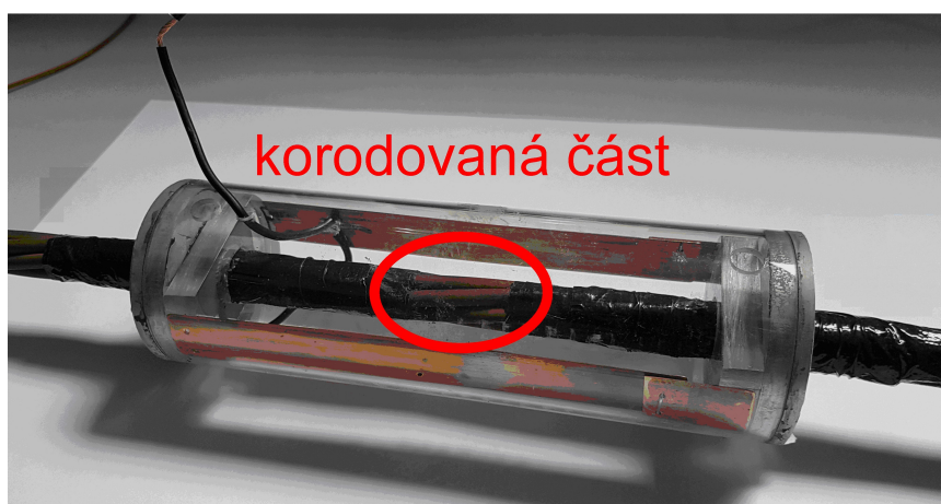
Obr. 5.65. Ocelové lano s osazeným korozním článkem.
