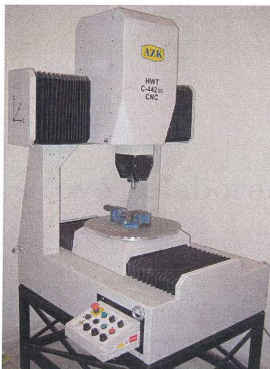
Obrázek 3.25: 5D frézka používaná pro výrobu reálných modelů tkání.
