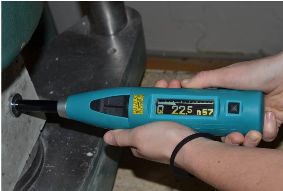
Obr. 4 Tvrdoměr Silver Schmidt PC typu LM s hříbovitým nástavcem
