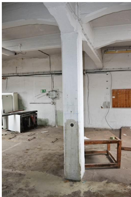
Obr. 66 Stanovení rychlosti šíření impulzů ultrazvukového vlnění na sloupu, vpravo tentýž sloup po odběru jádrového vývrtnu Ø 50 mm na upřesnění NDT zkoušek [8]
