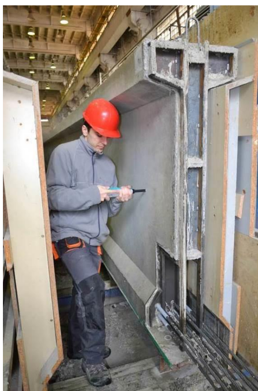
Obr. 41 Zkoušení předem předpjatého vazníku tvrdoměrem Silver Schmidt PC-N po odstranění formy (vlevo) a po vyvezení vazníku na venkovní skládku (vpravo)
