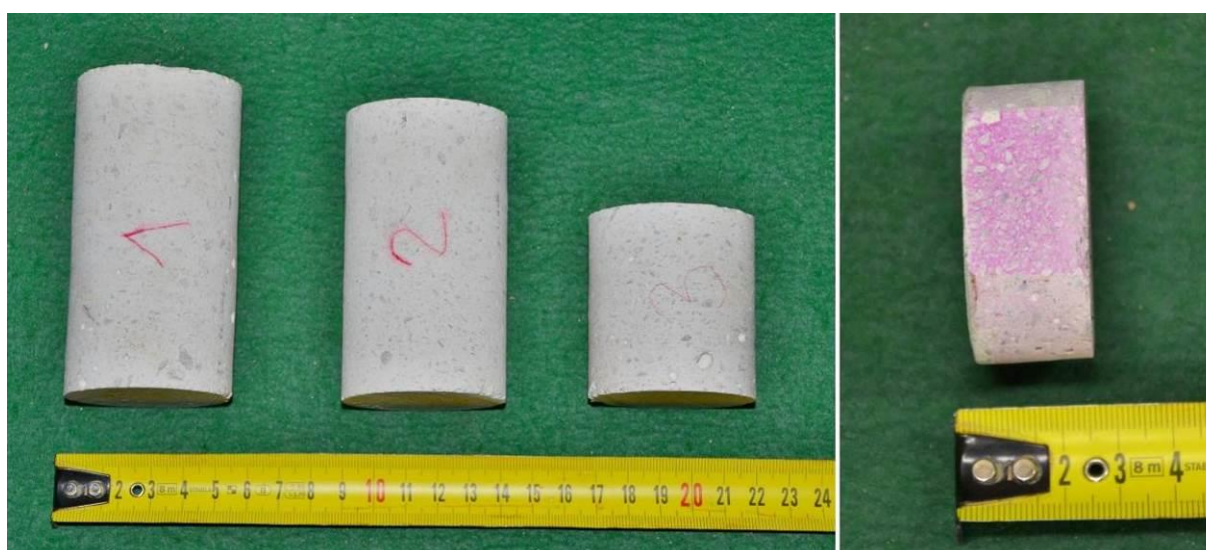
Obr. 116 Zkušební tělesa č. 1, 2 a 3 vyrobená z vývrtu do soklu; vpravo fenolftaleinový test na horní (povrchové) části jádra, karbonatace betonu je naprosto minimální
