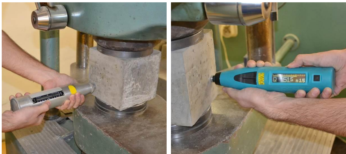
Obr. 36 Zkoušení těles tvrdoměrem Schmidt N (vlevo) a Silver Schmidt PC-N (vpravo)
