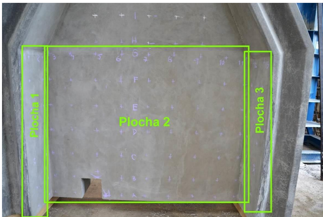
Obr. 54 Schéma vytyčení zkušebních ploch 1 až 3 na svislých stěnách prvku
