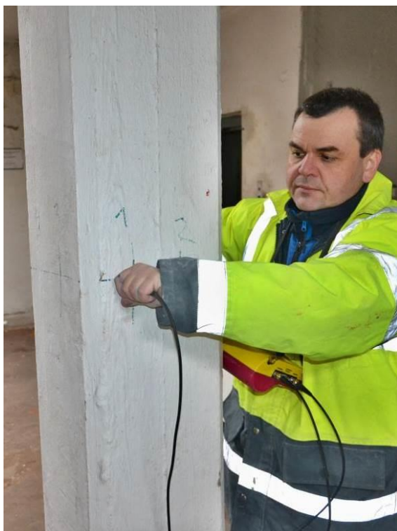
Obr. 66 Stanovení rychlosti šíření impulzů ultrazvukového vlnění na sloupu, vpravo tentýž sloup po odběru jádrového vývrtnu Ø 50 mm na upřesnění NDT zkoušek [8]
