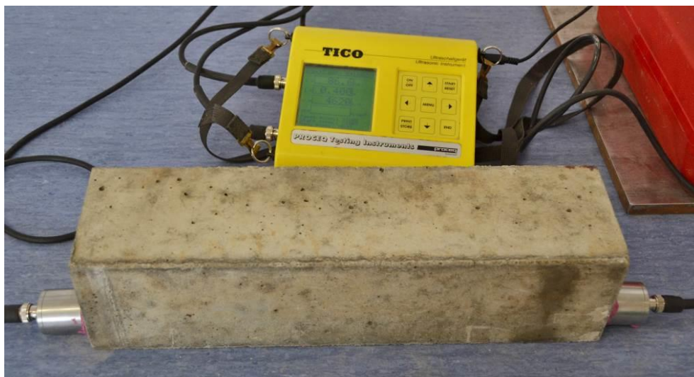
Obr. 63 Ultrazvukové měření pro upřesnění hodnoty zmenšovacího součinitele \kappa_u
