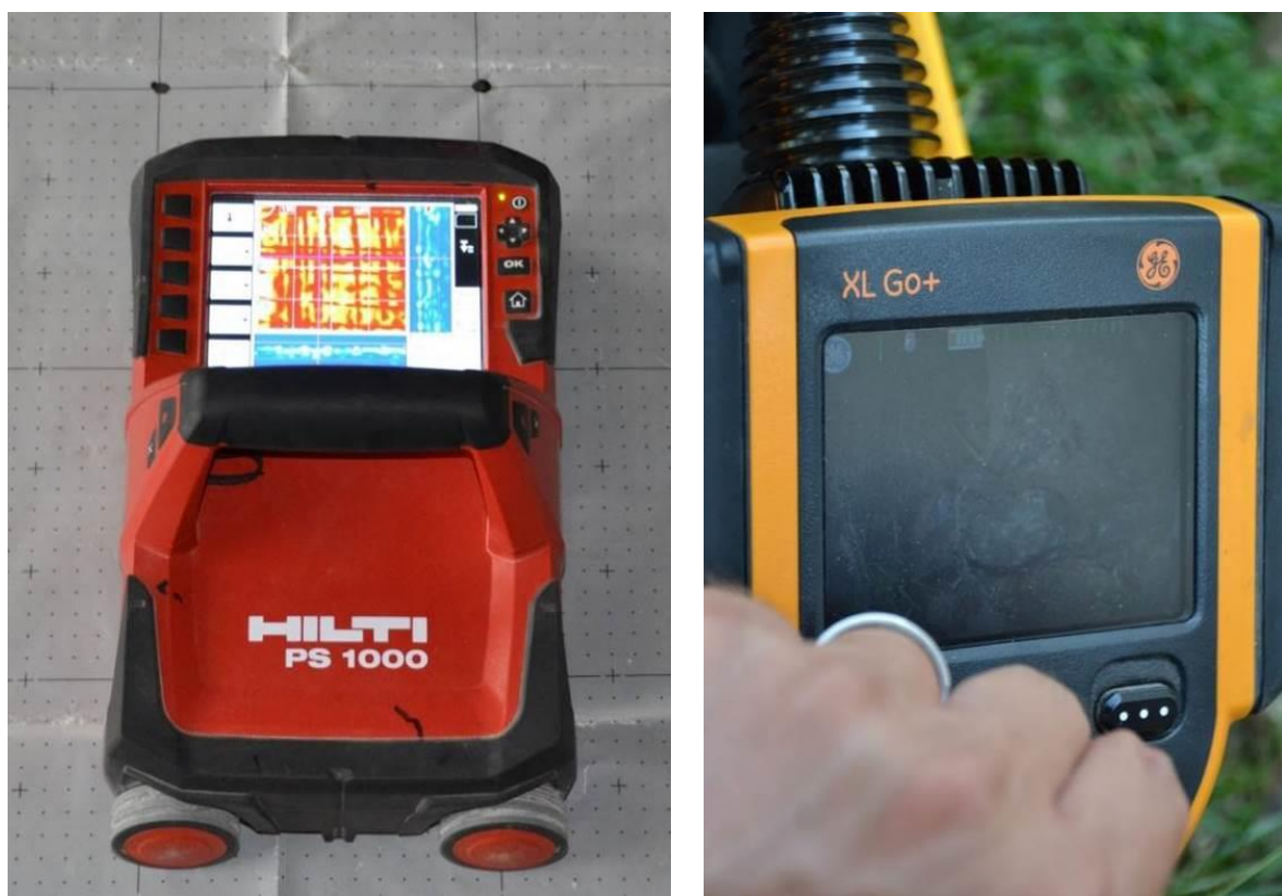
Obr. 113 Použité přístroje – vlevo radar Hilti PS 1000, vpravo videoskop GE Go+
