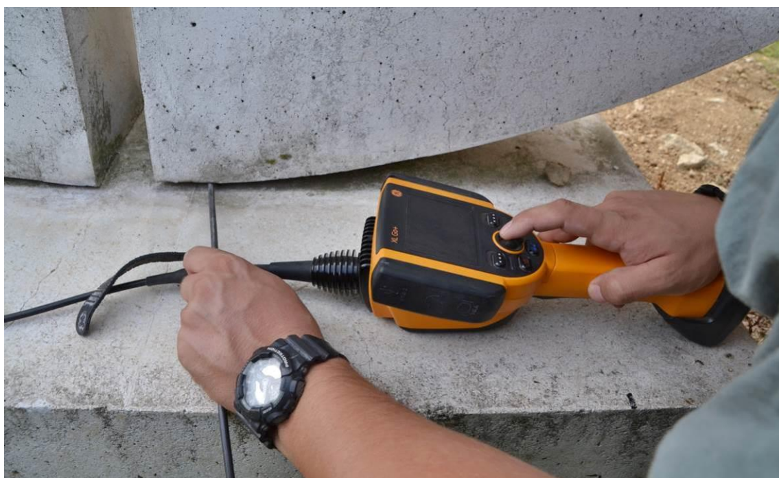
Obr. 128 Prohlídka spáry mezi soklem a diskem plastiky pomocí videoskopu GE XL Go+ VideoProbe
