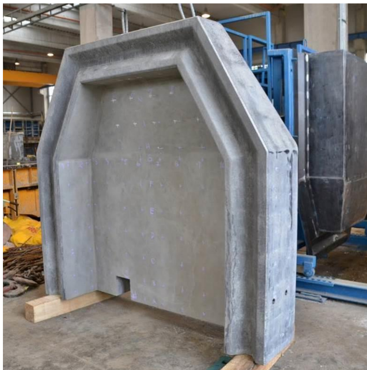
Obr. 51 Pohled na desku nosné konstrukce s vyznačenými liniemi skenování výztuže
