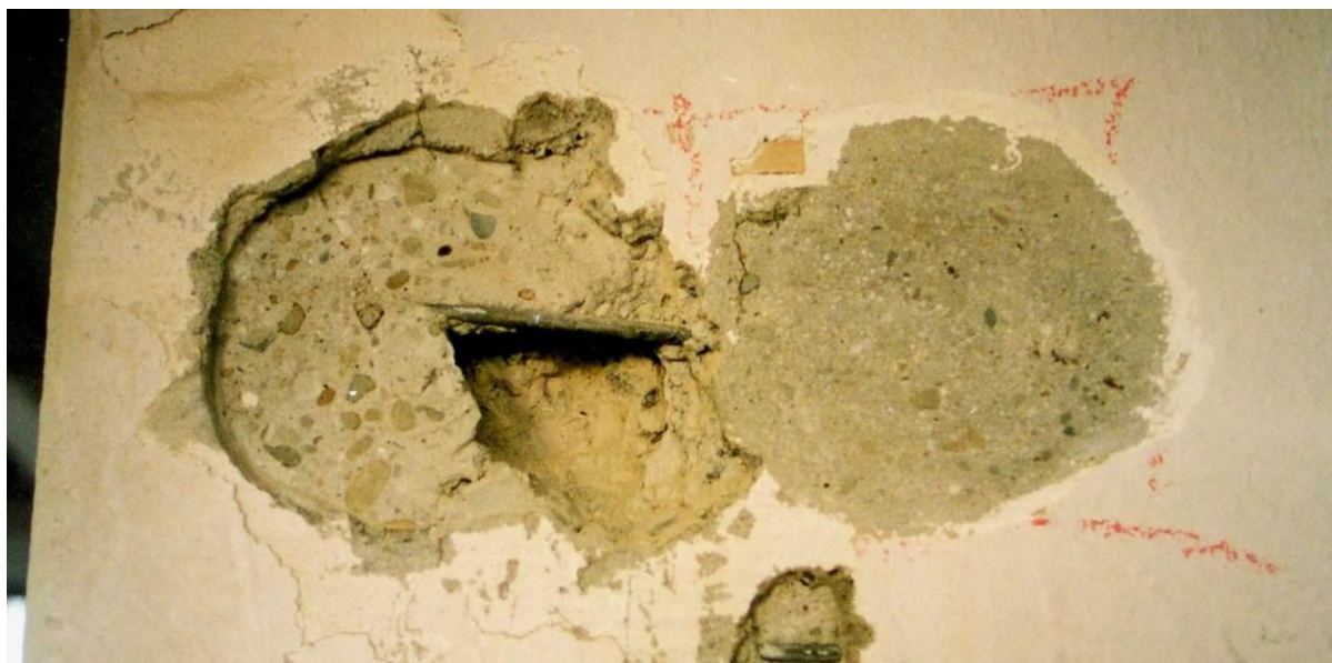
Obr. 29 Dvojice míst pro tvrdoměrné zkoušky betonu na sloupu, kdy nejprve došlo pouze k vybroušení vrstvy cementové omítky (vpravo), teprve poté k vybroušení až na strukturu skutečného betonu sloupu (vlevo)
