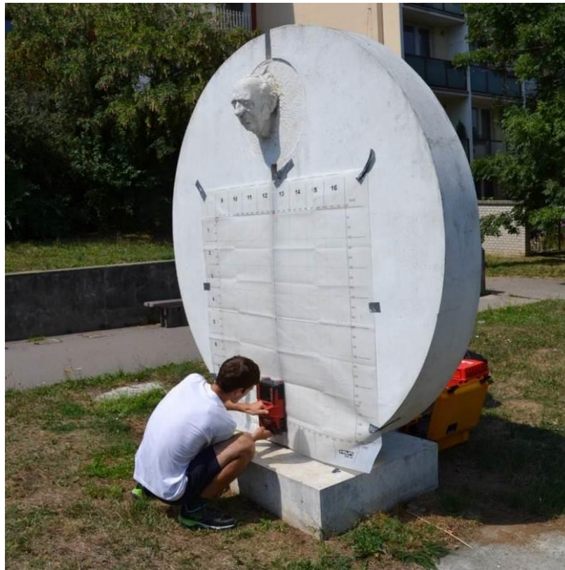
Obr. 123 Stanovení množství a polohy výztuže na straně B (jižní) – papírový rastr vyznačuje skenovanou plochu o rozměrech 1,2 \times 1,2 m, rozdělenou na pásy po 150 mm
