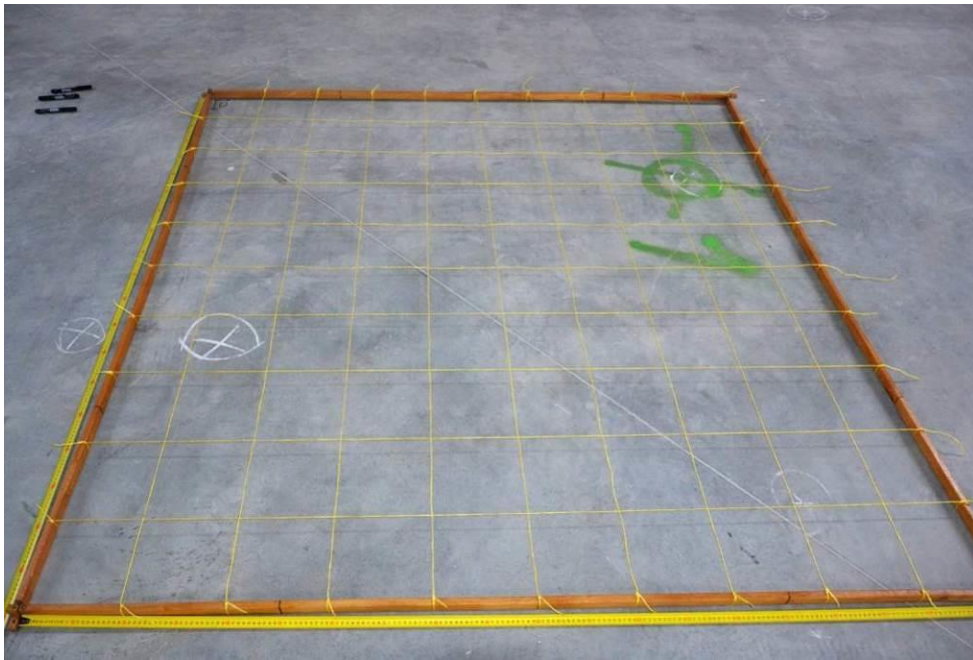
Obr. 44 Zkušební plocha č. 1 o velikosti 2,0×2,0 m, tři lokální nespojitosti označené křídou
