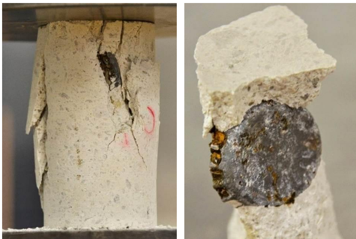
Obr. 117 Při zatěžování a po rozdrčení zkušebního tělesa č. 2 se ukázalo, že skrývá starý kovový uzávěr lahve
