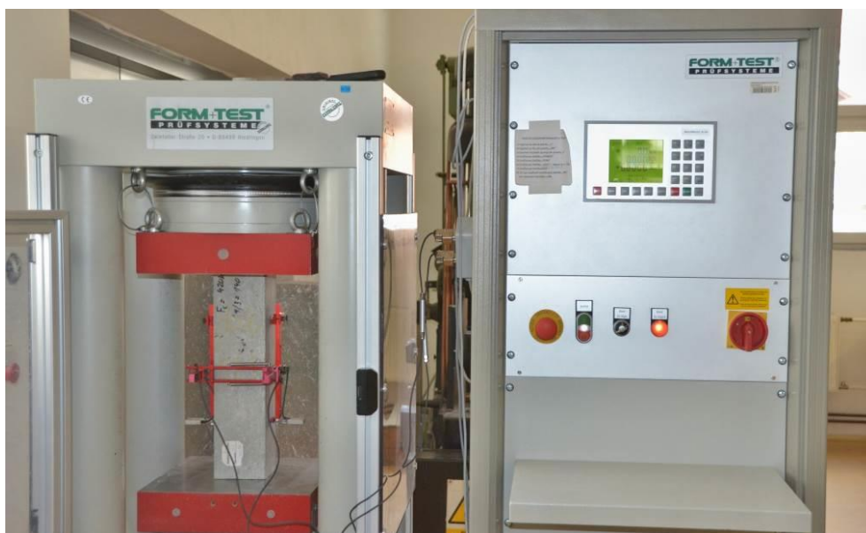
Obr. 64 Zkouška statického modulu pružnosti v tlaku pro upřesnění hodnoty zmenšovacího součinitele \kappa_u
