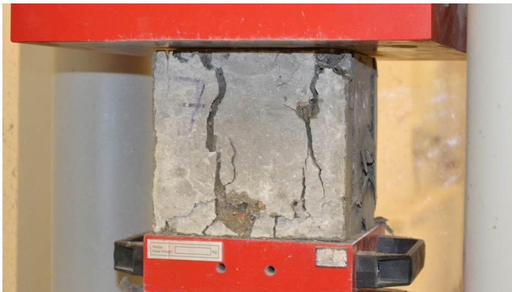
Obr. 37 Zkušební krychle v lisu po stanovení pevnosti v tlaku
