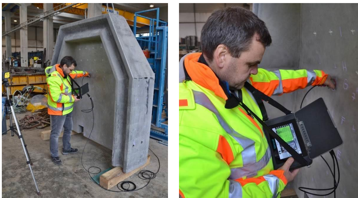
Obr. 53 Ukázka měření rychlosti šíření ultrazvukového vlnění přístrojem PUNDIT PL-200 – vlevo celkový pohled, vpravo detail přístroje se zobrazeným povrchovým grafem
