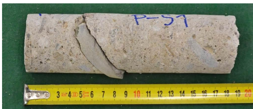
Obr. 67 Jádrový vývrt P-S1 o průměru 50 mm se při odběru rozpadl vlivem velkého plochého zrna kameniva a jeho nízké soudržnosti s tmelem
