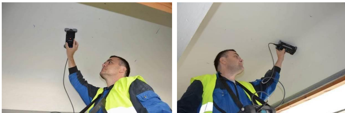
Obr. 83 Měření polohy a krytí výztuže na mezitrámové desce galerie II v Pavilonu „Z“ na Brněnském výstavišti
