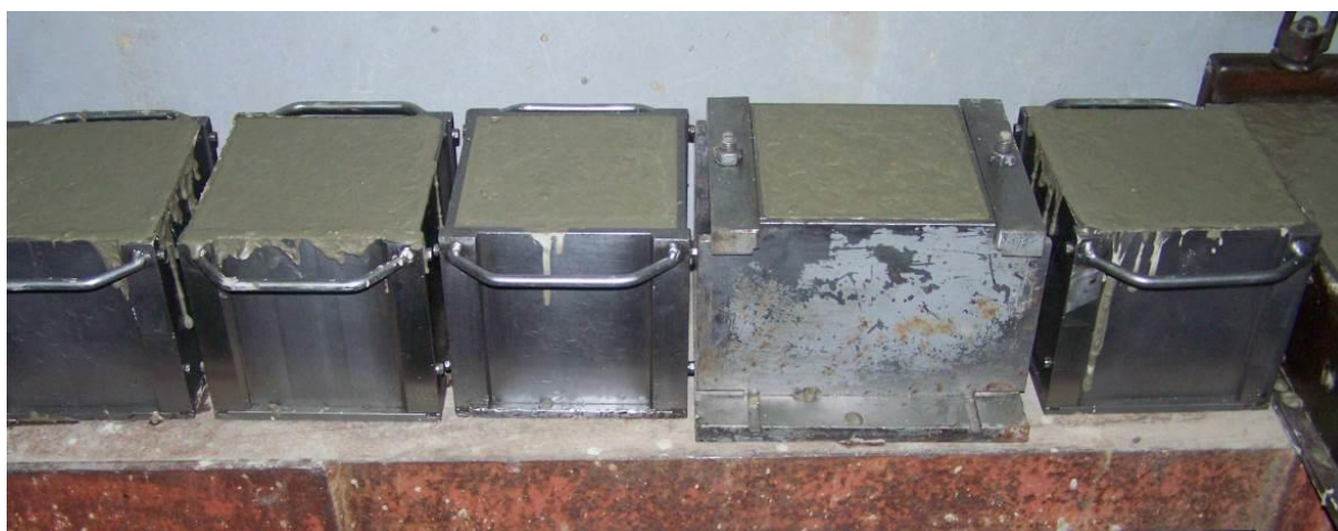
Obr. 35 Zkušební tělesa ve tvaru krychle čerstvě vybetonovaná v kovových formách
