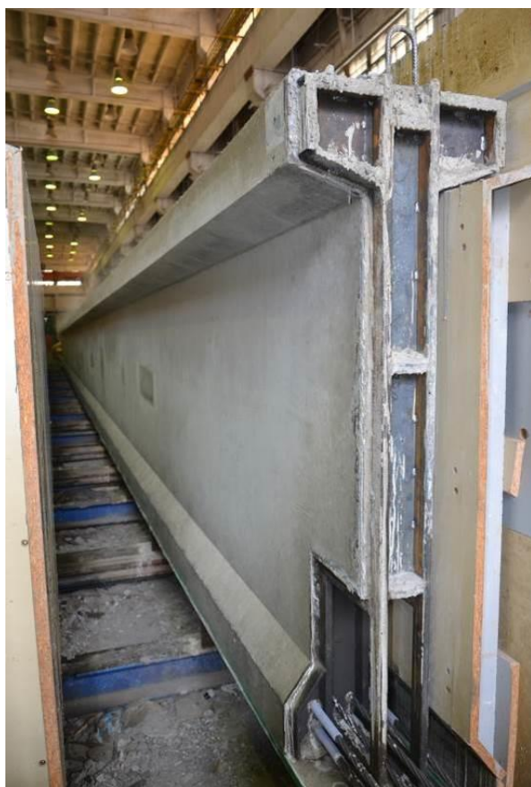
Obr. 34 Zkoušený předem předpjatý vazník V03 po odbednění, vpravo příčný řez střední částí vazníku [37]
