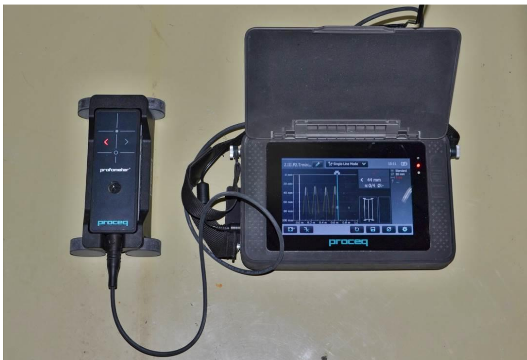
Obr. 18 Profometer PM-6 s integrovanou sondou a dotykovým displejem, na němž lze ihned kontrolovat správnost měření pomocí křivek intenzity signálu
