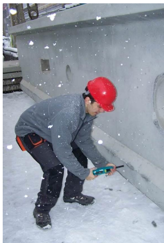
Obr. 41 Zkoušení předem předpjatého vazníku tvrdoměrem Silver Schmidt PC-N po odstranění formy (vlevo) a po vyvezení vazníku na venkovní skládku (vpravo)
