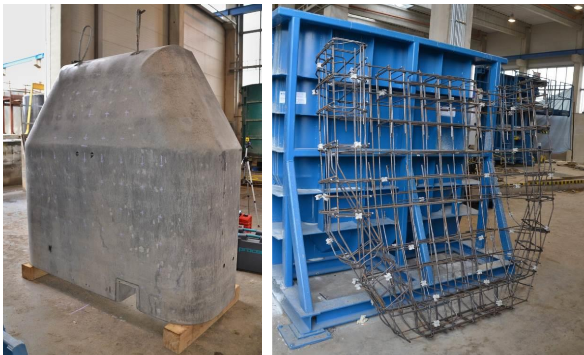
Obr. 52 Pohled na zkoušený prvek zezadu – v dolní části (při betonáži se jednalo o horní povrch) je patrný technologický otvor, na foto vpravo armokoš
