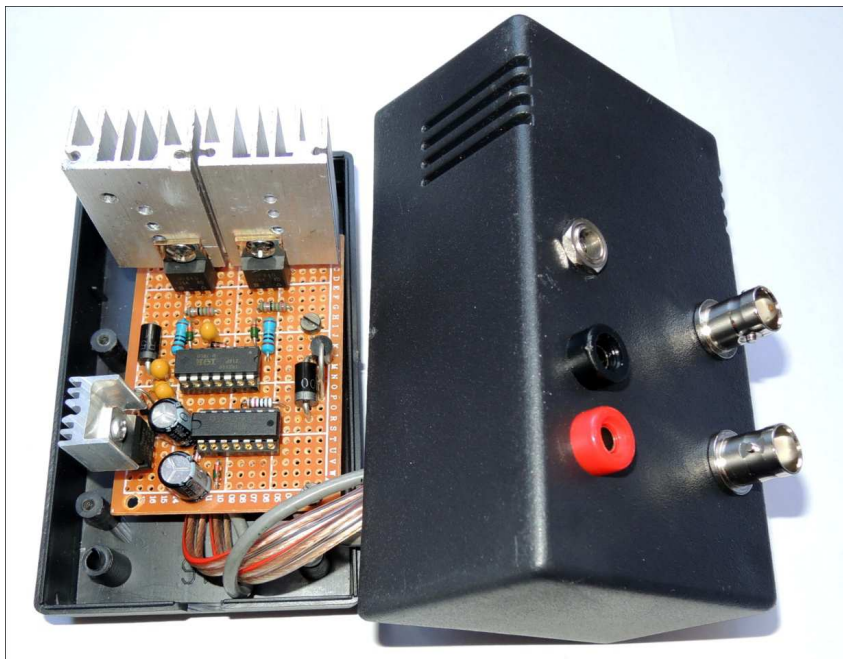
Obr. 4.13: Na fotografii asymetrického zesilovače je patrná jeho jednodušší konstrukce ve srovnání s H-mostem.
