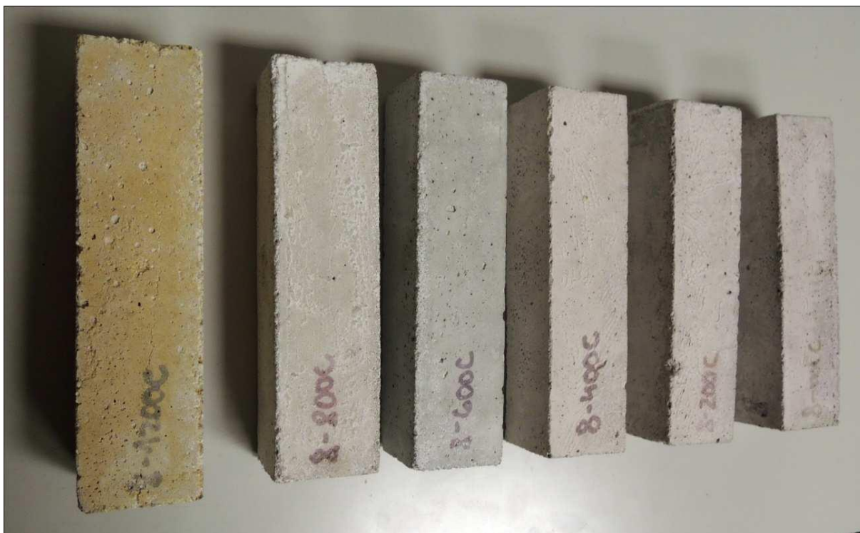
Obr. 5.3: Teplotně namáhané vzorky vyrobené z cementové malty.
