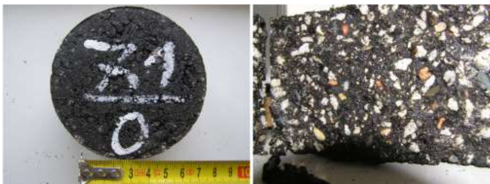
Obrázek 4 Směs ACO 8 CH, 50/70, obsah pojiva 7,1 % hmotnosti směsi (Marshallovo zkušební těleso a řez tělesem)
