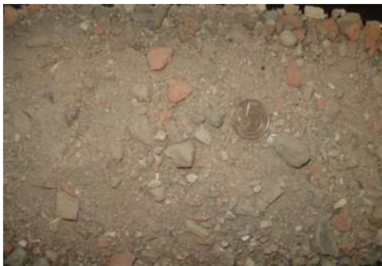
Obrázek 7 Směsný recyklát pro zkoušení do stmelených směsí ve frakci 0/16 mm
