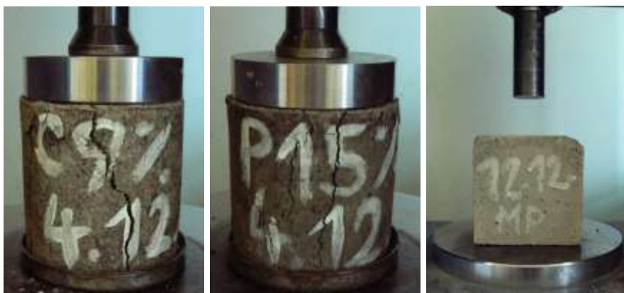
Obrázek 16 Porušená zkušební tělesa zkoušených směsí betonového recyklátu s hydraulickým pojivem
