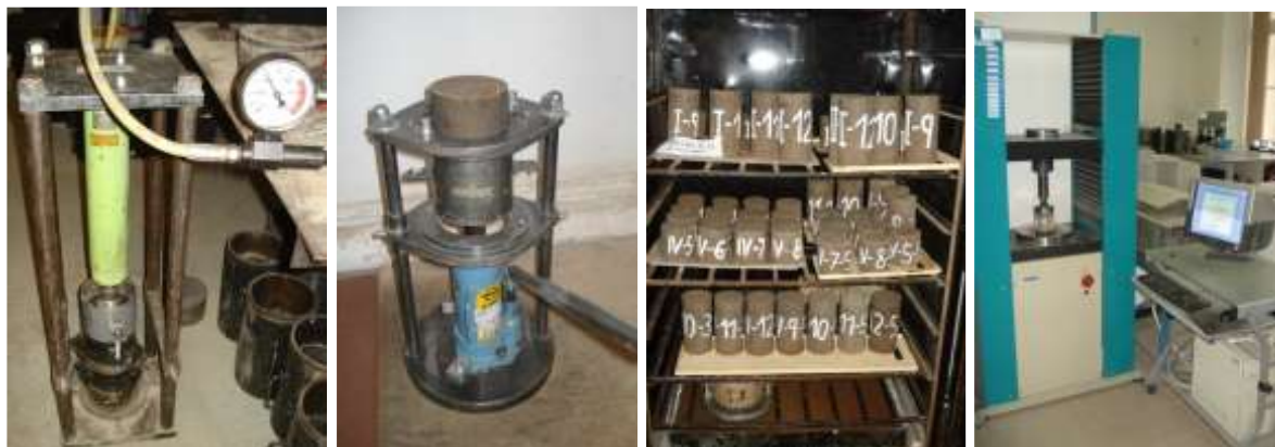
Obrázek 12 Postup přípravy zkušebních válcových těles před zkouškou pevnosti v tlaku
