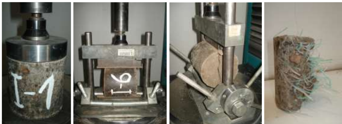
Obrázek 13 Zkoušení pevnosti v prostém tlaku a příčném tahu
