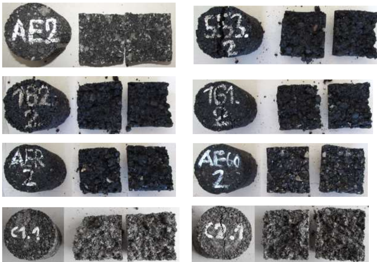
Obrázek 23 Zkušební tělesa navržených studených směsí po zkoušce pevnosti v příčném tahu ( R_{it} )
