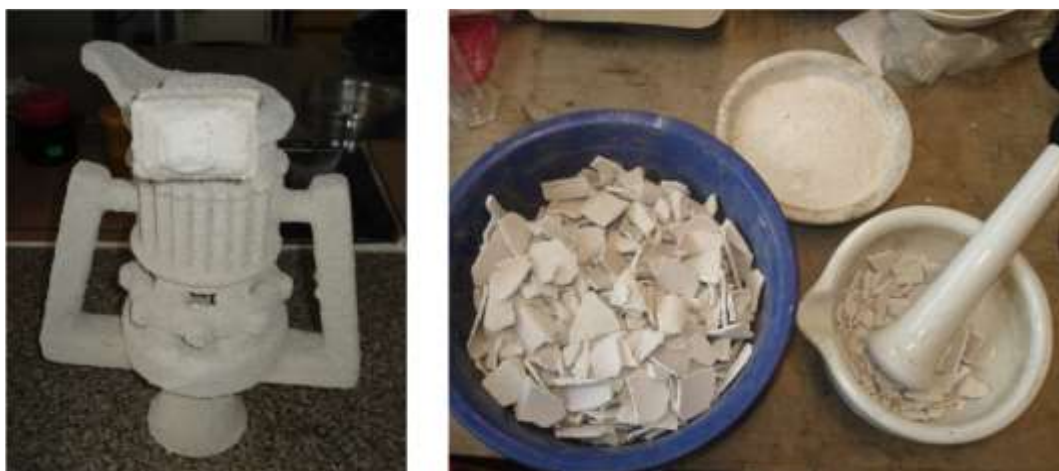
Obrázek 8 Slévárenská skořepina – příprava od odformování po drcení do práškové formy pojiva
