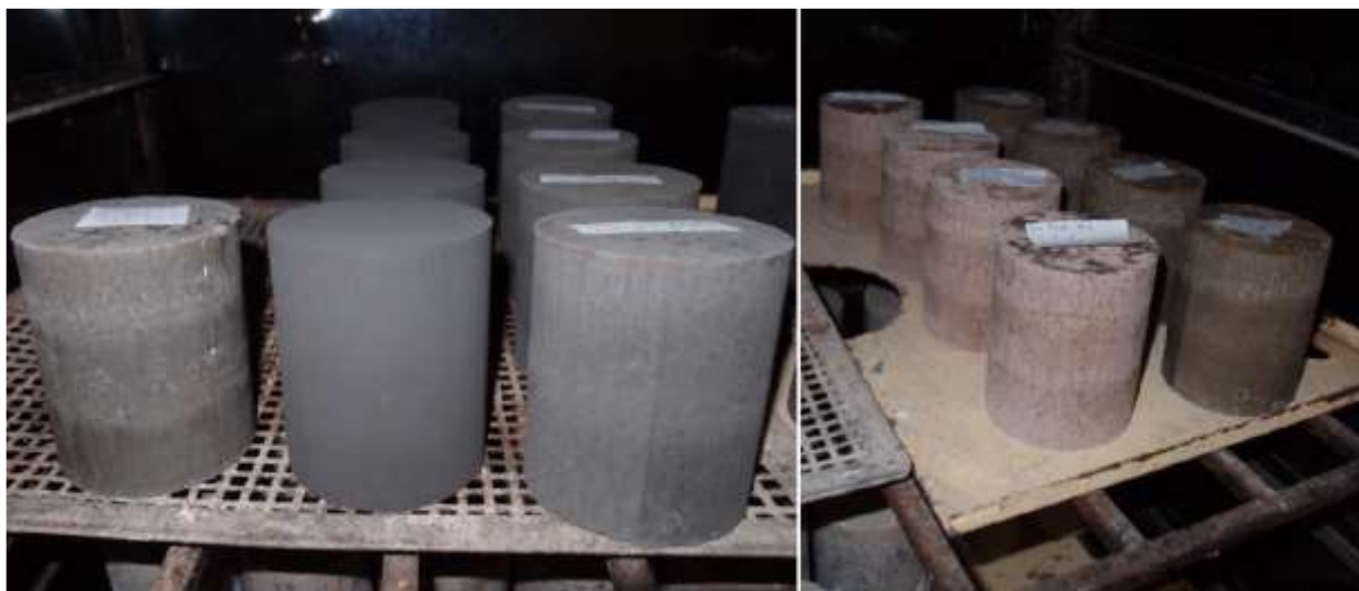
Obrázek 33 Zrání zkušebních válcových zkušebních těles na roštích v klimatizované komoře
