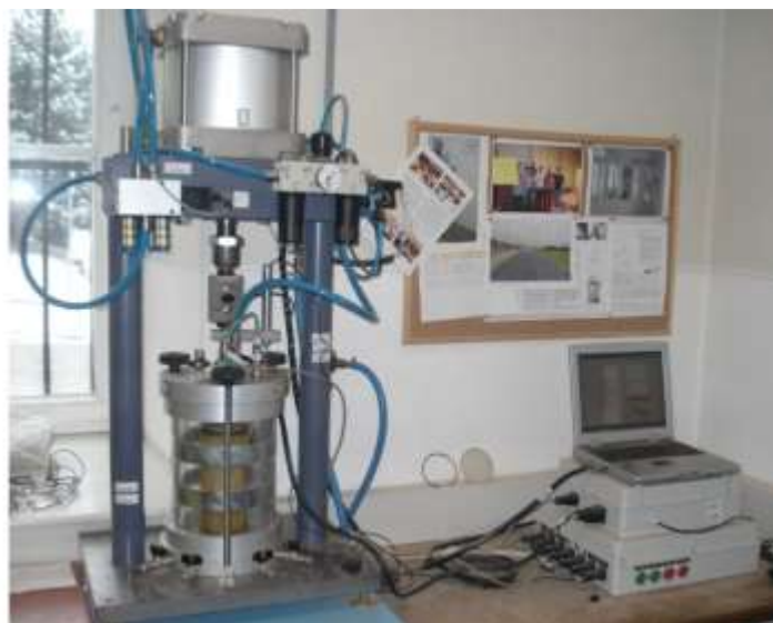
Obrázek 14 Cyklický triaxiální přístroj pro zkoušení zkušebních válcových těles průměru 100 mm, výšky 200 mm
