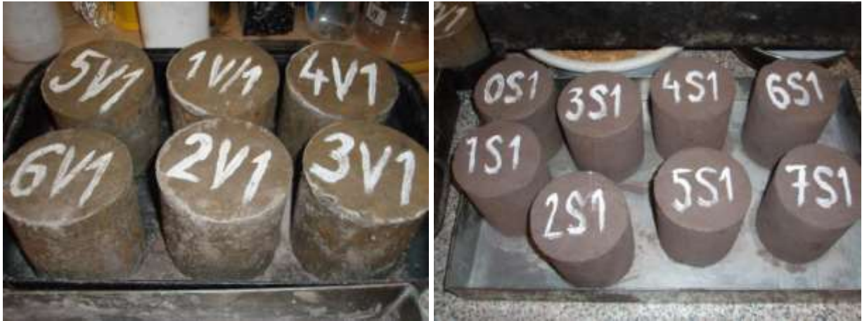
Obrázek 37 Zhutněná zkušební tělesa směsi V1 do stmelených podkladních vrstev
