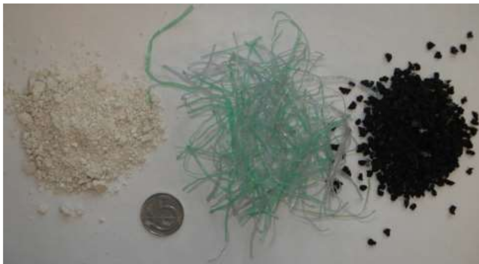
Obrázek 9 Ukázka použitých komponentů druhotných surovin do navrhovaných stmelených směsí slévárenská skořepina, PET vlákna, drcená odpadní pryž
