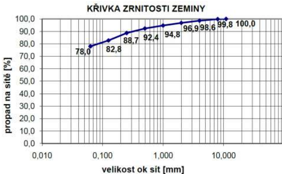
Obrázek 29 Křivka zrnitosti zkoušené upravované jemnozrné zeminy klasifikované F6 CI
