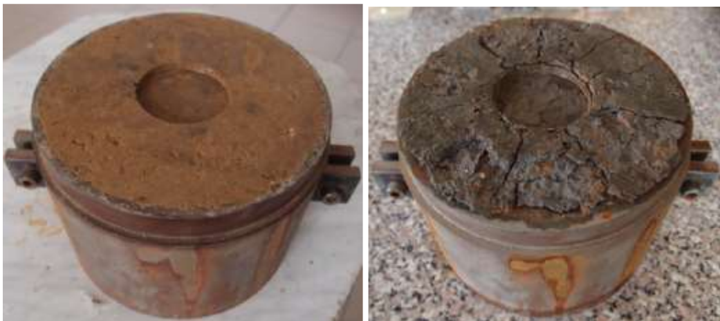
Obrázek 31 Zkušební vzorky F6 CI a F6 CI+25%EDE po zkoušce IBI
