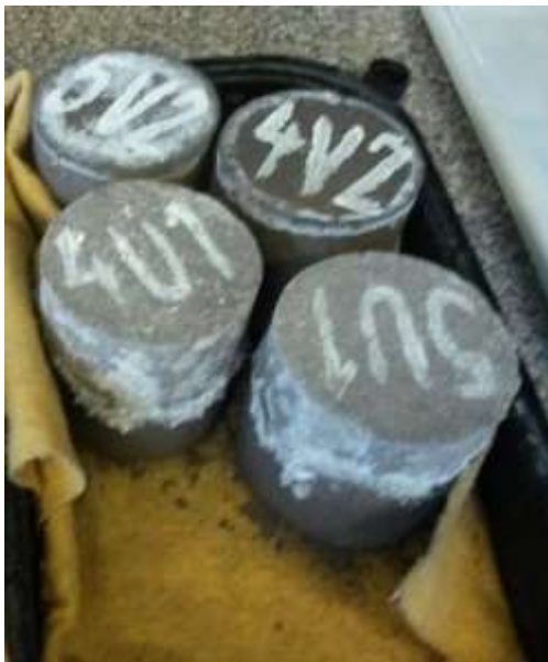
Obrázek 37 Zhutněná zkušební tělesa směsi V1 do stmelených podkladních vrstev
