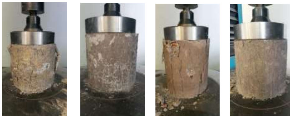
Obrázek 43 Porušená zkušební tělesa ze zkoušky pevnosti v prostém tlaku – V1; V2; S1; U1
