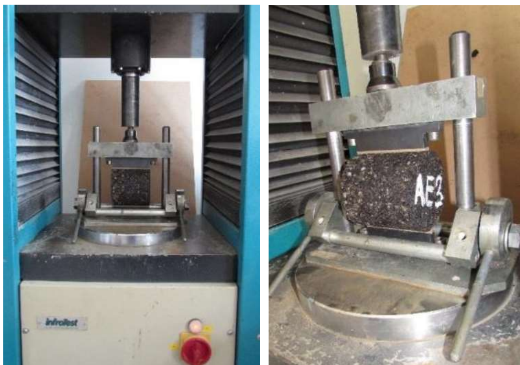
Obrázek 22 Zkouška pevnosti v příčném tahu na válcových zkušebních tělesech
