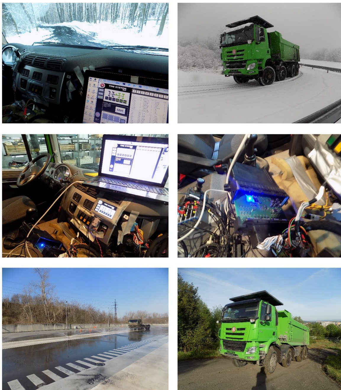
Obr. 65 Testování kompletního vyvinutého autonomního mechatronického systému pro uzavírání diferencíálů
