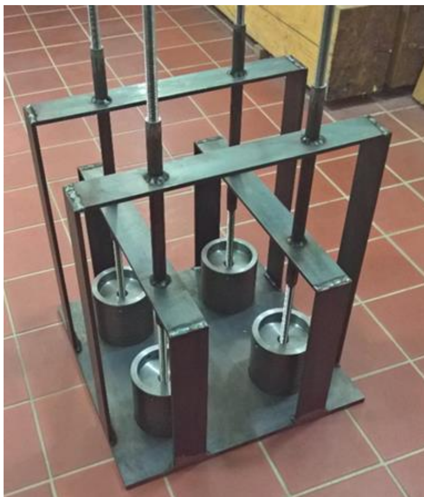
Obr. 4-12 Aretace čtyř kotevních šroubů pomocí osazovacího přípravku
