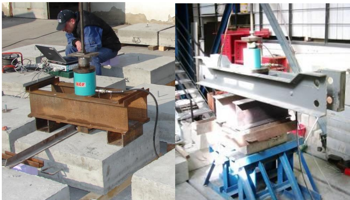
Obr. 4-18 Realizace neomezené tahové zkoušky
