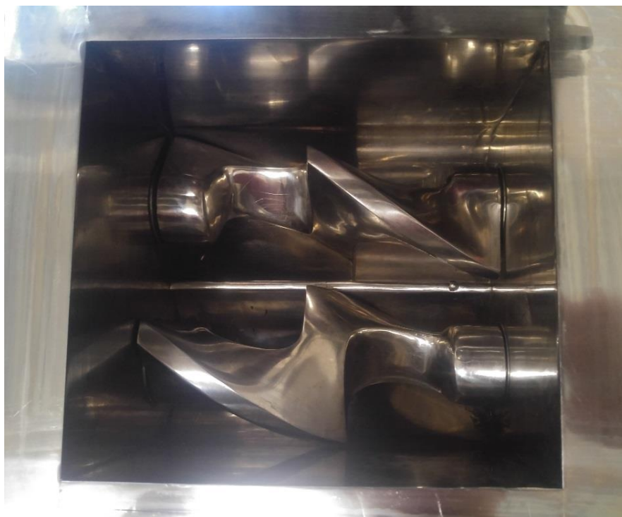
Obr. 4-29 Komora laboratorního hnětače s míchacími hřídelemi
