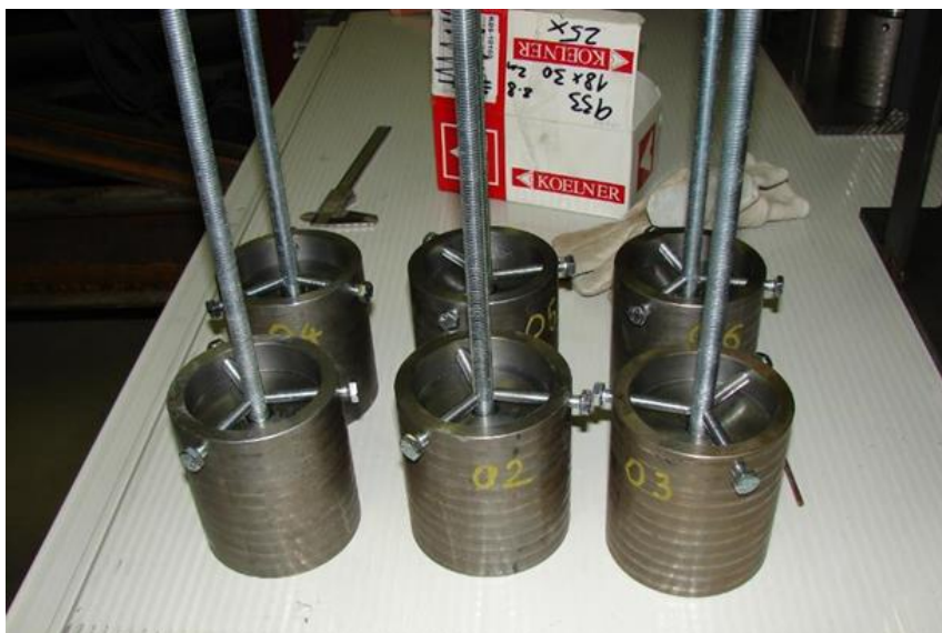
Obr. 4-11 Aretace šesti kotevních šroubů pomocí stavěcích šroubů
