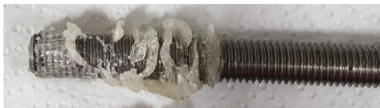
Obr. 4-69 Vzorek lepidla receptury 531-AN2609 po zkoušce po 15 hodinách v 5 °C
