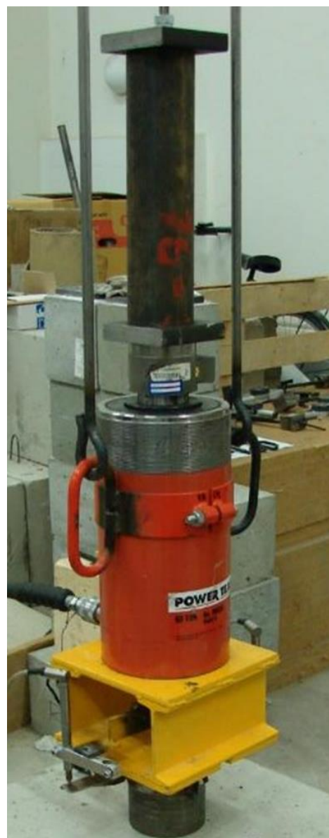
Obr. 4-6 Schéma zkušební sestavy pro použitou modifikovanou omezenou zkoušku
