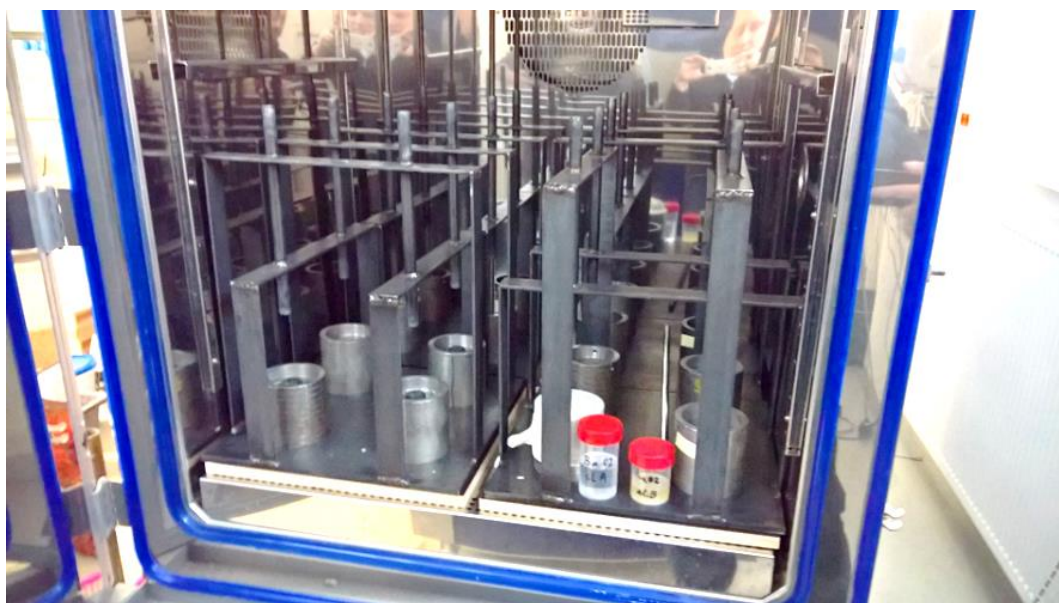
Obr. 4-62 Temperování zkušebních přípravků a složek lepidel v klimatizační komoře
