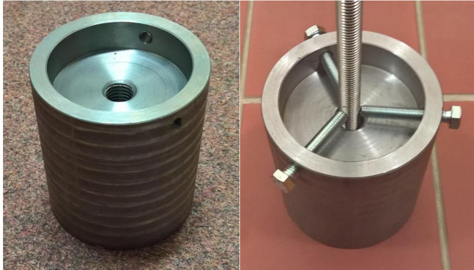
Obr. 4-9 Aretace kotevního šroubu v ocelovém zkušebním přípravku pomocí trojice šroubů
