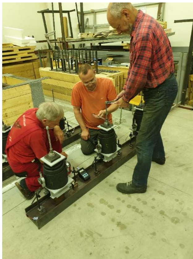
Obr. 4-79 Vnášení dlouhodobého zatížení do vzorku za pomoci evolutní pásové pružiny
