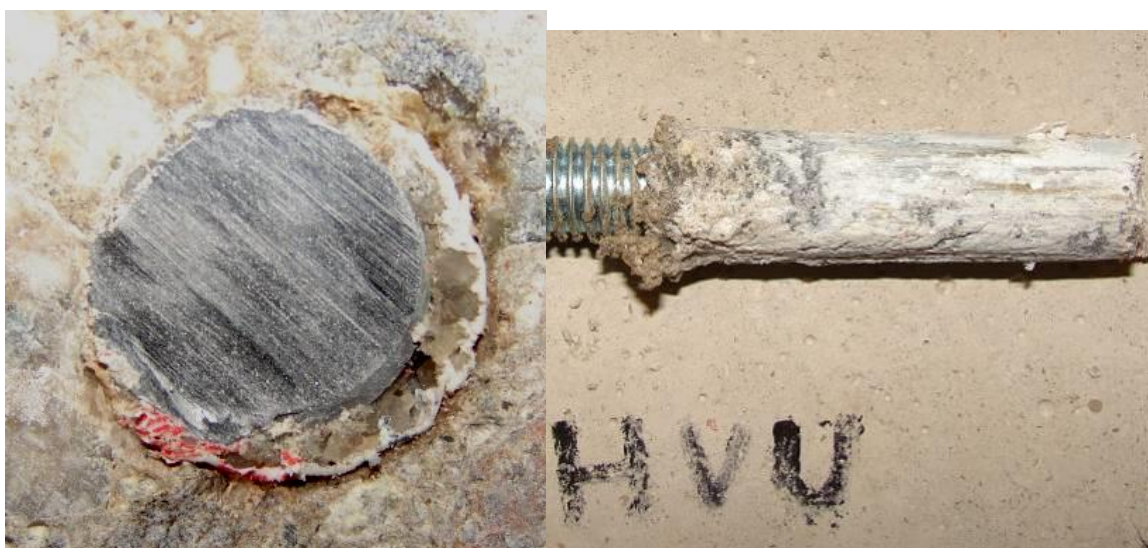
Obr. 4-25 Vzorek vinyl-uretanové pryskyřice před a po porušení při omezené zkoušce
