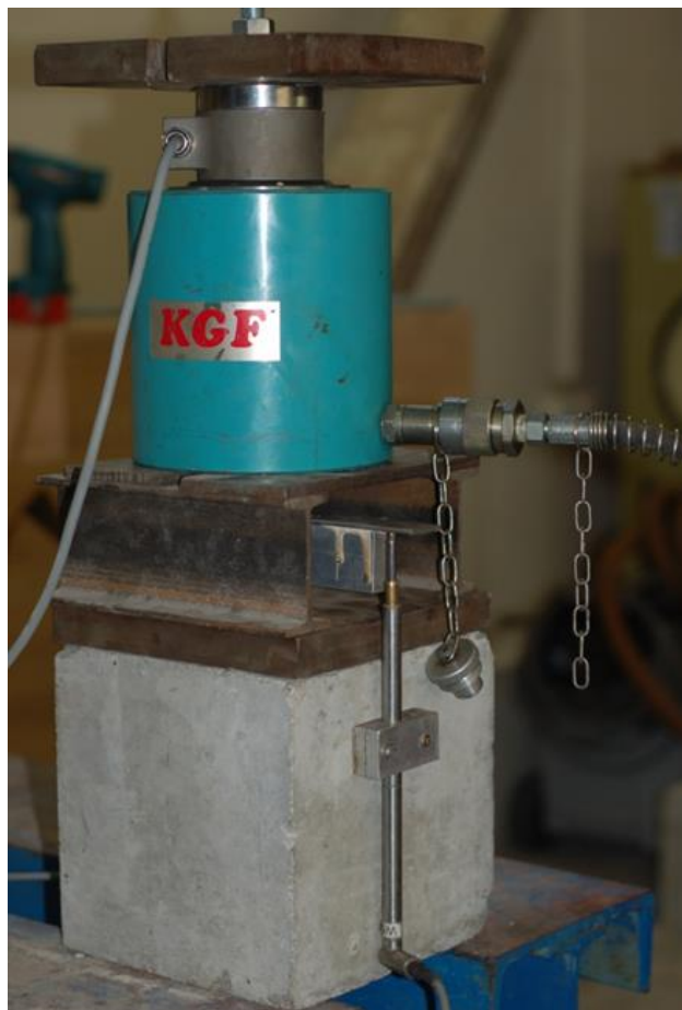
Obr. 4-22 Realizace omezené zkoušky v betonovém tělese
