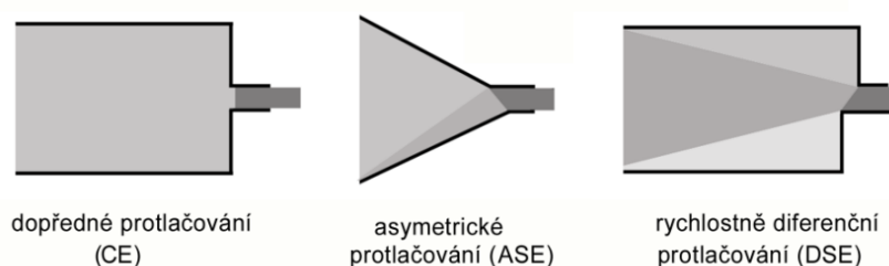
Obr. 13: Rozdělení zón rychlosti plastického toku při různých způsobech protlačování.
