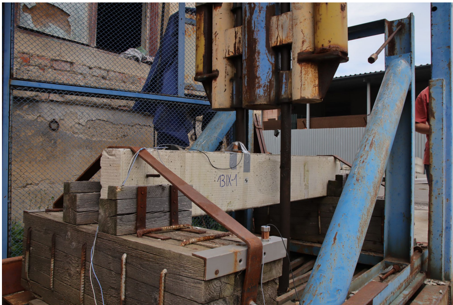
Obrázek 4.43: Fotografie experimentu - v našem měření nebyl nosník připevněn ke dřevěným podložkám
