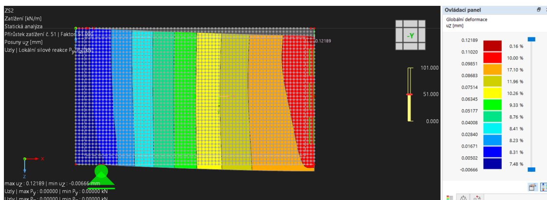
Obrázek 3.28: Posun u_z po 5 dnech pro \alpha = 0.5
