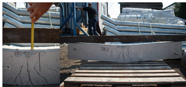
Obrázek 4.47: Měření průhybu nosník po dopadu v ustáleném stavu
