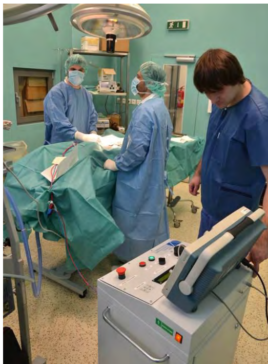
Vysokonapěťový zdroj pro elektroporaci rakovinových buněk
