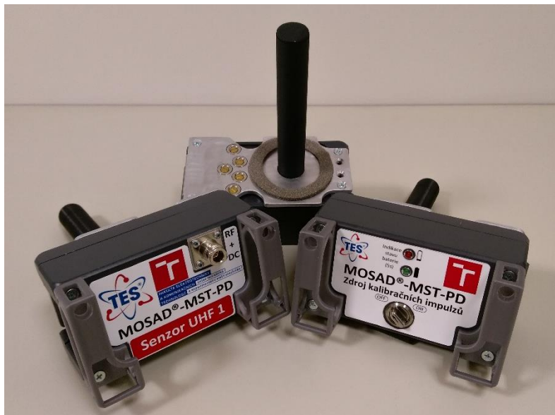
Snímač UHF signálu částečného výboje a zdroj kalibračních impulzů.
